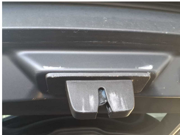
Gebrauchsspur 1: Verkleidungen/Abdeckungen: Heckdeckel, Innenverkleidung - verkratzt / verschürft - kein Abzug
