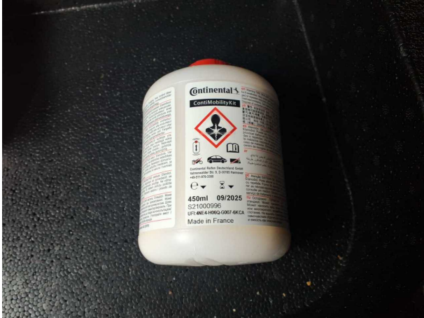
Beschädigung #1: Ausrüstung: Tirefit Füllmittel - abgelaufen - erneuern
