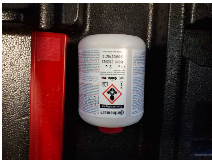
Beschädigung 1: Ausrüstung: Tirefit Füllmittel - abgelaufen - erneuern
