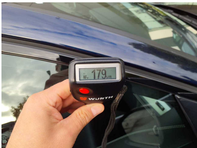
Dachholm rechts: 179 µm
