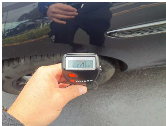
Kotflügel links: 220 µm
