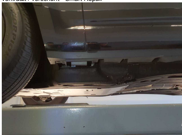
Beschädigung 2: Karosserie: Unterbodenverkleidung - beschädigt - erneuern
