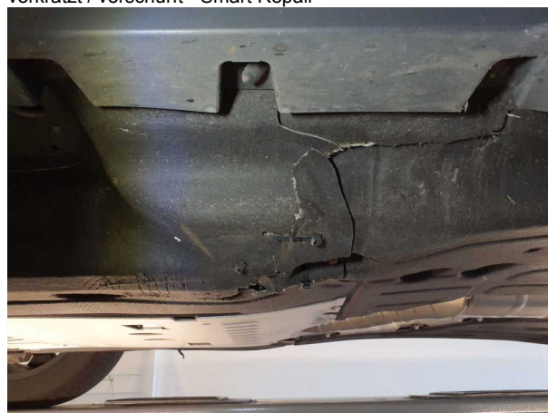
Beschädigung 2: Karosserie: Unterbodenverkleidung - beschädigt - erneuern
