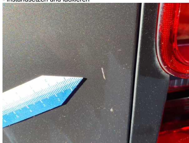
Beschädigung 11: Seitenwand links: Seitenwand (Verkleidung Rücklicht) - verkratzt / verschürft - instandsetzen und lackieren
