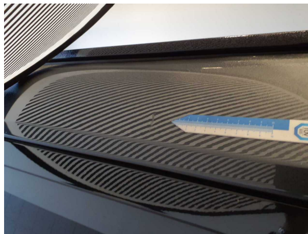
Beschädigung 6: Fahrzeugdach: Dachholm rechts - Delle / Lackschaden - instandsetzen und lackieren
