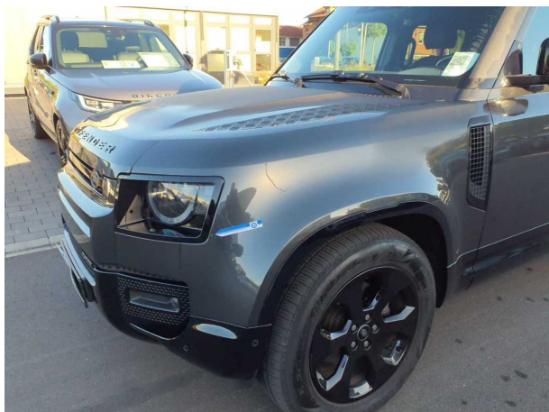
Beschädigung 8: Kotflügel links: Kotflügel links - Delle / Lackschaden - instandsetzen und lackieren
