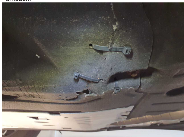
Beschädigung 2: Karosserie: Unterbodenverkleidung - beschädigt - erneuern
