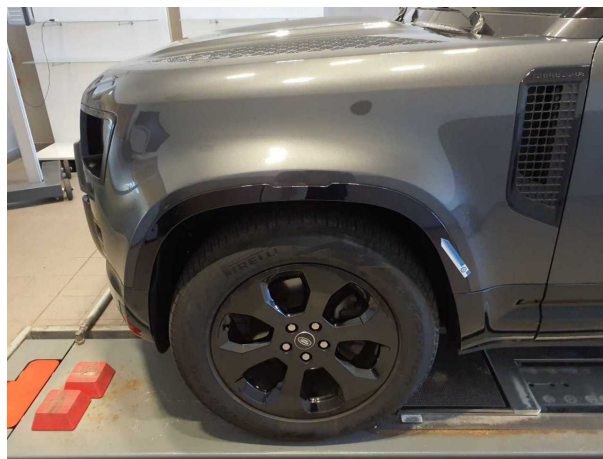
Gebrauchsspur 6: Kotflügel links: Radhausverbreiterung - Delle(n) - kein Abzug
