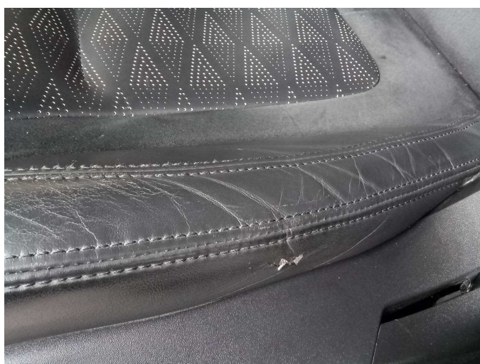
Beschädigung 1: Sitz vorn: Sitzbezug links - Kratzer - Smart Repair
