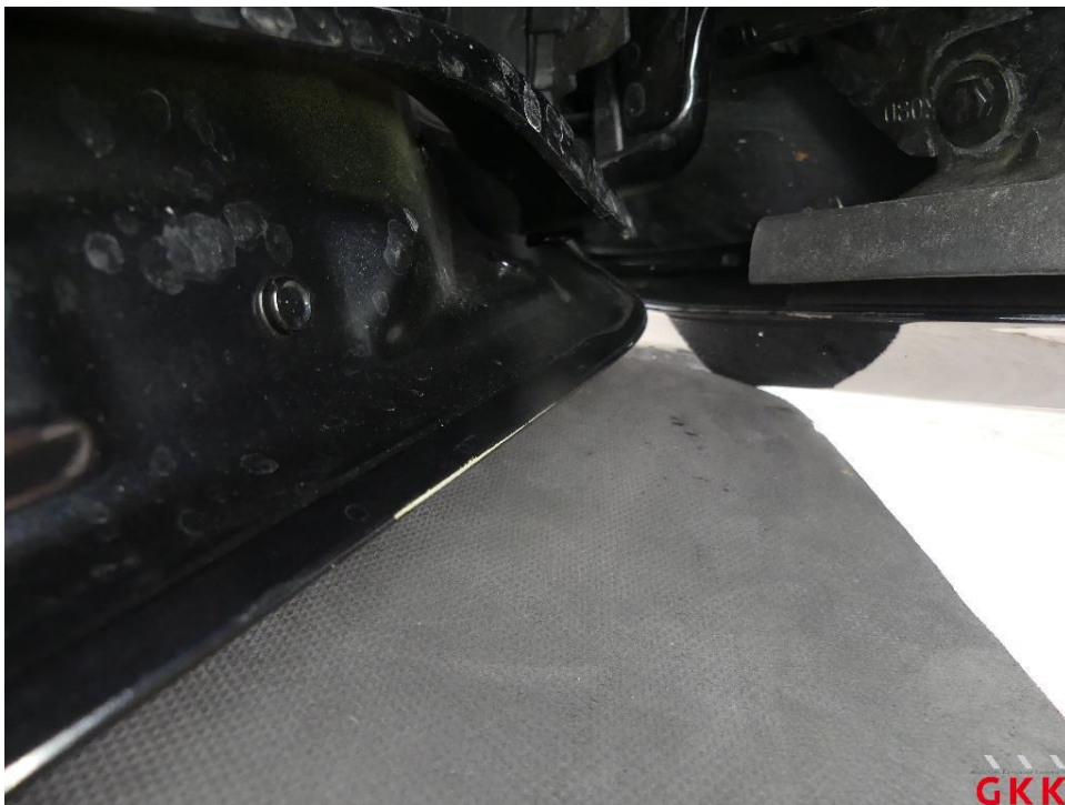
Bild 16 Motorhaube innen verkratzt
