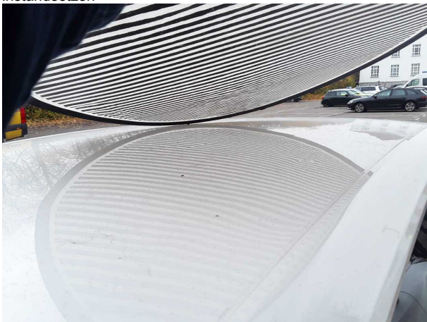
Beschädigung #11: Karosserie: Karosserie - Hagelschaden - instandsetzen
