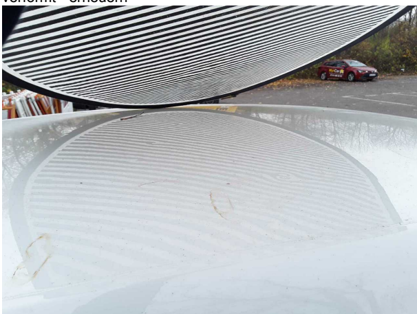
Beschädigung #10: Fahrzeugdach: Dach (+Hagelschaden) - verformt - erneuern
