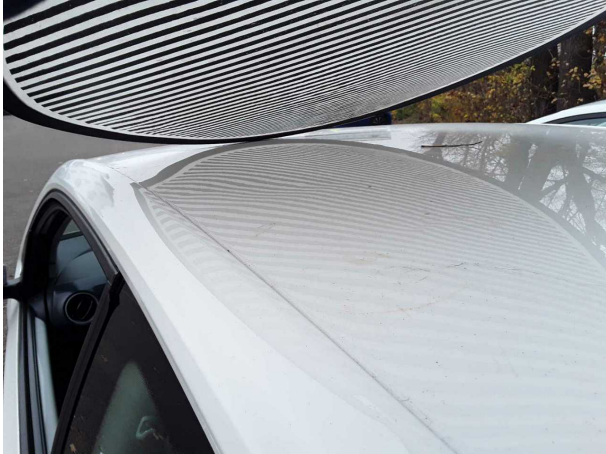
Beschädigung #10: Fahrzeugdach: Dach (+Hagelschaden) - verformt - erneuern
