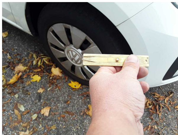
Beschädigung #6: Rad/Reifen: Reifen vorn - verschlissen - erneuern
