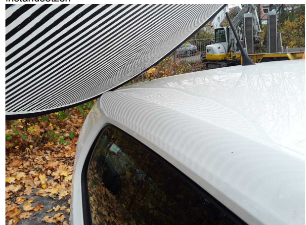
Beschädigung #11: Karosserie: Karosserie - Hagelschaden - instandsetzen
