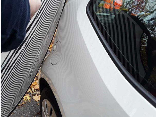
Beschädigung #11: Karosserie: Karosserie - Hagelschaden - instandsetzen
