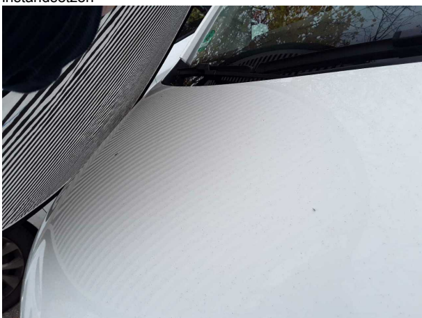
Beschädigung #11: Karosserie: Karosserie - Hagelschaden - instandsetzen
