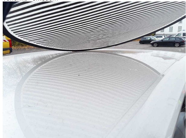
Beschädigung #10: Fahrzeugdach: Dach (+Hagelschaden) - verformt - erneuern
