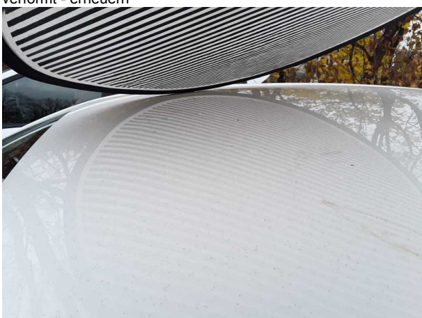
Beschädigung #10: Fahrzeugdach: Dach (+Hagelschaden) - verformt - erneuern
