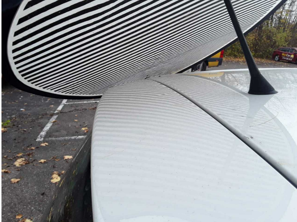
Beschädigung #11: Karosserie: Karosserie - Hagelschaden - instandsetzen
