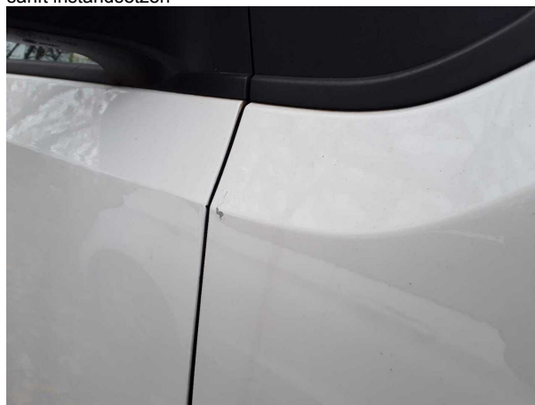
Beschädigung #13: Kotflügel rechts: Kotflügel rechts - verkratzt / verschürft - lackieren
