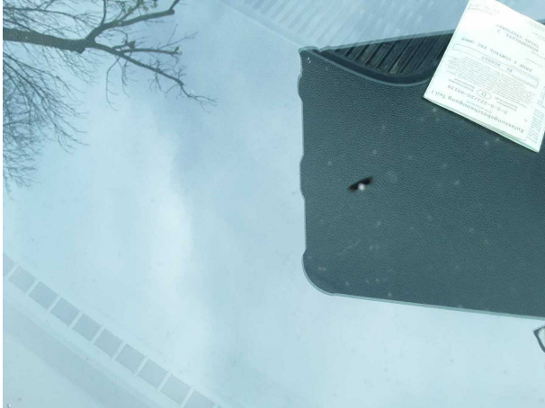
Beschädigung #14: Verglasung: Frontscheibe - Steinschlag - erneuern
