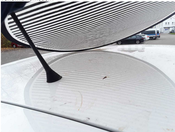
Beschädigung #10: Fahrzeugdach: Dach (+Hagelschaden) - verformt - erneuern
