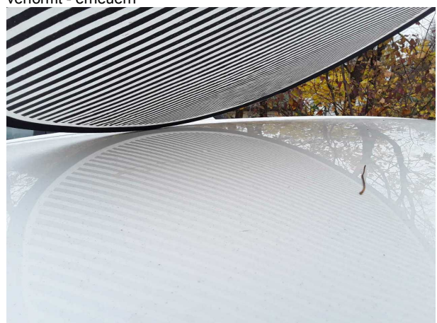
Beschädigung #10: Fahrzeugdach: Dach (+Hagelschaden) - verformt - erneuern
