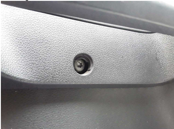
Beschädigung #16: Verkleidungen/Abdeckungen: Türverkleidung vorn links (Stopfen) - fehlt - erneuern
