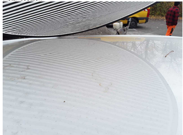
Beschädigung #11: Karosserie: Karosserie - Hagelschaden - instandsetzen
