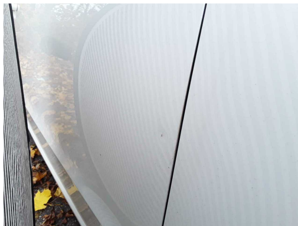
Beschädigung #12: Tür vorn rechts: Tür (+Abrieb) - Delle(n) - sanft instandsetzen
