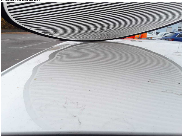
Beschädigung #11: Karosserie: Karosserie - Hagelschaden - instandsetzen
