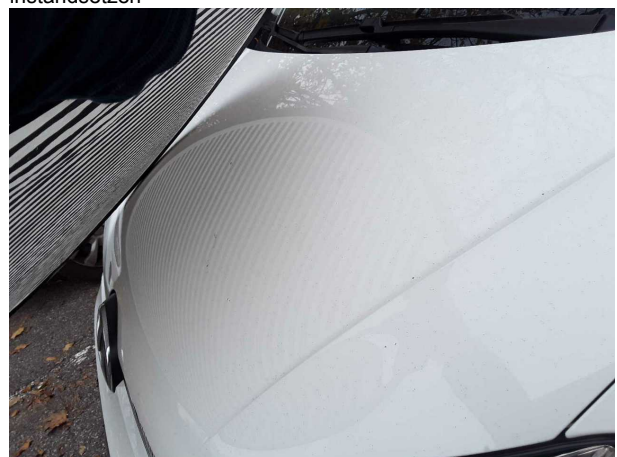
Beschädigung #11: Karosserie: Karosserie - Hagelschaden - instandsetzen
