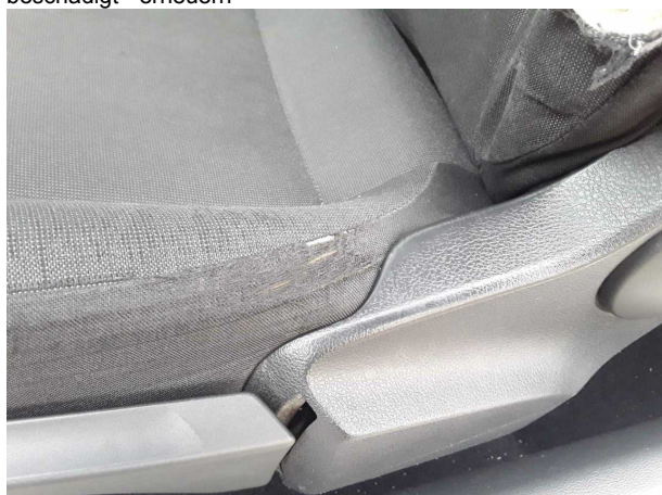
Beschädigung #4: Sitz vorn: Sitzbezug links - beschädigt - erneuern
