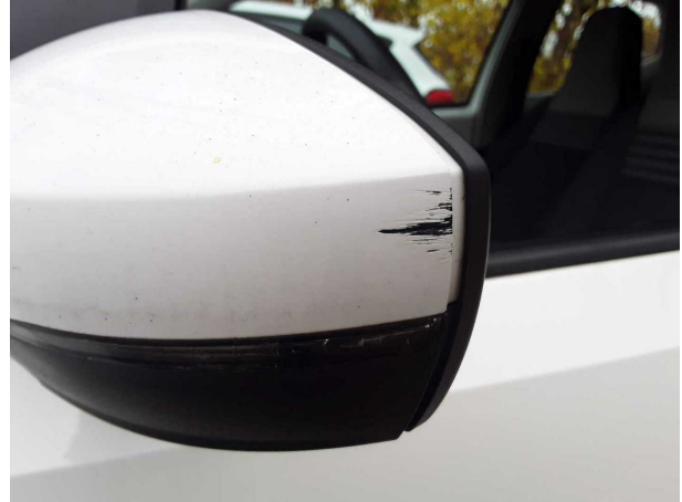
Beschädigung #9: Außenspiegel links: Abdeckkappe - verkratzt / verschürft - lackieren
