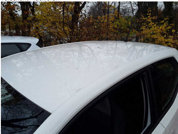
Beschädigung #10: Fahrzeugdach: Dach (+Hagelschaden) - verformt - erneuern
