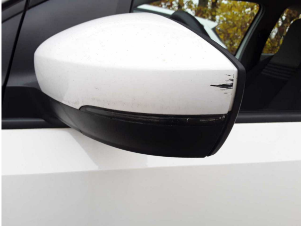
Beschädigung #9: Außenspiegel links: Abdeckkappe - verkratzt / verschürft - lackieren
