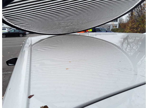
Beschädigung #10: Fahrzeugdach: Dach (+Hagelschaden) - verformt - erneuern
