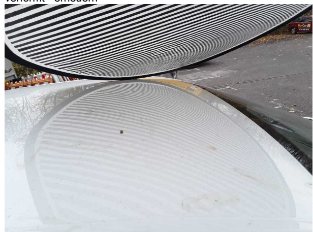
Beschädigung #10: Fahrzeugdach: Dach (+Hagelschaden) - verformt - erneuern
