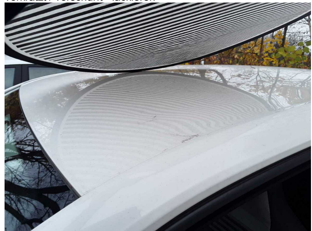
Beschädigung #10: Fahrzeugdach: Dach (+Hagelschaden) - verformt - erneuern
