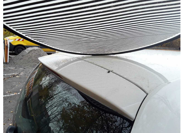
Beschädigung #11: Karosserie: Karosserie - Hagelschaden - instandsetzen
