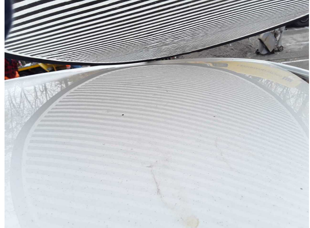
Beschädigung #11: Karosserie: Karosserie - Hagelschaden - instandsetzen
