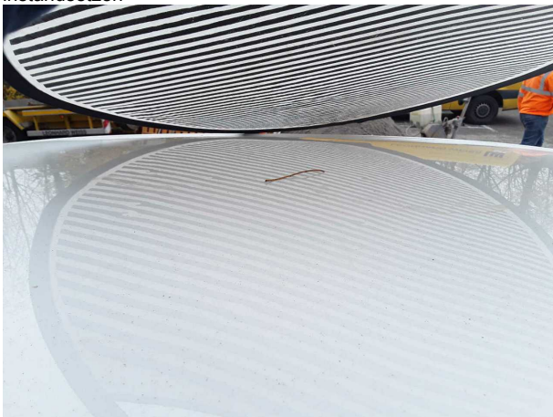
Beschädigung #11: Karosserie: Karosserie - Hagelschaden - instandsetzen
