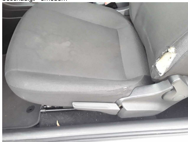
Beschädigung #4: Sitz vorn: Sitzbezug links - beschädigt - erneuern
