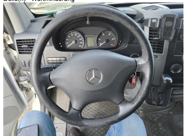
Beschädigung #11: Lenkanlage: Lenkrad - verschlissen - erneuern
