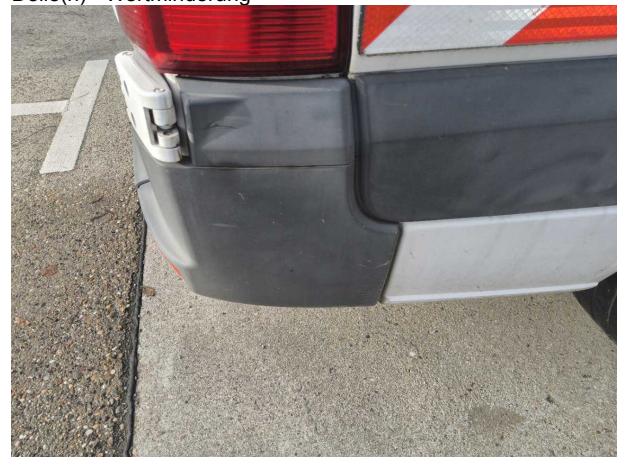
Beschädigung #9: Stossfänger hinten: Stossfänger hinten - Delle(n) - Wertminderung
