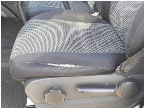
Beschädigung #1: Sitz vorn: Sitzbezug links - verschlissen - erneuern
