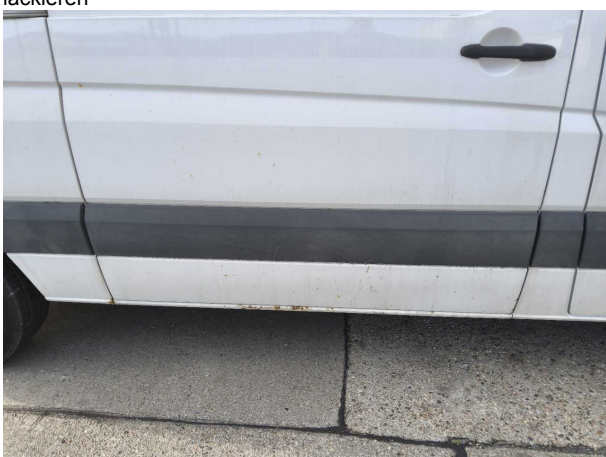
Beschädigung #7: Schiebetür rechts: Schiebetür - Korrosion - Wertminderung
