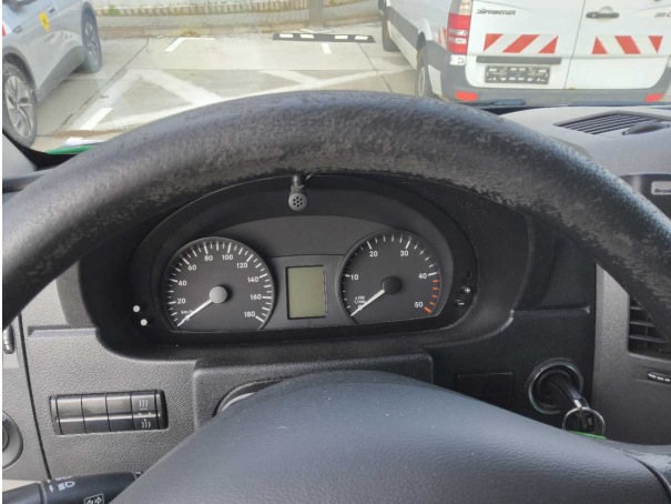
Beschädigung #11: Lenkanlage: Lenkrad - verschlissen - erneuern
