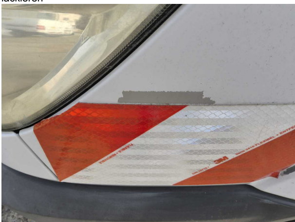
Beschädigung #2: Kotflügel links: Kotflügel links - Kratzer - lackieren
