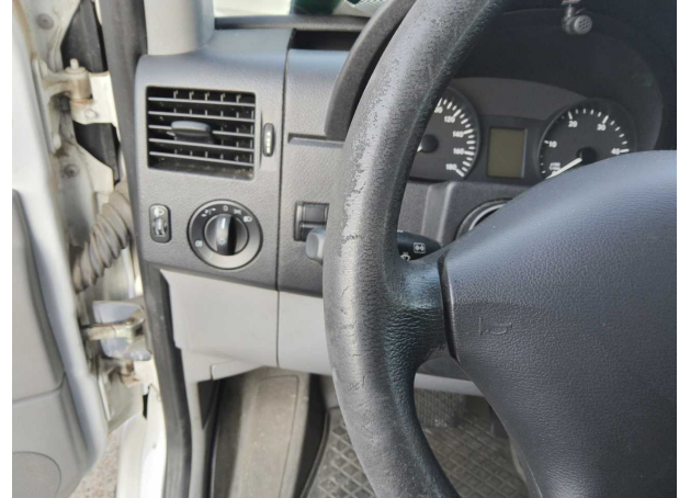
Beschädigung #11: Lenkanlage: Lenkrad - verschlissen - erneuern
