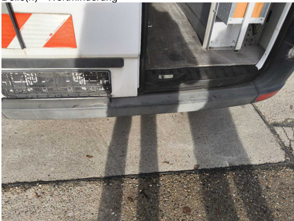
Beschädigung #9: Stossfänger hinten: Stossfänger hinten - Delle(n) - Wertminderung
