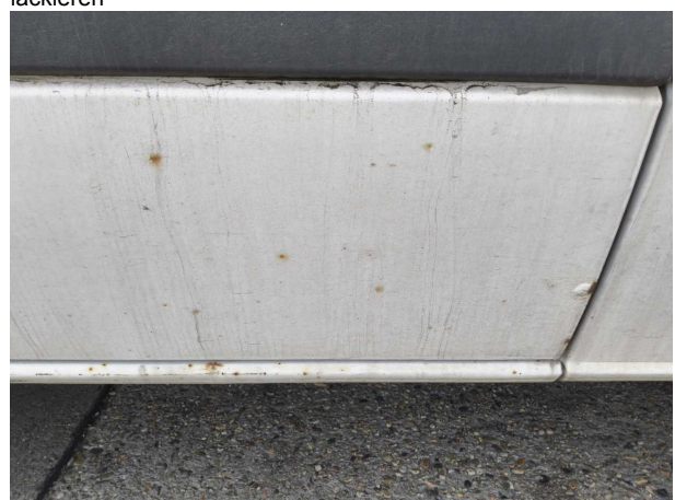
Beschädigung #7: Schiebetür rechts: Schiebetür - Korrosion - Wertminderung
