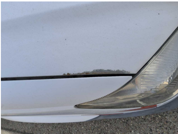
Beschädigung #3: Motorhaube: Motorhaube - Kratzer - lackieren
