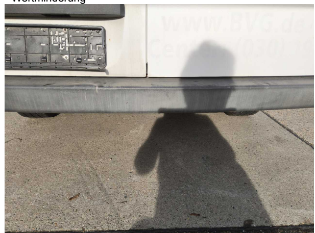
Beschädigung #9: Stossfänger hinten: Stossfänger hinten - Delle(n) - Wertminderung
