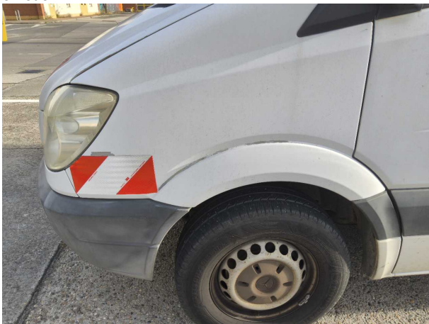
Beschädigung #2: Kotflügel links: Kotflügel links - Kratzer - lackieren
