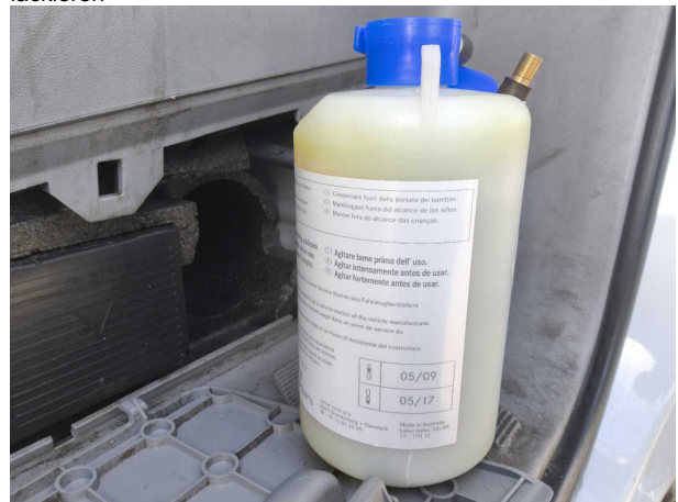
Beschädigung #4: Ausrüstung: Tirefit Füllmittel - abgelaufen - erneuern
