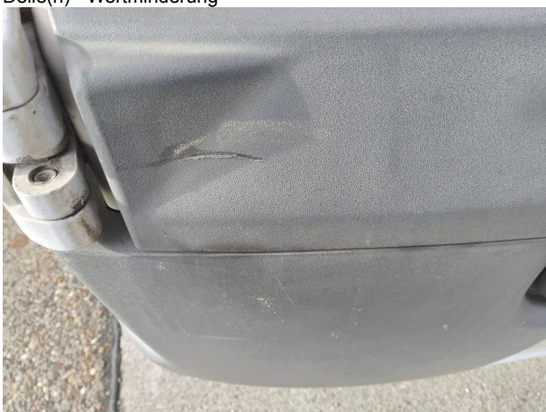
Beschädigung #9: Stossfänger hinten: Stossfänger hinten - Delle(n) - Wertminderung
