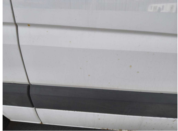
Beschädigung #7: Schiebetür rechts: Schiebetür - Korrosion - Wertminderung
