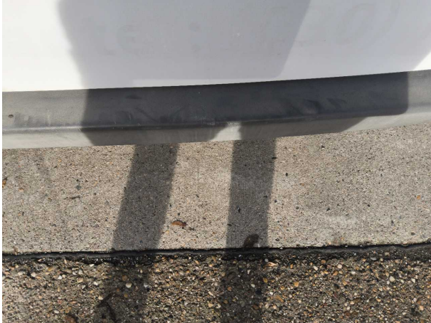
Beschädigung #9: Stossfänger hinten: Stossfänger hinten - Delle(n) - Wertminderung
