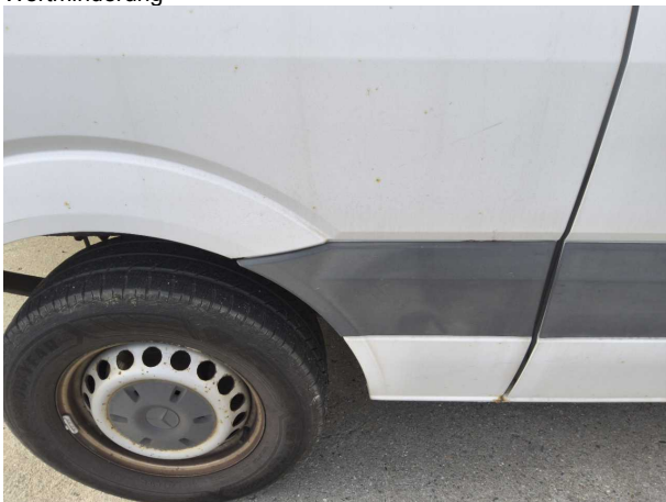
Beschädigung #8: Seitenwand rechts: Seitenwand - Korrosion - Wertminderung
