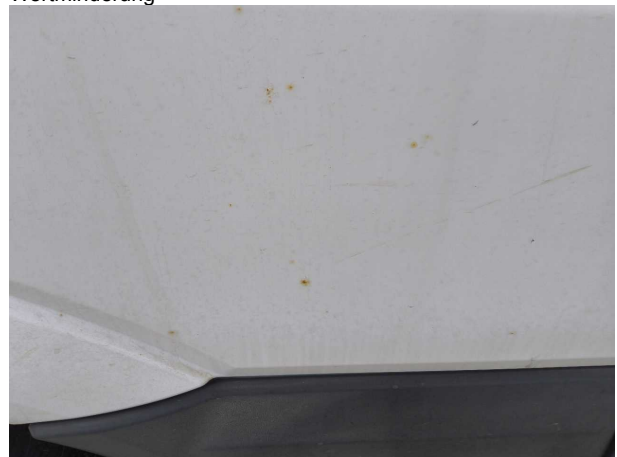
Beschädigung #8: Seitenwand rechts: Seitenwand - Korrosion - Wertminderung
