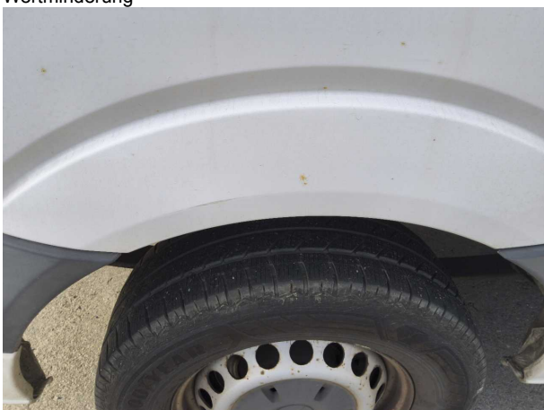
Beschädigung #8: Seitenwand rechts: Seitenwand - Korrosion - Wertminderung
