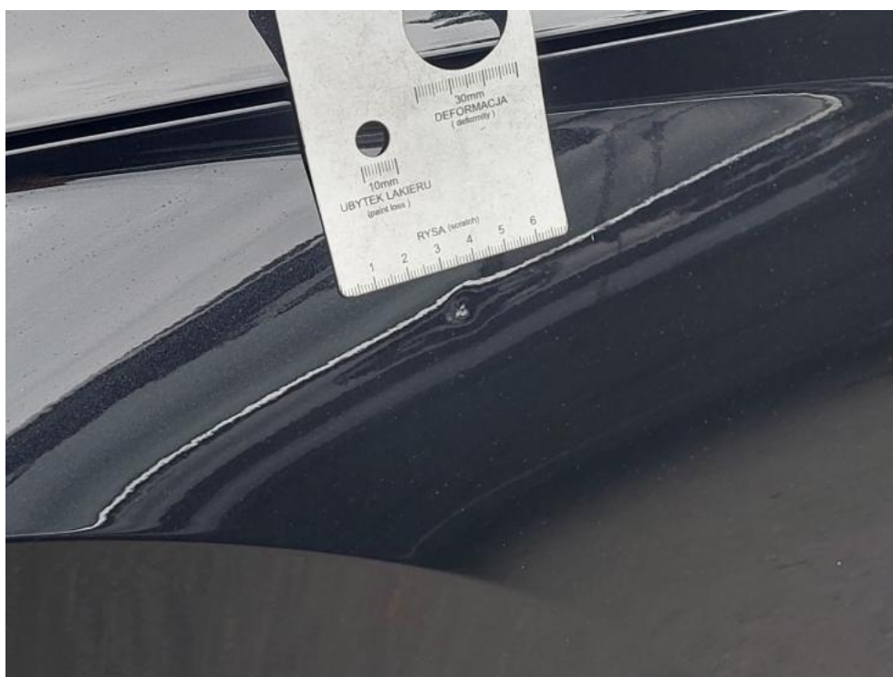
Fot. 58. Błotnik przedni L - Wgniecenie/odkształcenie 1
