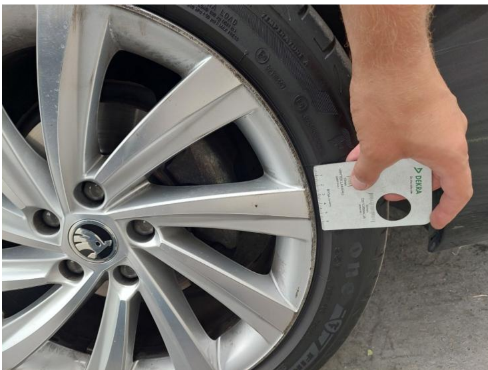
Fot. 42. Felga aluminiowa przednia P - Rysa/odprysk 1
