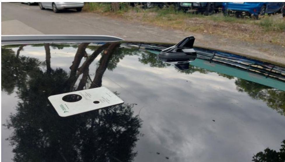
Fot. 51. Dach - Rysa/odprysk 2
