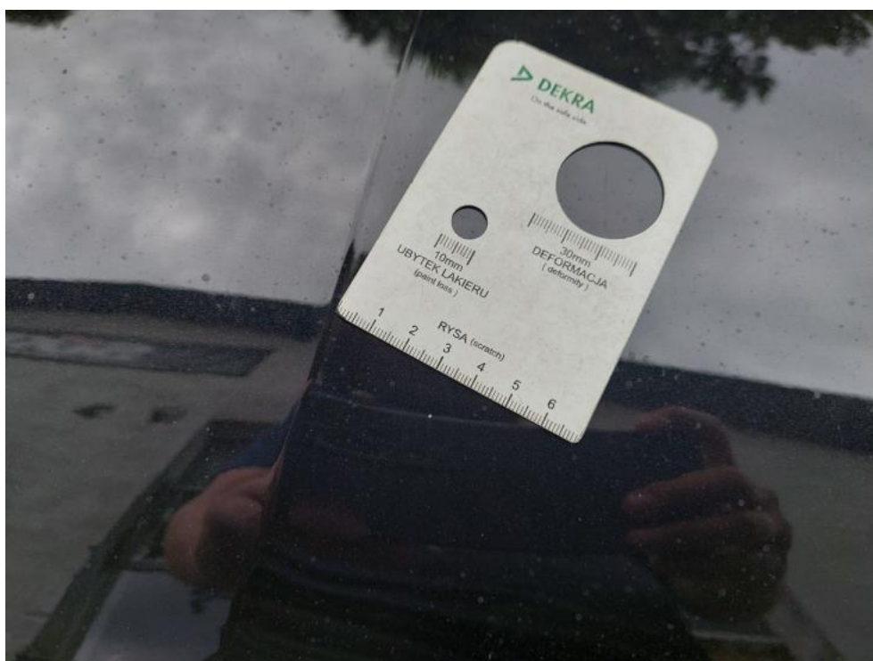
Fot. 38. Pokrywa komory silnika - Rysa/odprysk 2
