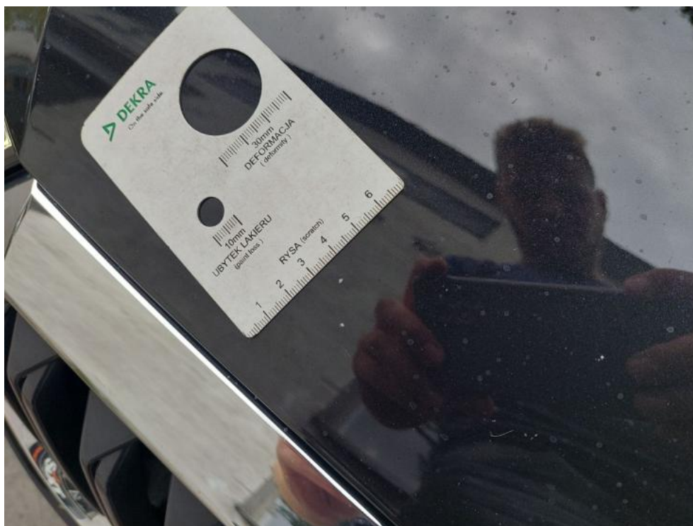
Fot. 37. Pokrywa komory silnika - Rysa/odprysk 1
