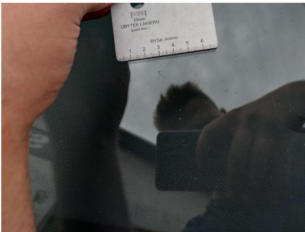
Fot. 41. Szyba czołowa - Rysa/odprysk 1
