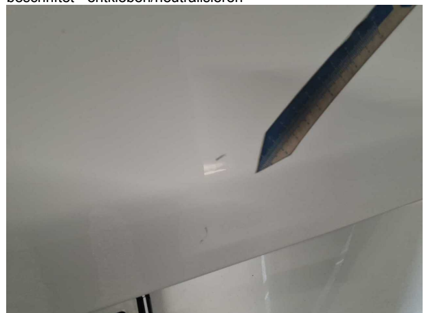
Beschädigung #11: Heckklappe/-tür: Heckklappe - Kratzer - Smart Repair
