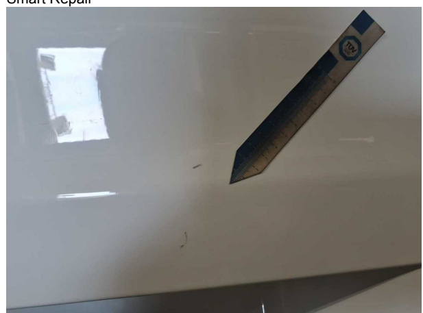
Beschädigung #11: Heckklappe/-tür: Heckklappe - Kratzer - Smart Repair
