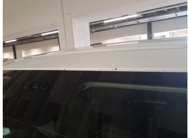
Beschädigung #6: Fahrzeugdach: Dach (Dachkante vorne) - Korrosion - Smart Repair
