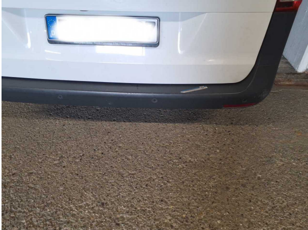
Beschädigung #12: Stossfänger hinten: Stossfänger hinten - verkratzt / verschürft - erneuern
