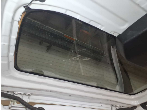
Beschädigung #10: Verglasung: Heckscheibe - beklebt/ beschriftet... - entkleben/neutralisieren
