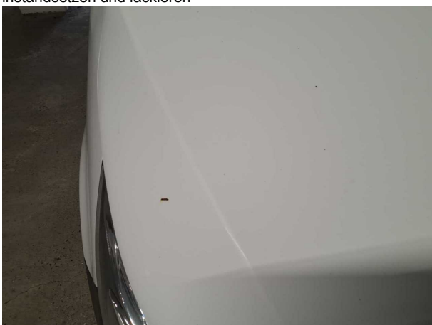
Beschädigung #5: Motorhaube: Motorhaube - Steinschlag - instandsetzen und lackieren
