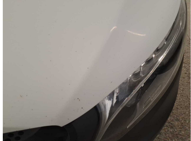
Beschädigung #5: Motorhaube: Motorhaube - Steinschlag - instandsetzen und lackieren
