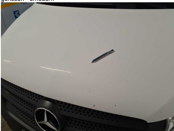
Beschädigung #5: Motorhaube: Motorhaube - Steinschlag - instandsetzen und lackieren
