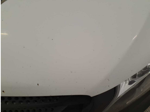
Beschädigung #5: Motorhaube: Motorhaube - Steinschlag - instandsetzen und lackieren
