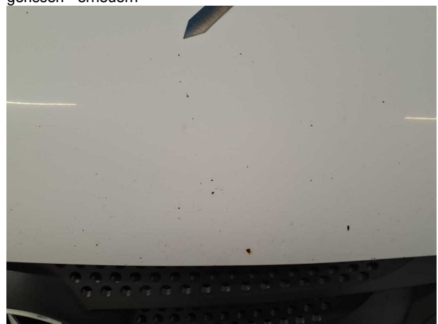
Beschädigung #5: Motorhaube: Motorhaube - Steinschlag - instandsetzen und lackieren
