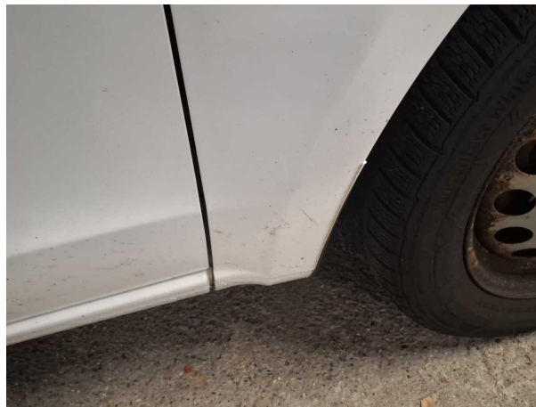
Beschädigung #14: Karosserie: Karosserie (Und Flugrost) - Lackmangel - auslegen / polieren
