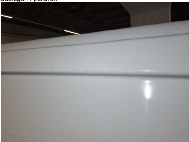
Beschädigung #9: Seitenwand links: Seitenwand - Kratzer - auslegen / polieren
