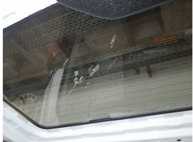
Beschädigung #10: Verglasung: Heckscheibe - beklebt/ beschriftet - entkleben/neutralisieren
