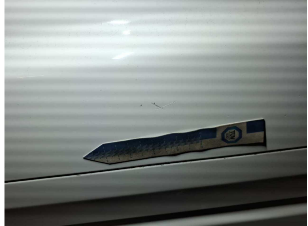
Beschädigung #13: Seitenwand rechts: Seitenwand - Kratze... Smart Repair
