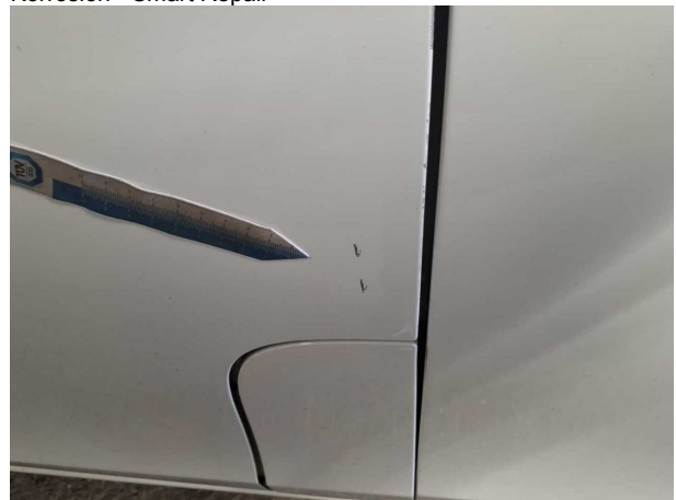
Beschädigung #7: Tür vorn links: Tür - Kratzer - instandsetzen und lackieren
