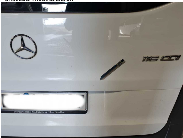
Beschädigung #11: Heckklappe/-tür: Heckklappe - Kratzer - Smart Repair
