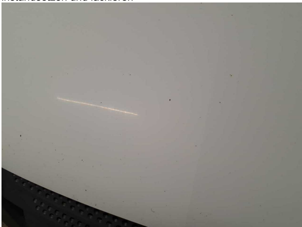
Beschädigung #5: Motorhaube: Motorhaube - Steinschlag - instandsetzen und lackieren
