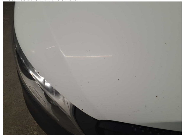
Beschädigung #5: Motorhaube: Motorhaube - Steinschlag - instandsetzen und lackieren
