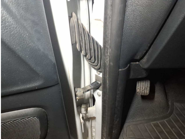
Beschädigung #8: Tür vorn links: Fangband / Feststeller - Geräusch - instandsetzen
