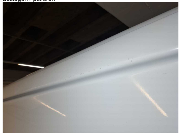
Beschädigung #9: Seitenwand links: Seitenwand - Kratzer - auslegen / polieren
