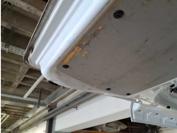
Beschädigung #3: Verkleidungen/Abdeckungen: Heckdeckel, Innenverkleidung - beschädigt - erneuern
