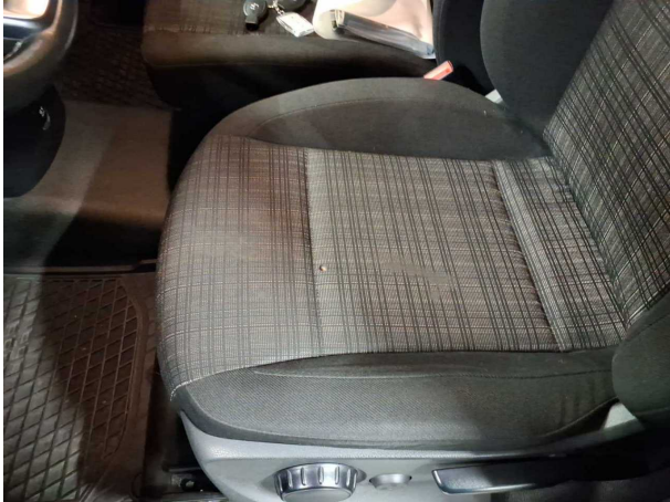
Beschädigung #1: Sitz vorn: Sitzbezug links - Brandloch - Smart Repair
