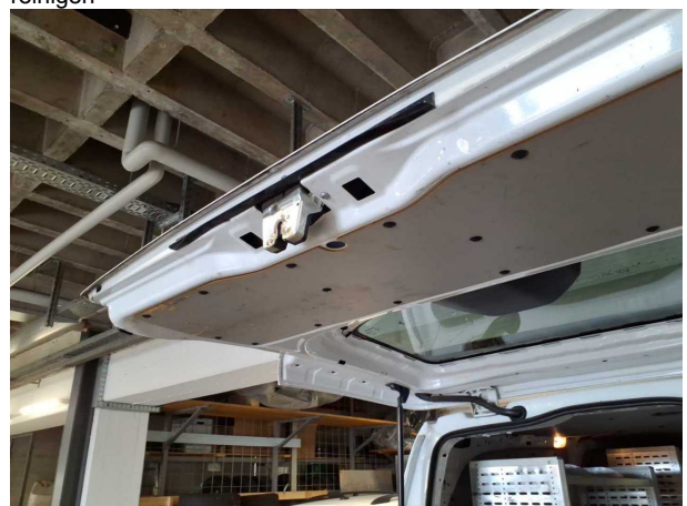
Beschädigung #3: Verkleidungen/Abdeckungen: Heckdeckel, Innenverkleidung - beschädigt - erneuern
