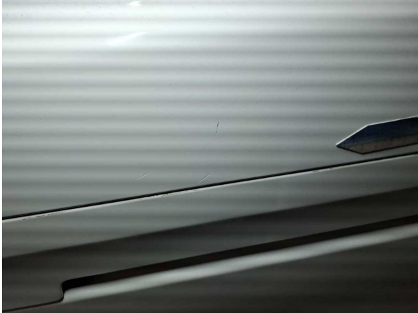
Beschädigung #13: Seitenwand rechts: Seitenwand - Kratzer - Smart Repair
