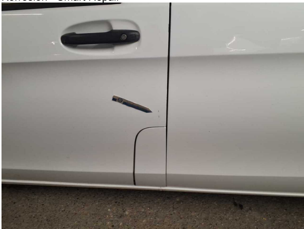
Beschädigung #7: Tür vorn links: Tür - Kratzer - instandsetzen u... lackieren
