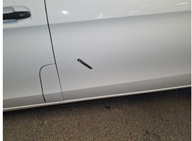
Beschädigung #9: Seitenwand links: Seitenwand - Kratzer - auslegen / polieren
