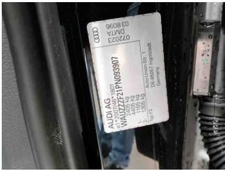
Fahrzeug - Typenschild/Fahrgestellnummer
