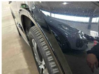
6 - Stoßfängerzierblende vorne rechts - Kratzer - Instandsetzen + lackieren
