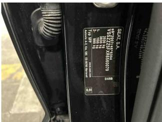
Fahrzeug - Typenschild/Fahrgestellnummer
