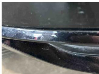
7 - Türzierleiste vorne rechts - Kratzer - Instandsetzen + lackieren
