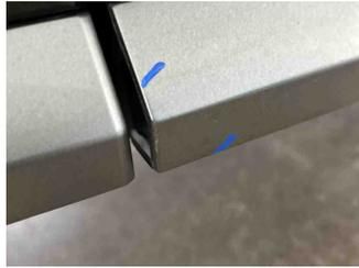
8 - Motorhaube - Steinschlag - Auslegen + Polieren
