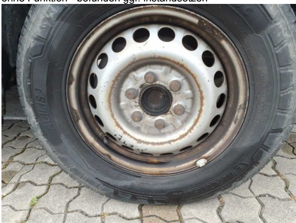
Beschädigung #11: Rad/Reifen: Radblende vorn rechts - fehlt - erneuern
