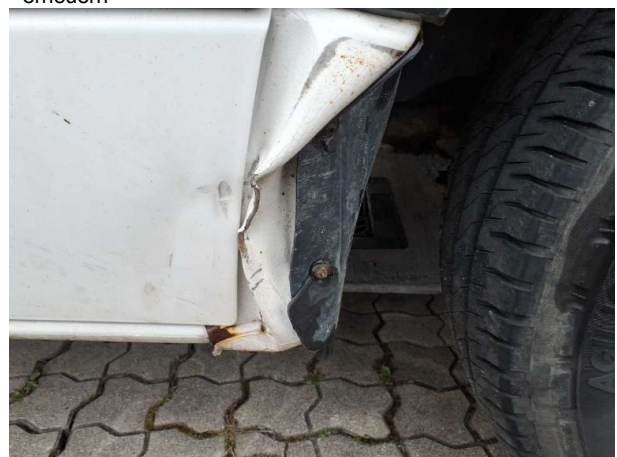
Beschädigung #16: Kotflügel rechts: Kotflügel rechts - verfor... - erneuern
