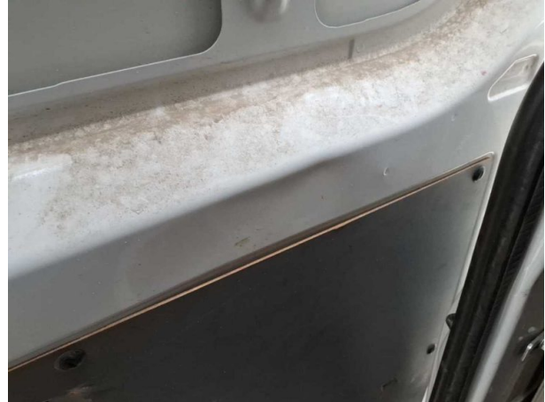
Beschädigung #27: Schiebetür rechts: Schiebetür - Korrosio... erneuern
