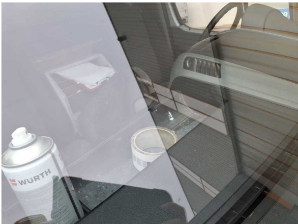
Beschädigung #44: Verglasung: Frontscheibe - Steinschlag
