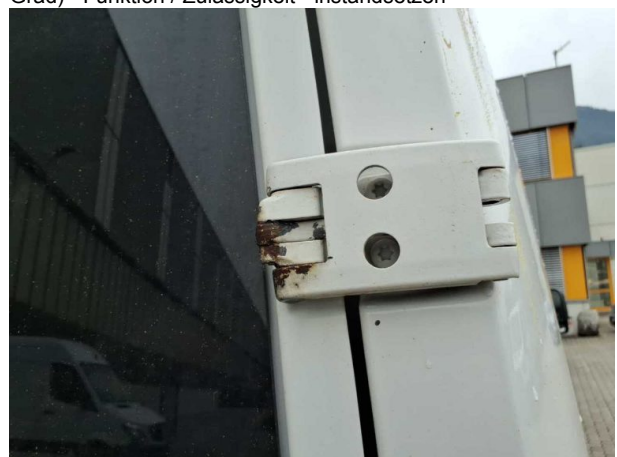
Beschädigung #45: Heckklappe/-tür: Scharnier unten (270 Grad) - Funktion / Zulässigkeit - instandsetzen
