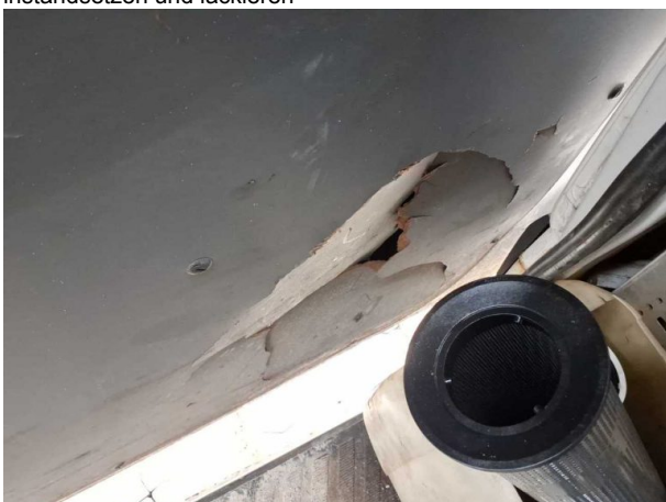
Beschädigung #26: Schiebetür rechts: Verkleidung Standard unt... - gebrochen / gerissen - erneuern
