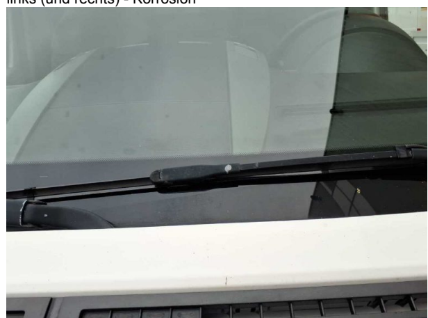
Beschädigung #19: Scheibenreinigung: Scheibenwischerarm links (und rechts) - Korrosion
