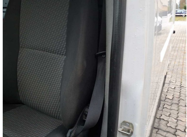
Beschädigung #40: Gurtsystem vorn: Sicherheitsgurt vorn links - Funktion / Zulässigkeit - erneuern
