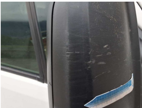
Beschädigung #18: Außenspiegel rechts: Abdeckkappe - Kratzer
