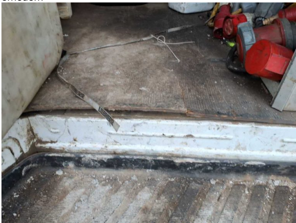
Beschädigung #28: Interieur: Laderaumboden - verformt - erneuern
