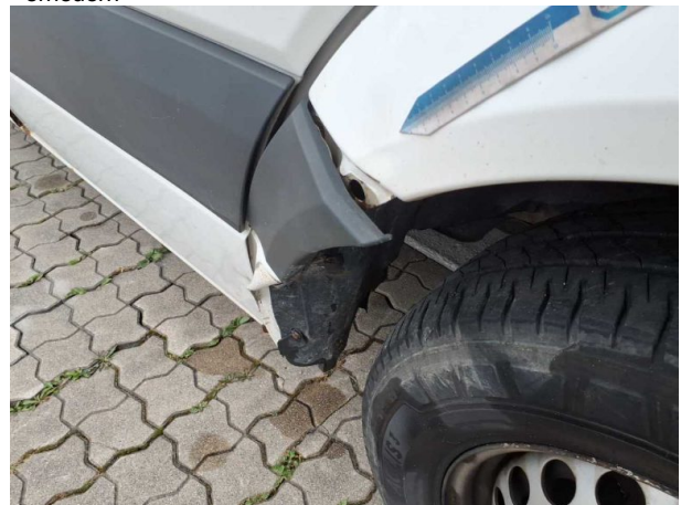
Beschädigung #16: Kotflügel rechts: Kotflügel rechts - verfor... - erneuern
