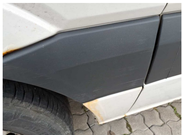
Beschädigung #31: Seitenwand rechts: Schutzleiste - Kratzer
