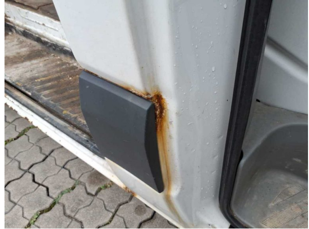
Beschädigung #25: Karosserie: B-Säule rechts - Korrosion - instandsetzen und lackieren
