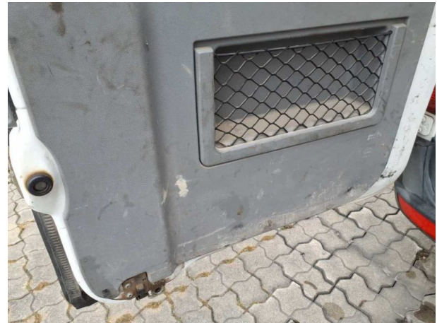
Beschädigung #5: Interieur: Laderaumboden (und Verkleidungen) - Kratzer
