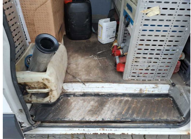
Beschädigung #28: Interieur: Laderaumboden - verformt - erneuern
