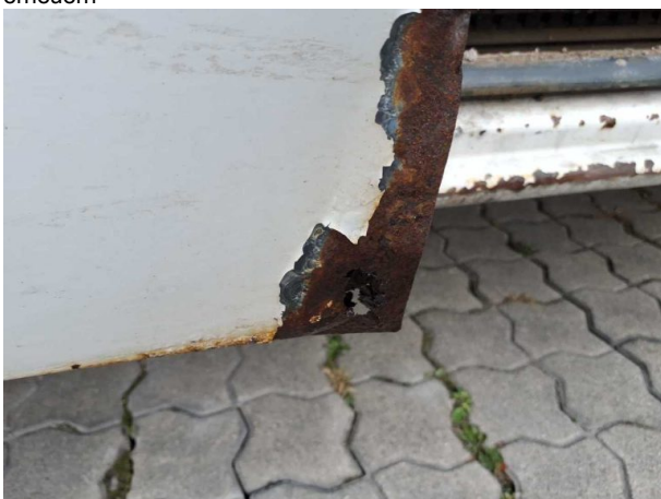
Beschädigung #27: Schiebetür rechts: Schiebetür - Korrosion - erneuern
