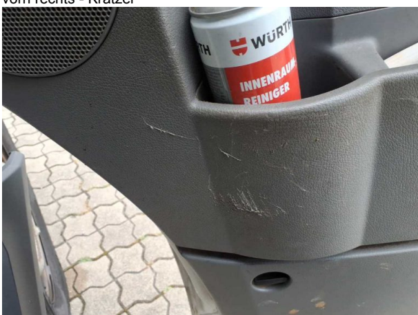
Beschädigung #22: Verkleidungen/Abdeckungen: Türverkleidung vorn rechts - Kratzer
