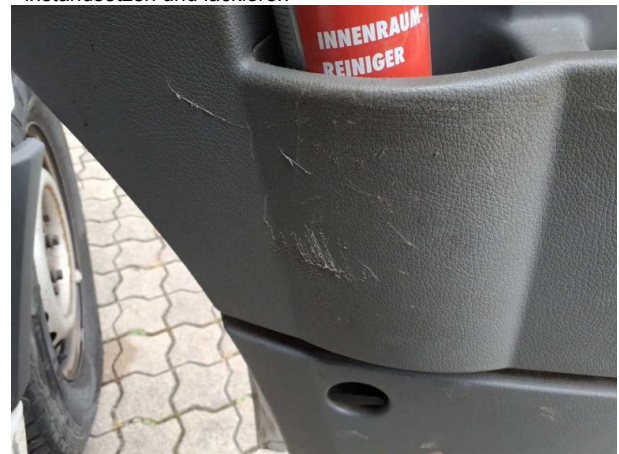
Beschädigung #22: Verkleidungen/Abdeckungen: Türverkleidung vorn rechts - Kratzer
