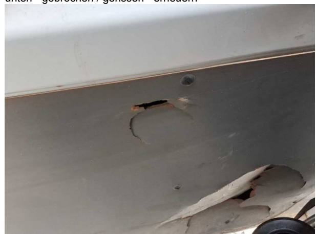
Beschädigung #26: Schiebetür rechts: Verkleidung Standard unten - gebrochen / gerissen - erneuern
