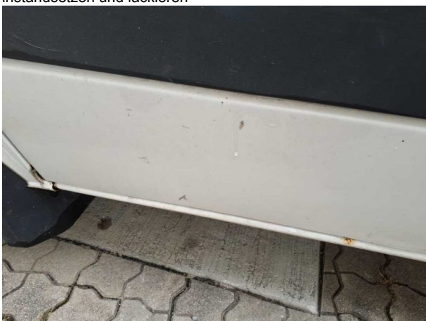
Beschädigung #46: Tür vorn links: Tür - verkratzt / verschürft - instandsetzen und lackieren
