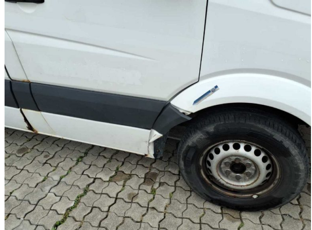
Beschädigung #16: Kotflügel rechts: Kotflügel rechts - verfor... - erneuern
