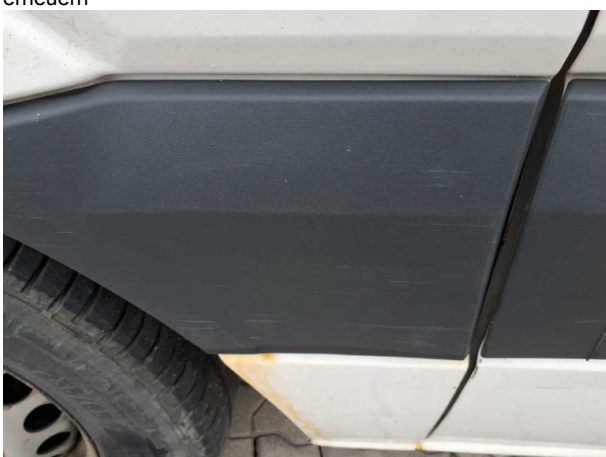
Beschädigung #31: Seitenwand rechts: Schutzleiste - Kratzer
