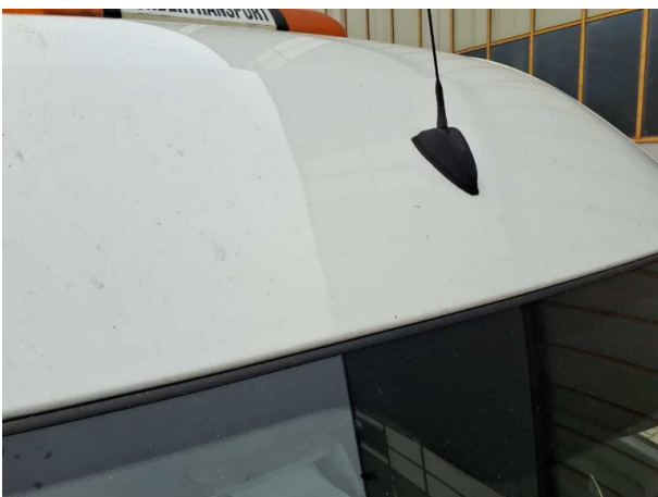
Beschädigung #43: Fahrzeugdach: Dach - Steinschlag
