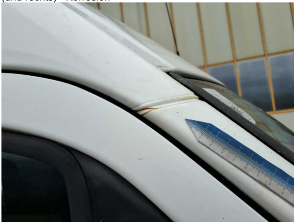
Beschädigung #20: Karosserie: A-Säule rechts - Korrosion - instandsetzen
