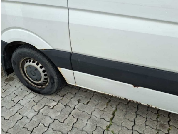
Beschädigung #30: Schiebetür rechts: Schutzleiste - Kratzer - erneuern
