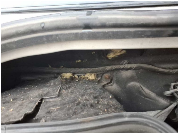
Beschädigung #2: Fahrerhaus: Dämmmatte - Marderschaden - erneuern
