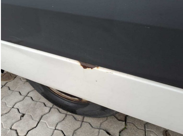
Beschädigung #27: Schiebetür rechts: Schiebetür - Korrosion - erneuern
