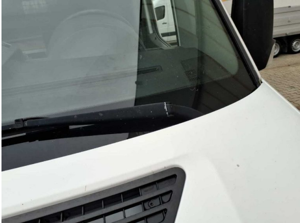
Beschädigung #19: Scheibenreinigung: Scheibenwischerarm links (und rechts) - Korrosion
