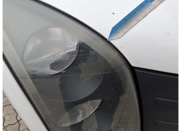
Beschädigung #15: Scheinwerfer: Scheinwerfer rechts (und links) - Funktion / Zulässigkeit - erneuern
