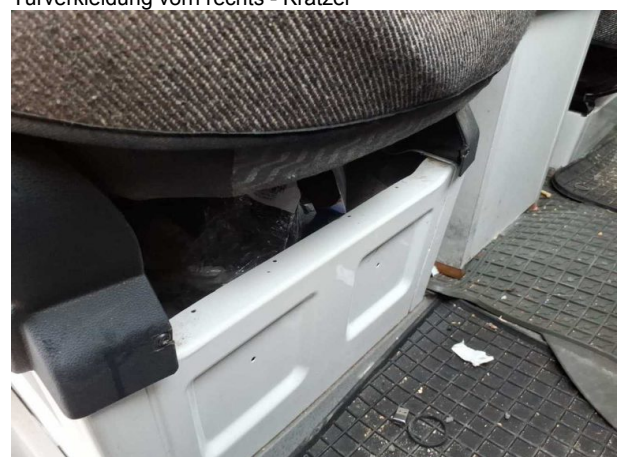
Beschädigung #23: Sitz vorn: Hebel Sitzverstellung - gebrochen / gerissen - erneuern
