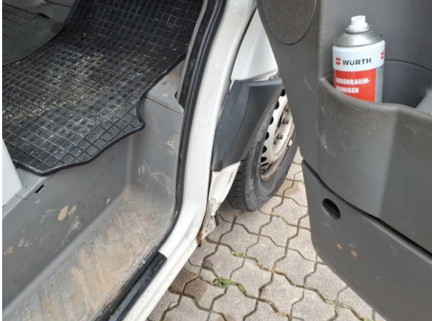
Beschädigung #16: Kotflügel rechts: Kotflügel rechts - verformt - erneuern
