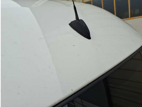
Beschädigung #43: Fahrzeugdach: Dach - Steinschlag
