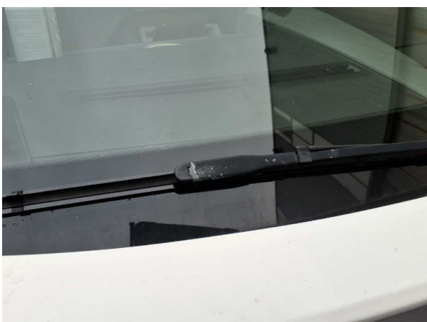
Beschädigung #19: Scheibenreinigung: Scheibenwischerarm links (und rechts) - Korrosion
