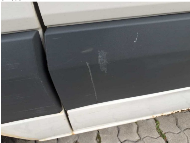
Beschädigung #30: Schiebetür rechts: Schutzleiste - Kratzer - erneuern
