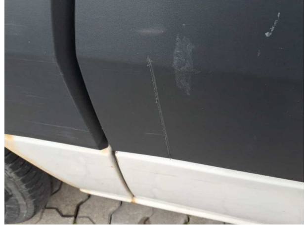
Beschädigung #30: Schiebetür rechts: Schutzleiste - Kratzer - erneuern
