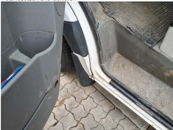
Beschädigung #36: Kotflügel links: Kotflügel links - Korrosion - instandsetzen und lackieren
