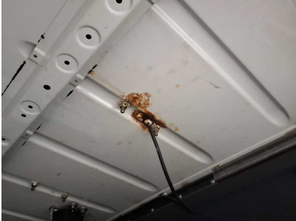
Beschädigung #8: Fahrzeugdach: Dach - Korrosion - Smart Repair
