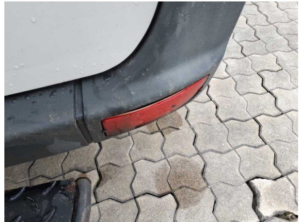
Beschädigung #32: Stossfänger hinten: Rückstrahler rechts - Funktion / Zulässigkeit - erneuern
