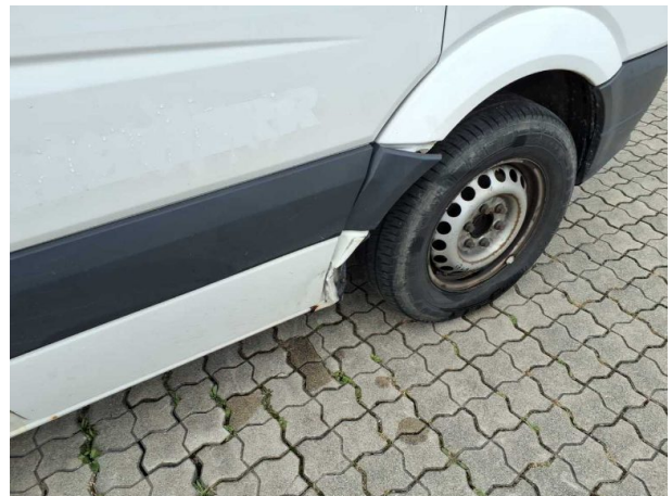
Beschädigung #42: Kotflügel rechts: Schmutzfänger - fehlt - erneuern
