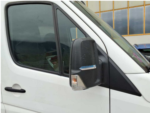
Beschädigung #18: Außenspiegel rechts: Abdeckkappe - Kratzer
