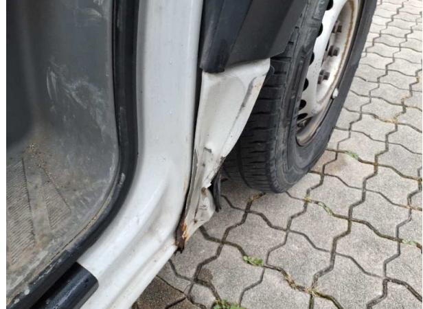
Beschädigung #16: Kotflügel rechts: Kotflügel rechts - verfor... - erneuern
