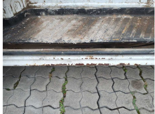
Beschädigung #24: Schweller rechts: Schweller - Korrosion - instandsetzen und lackieren
