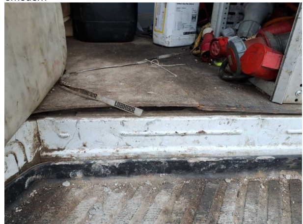
Beschädigung #28: Interieur: Laderaumboden - verformt - erneuern
