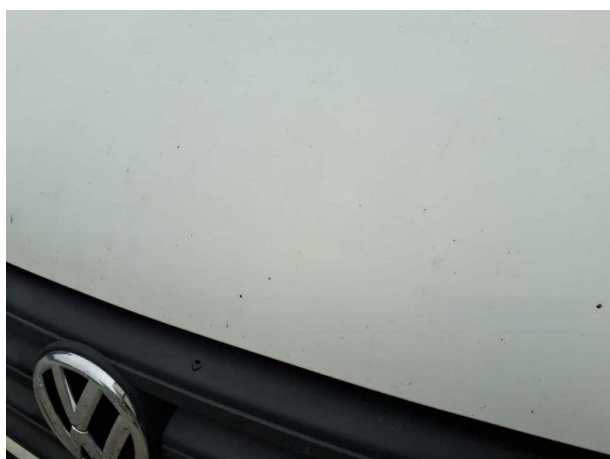
Beschädigung #12: Motorhaube: Motorhaube - Steinschlag
