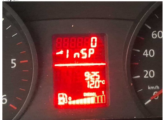
Beschädigung #10: Sonstiges: Inspektion/Wartung - fällig - durchführen
