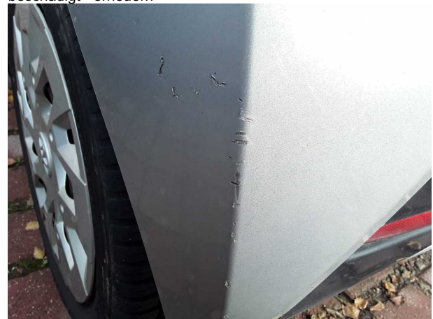
Beschädigung #6: Stossfänger hinten: Stossfänger hinten - verkratzt / verschürft - lackieren
