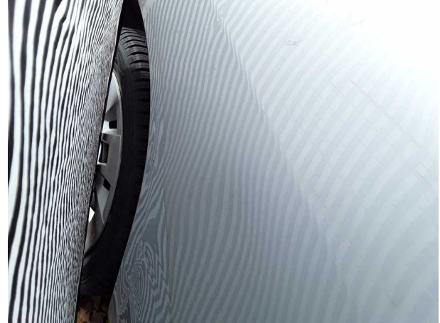
Beschädigung #5: Seitenwand rechts: Seitenwand - beschädigt - erneuern
