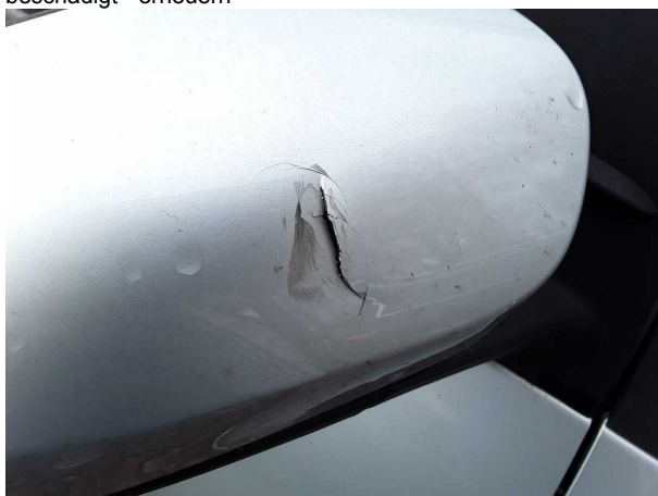
Beschädigung #4: Außenspiegel rechts: Abdeckkappe - beschädigt - erneuern
