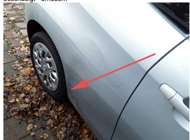
Beschädigung #5: Seitenwand rechts: Seitenwand - beschädigt - erneuern
