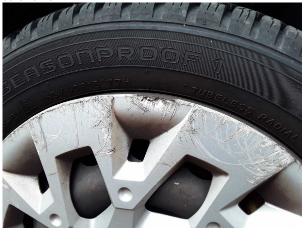
Beschädigung #3: Rad/Reifen: Radblende vorn rechts - beschädigt - erneuern
