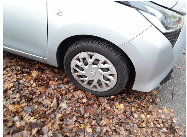
Beschädigung #3: Rad/Reifen: Radblende vorn rechts - beschädigt - erneuern
