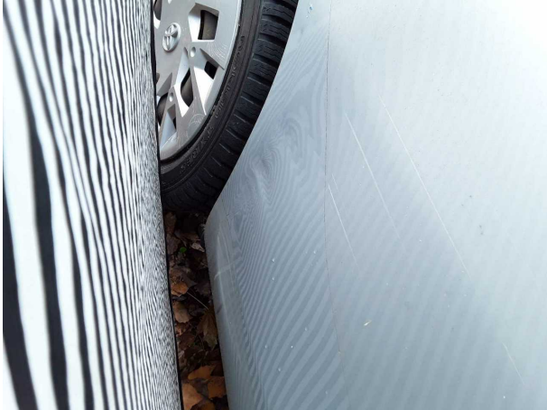
Beschädigung #5: Seitenwand rechts: Seitenwand - beschädigt - erneuern
