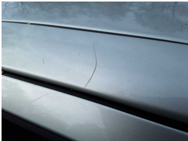
Beschädigung #10: Fahrzeugdach: Dachholm rechts - verkratzt / verschürft - Smart Repair
