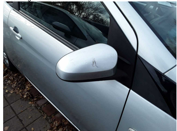
Beschädigung #4: Außenspiegel rechts: Abdeckkappe - beschädigt - erneuern
