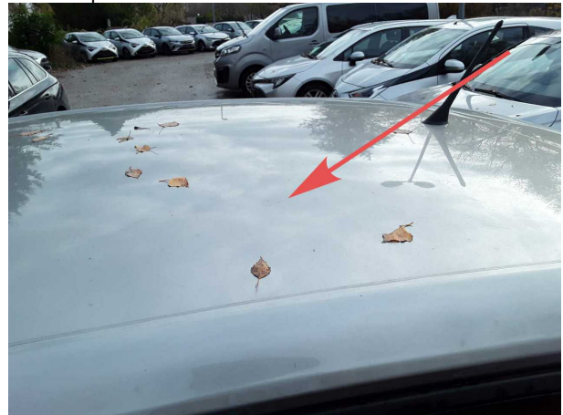
Beschädigung #8: Fahrzeugdach: Dach - Delle(n) - sanft instandsetzen
