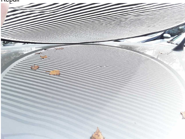
Beschädigung #8: Fahrzeugdach: Dach - Delle(n) - sanft instandsetzen
