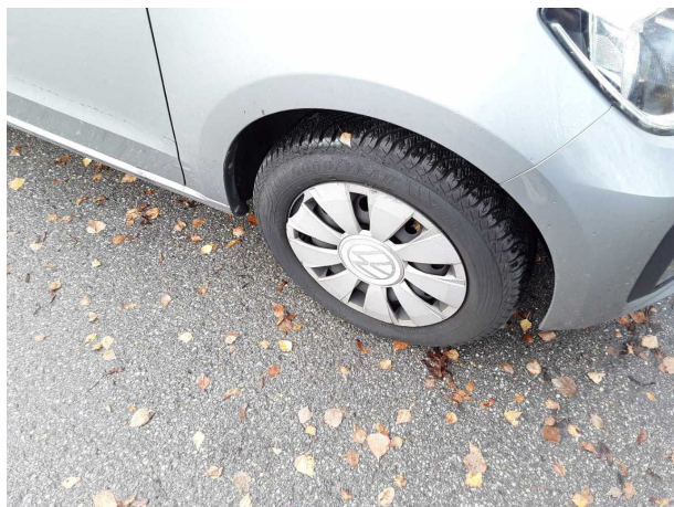
Beschädigung #2: Rad/Reifen: Radblende vorn rechts - beschädigt - erneuern
