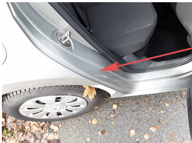
Beschädigung #5: Seitenwand rechts: Einstieg - Delle(n) - sanft instandsetzen
