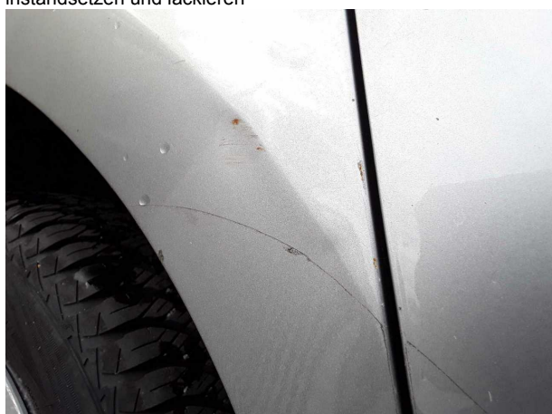
Beschädigung #6: Seitenwand rechts: Seitenwand - verformt - instandsetzen und lackieren
