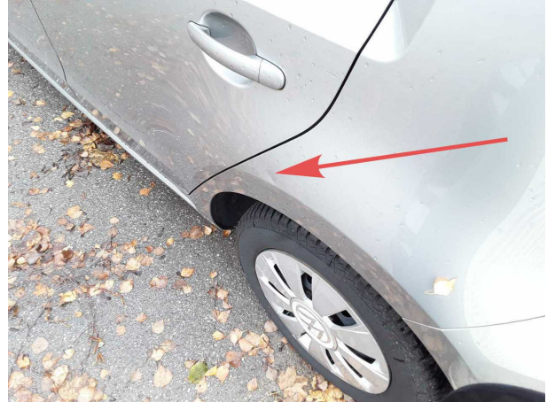
Beschädigung #7: Seitenwand links: Seitenwand - Delle(n) - Smart Repair
