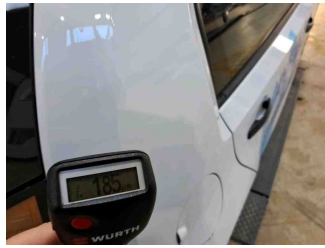
Lackstärke Seitenwand hinten rechts
