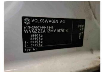
Fahrzeug - Typenschild/Fahrgestellnummer
