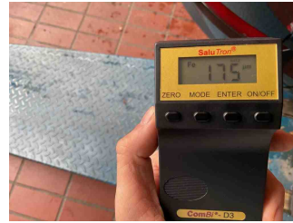
Lackstärke Seitenwand hinten rechts
