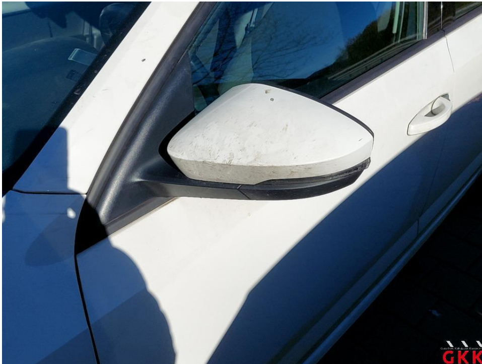
Bild 39 Spiegelgehäuse links, Kappe -lackiert-, verkratzt, lackieren
