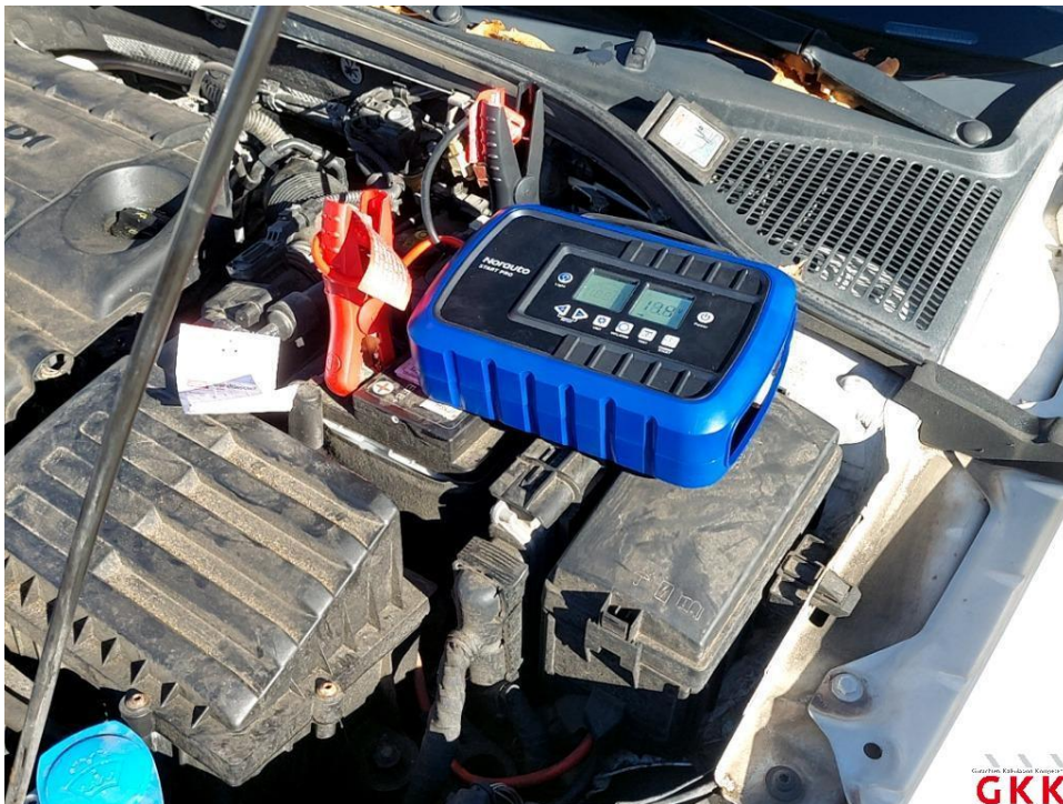
Bild 18 Fahrzeug, Batterie, entladen, ersetzen
