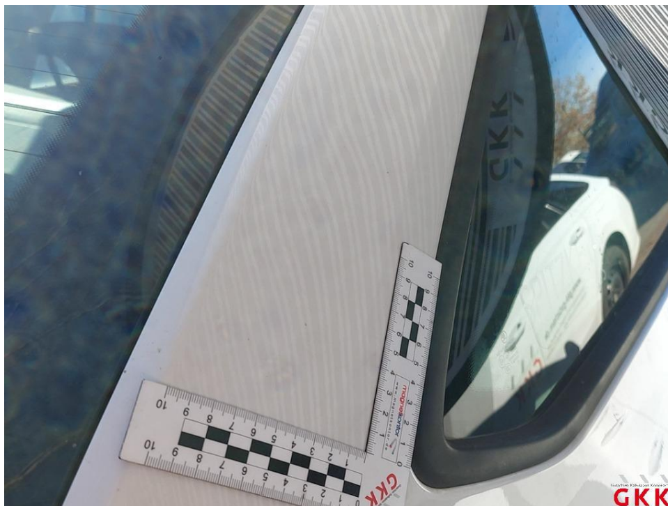
Bild 52 Seitenwand rechts, 4 bis 10 Dellen / Bauteil, kalt drücken
