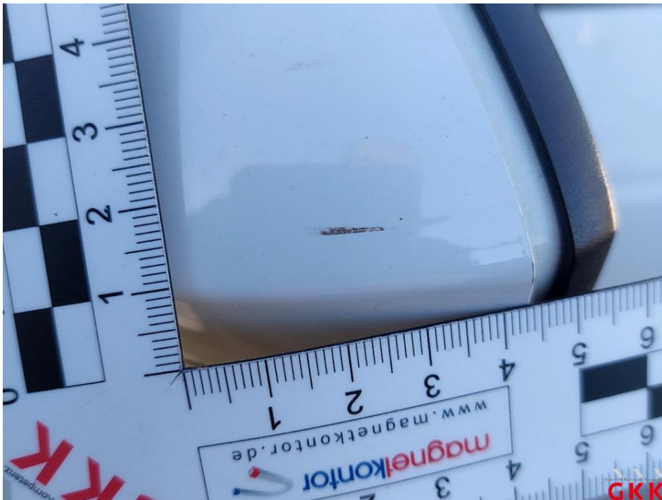
Bild 40 Spiegelgehäuse links, Kappe -lackiert-, verkratzt, lackieren
