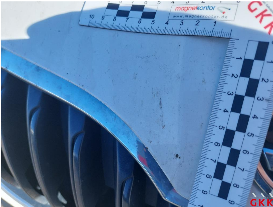
Bild 38 Motorhaube, Steinschlag und Kratzer, lackieren
