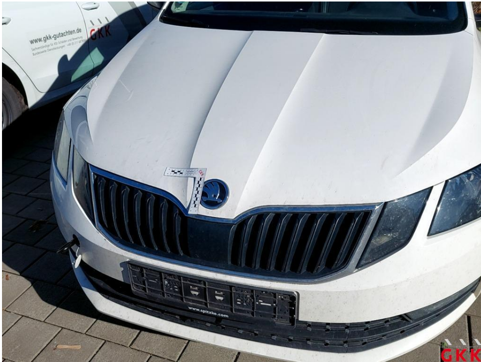
Bild 37 Motorhaube, Steinschlag und Kratzer, lackieren
