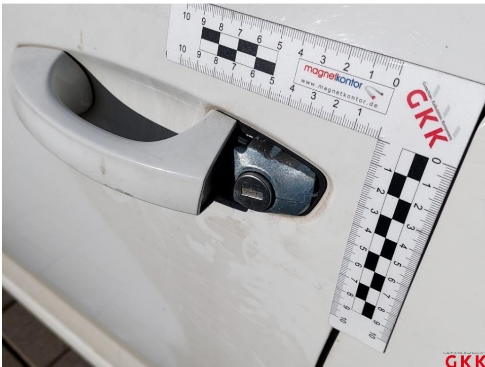
Bild 34 Tür vorne links, Griff -Blende-, fehlt, ersetzen
