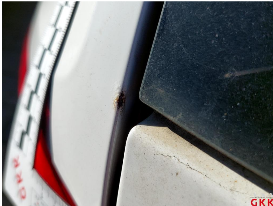
Bild 48 Seitenwand links, korrodiert, instand setzen - lackieren
