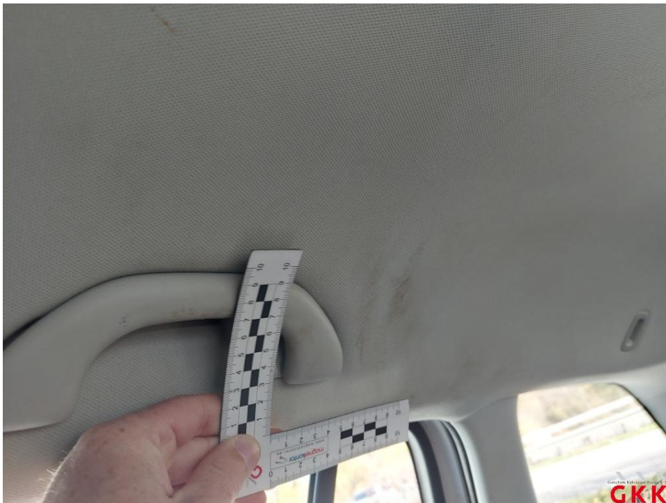
Bild 22 Himmel, verschmutzt, aufbereiten
