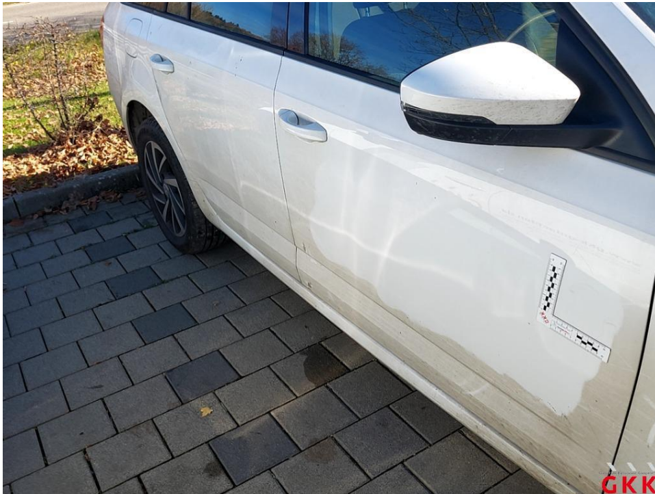
Bild 53 Tür vorne rechts, verkratzt, lackieren
