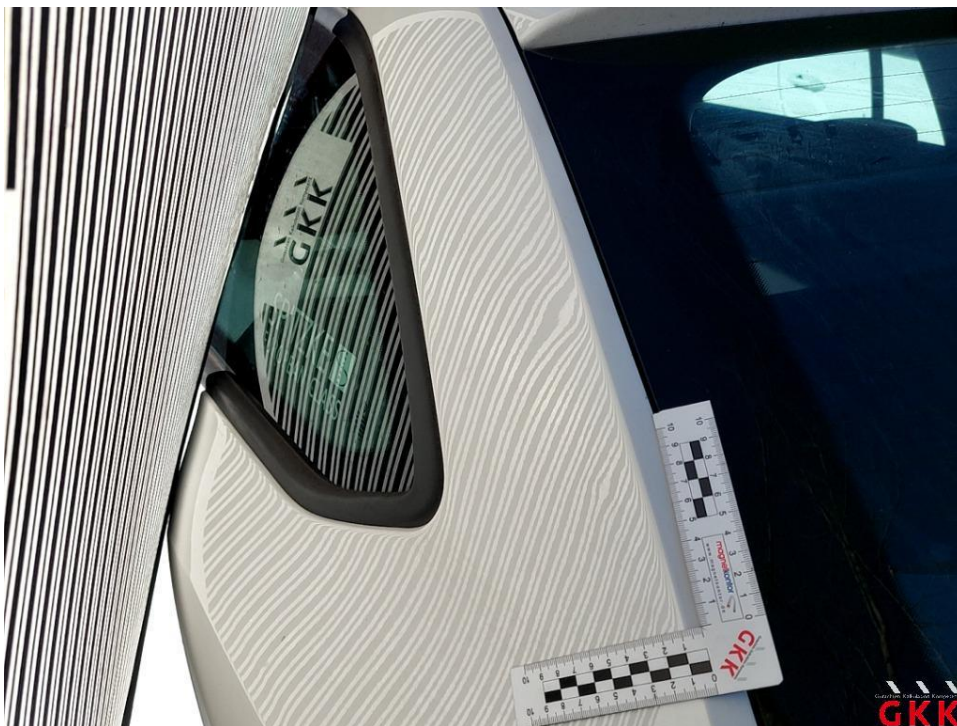
Bild 46 Seitenwand links, 4 bis 10 Dellen / Bauteil, kalt drücken
