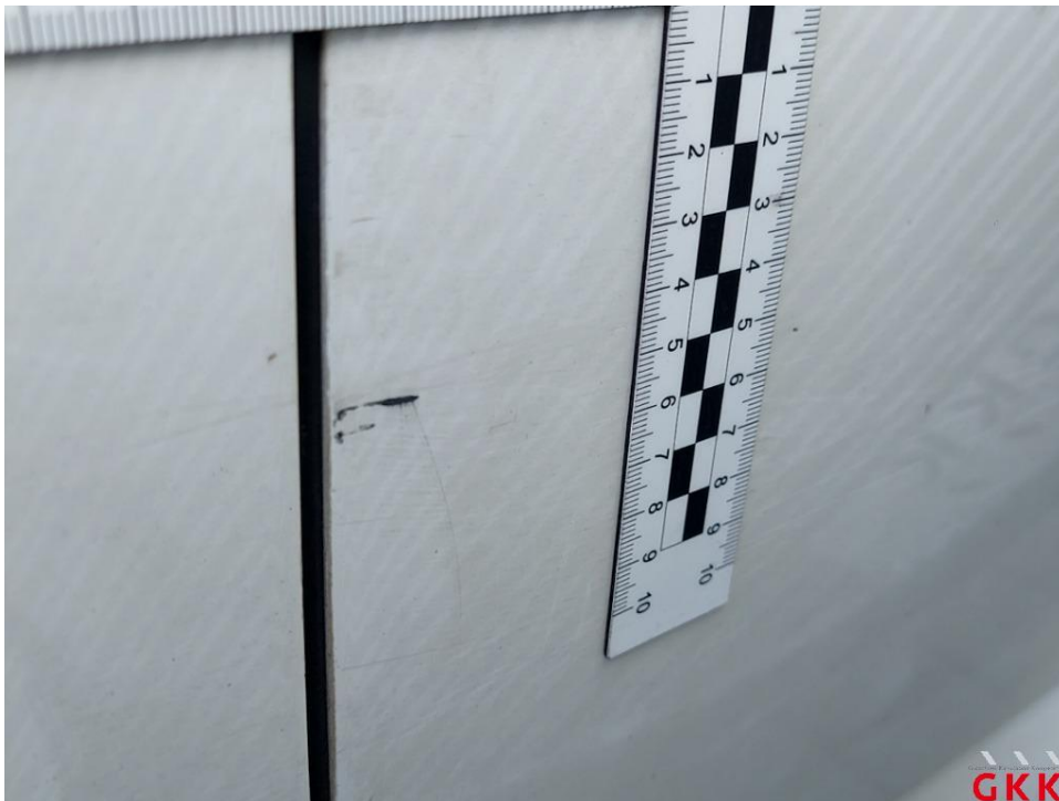
Bild 44 Tür hinten links, beschädigt, instand setzen - lackieren
