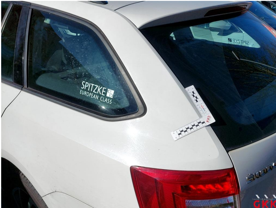
Bild 45 Seitenwand links, 4 bis 10 Dellen / Bauteil, kalt drücken
