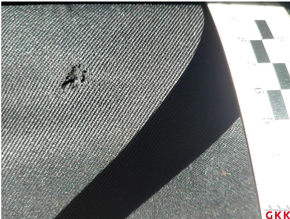
Bild 26 Sitzbank hinten, Bezug Sitzkissen -Stoff-, beschädigt, ersetzen
