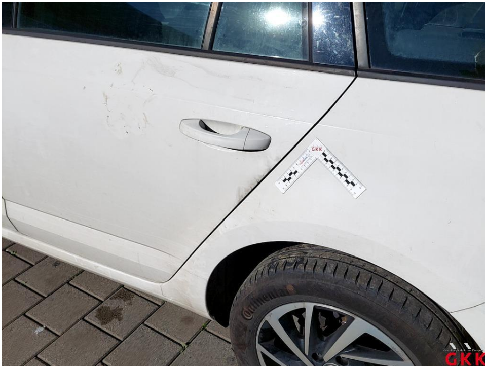
Bild 29 Tür hinten links, Kante, beschädigt, auslegen, schleifen, polieren
