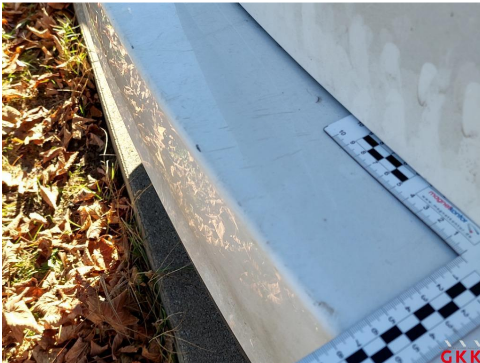
Bild 50 Stoßfänger hinten, Verkleidung -lackiert-, verkratzt, lackieren
