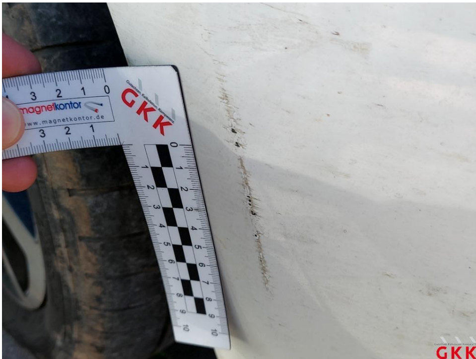
Bild 36 Stoßfänger vorne, Verkleidung -lackiert-, verkratzt, lackieren
