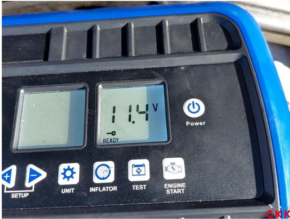
Bild 19 Fahrzeug, Batterie, entladen, ersetzen
