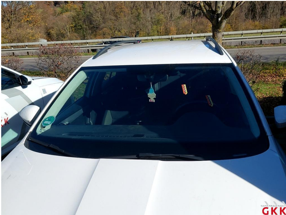
Bild 55 Frontscheibe, mit Regensensor, Steinschlag im Sichtfeld, ersetzen
