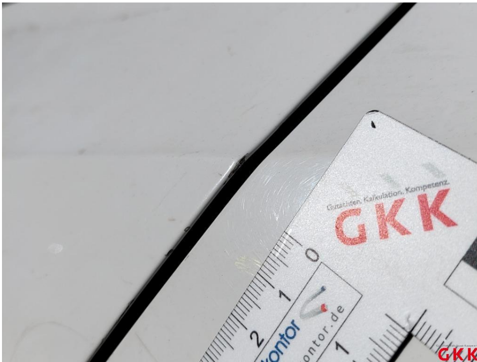
Bild 30 Tür hinten links, Kante, beschädigt, auslegen, schleifen, polieren
