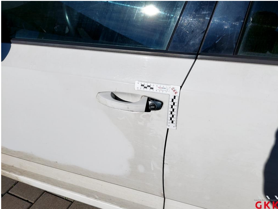
Bild 33 Tür vorne links, Griff -Blende-, fehlt, ersetzen
