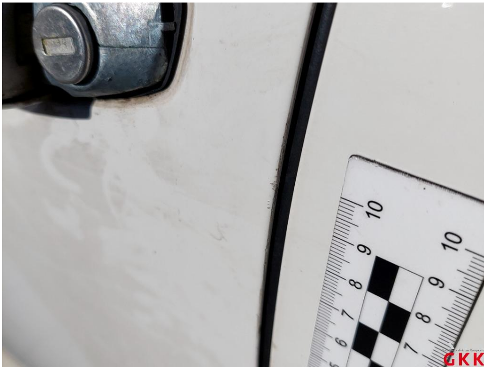
Bild 32 Tür vorne links, Kante, beschädigt, auslegen, schleifen, polieren
