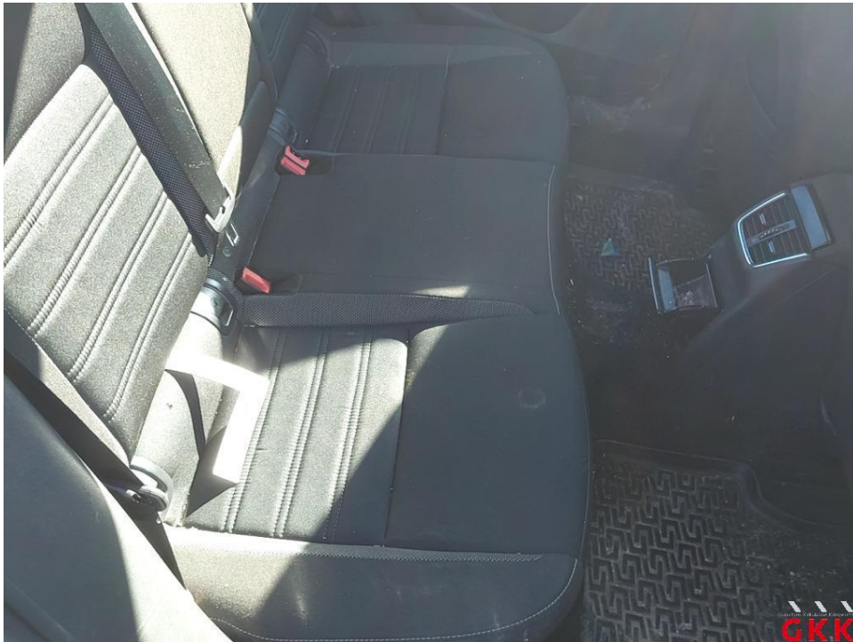
Bild 25 Sitzbank hinten, Bezug Sitzkissen -Stoff-, beschädigt, ersetzen
