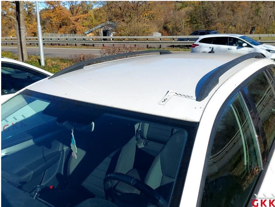
Bild 41 Dach, beschädigt, instand setzen - lackieren
