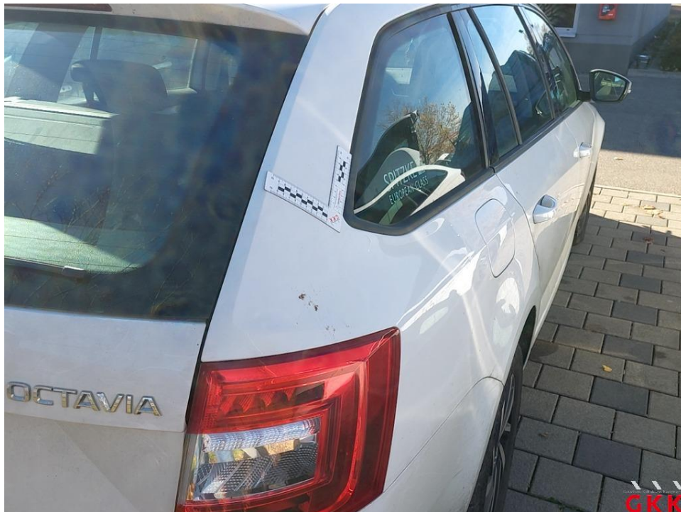
Bild 51 Seitenwand rechts, 4 bis 10 Dellen / Bauteil, kalt drücken
