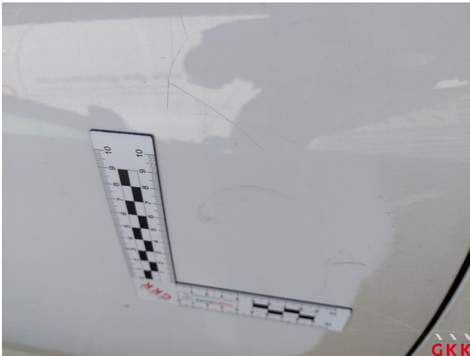
Bild 54 Tür vorne rechts, verkratzt, lackieren
