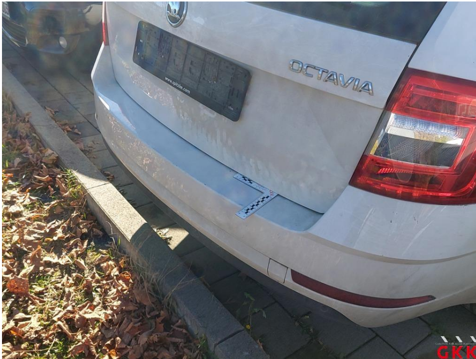
Bild 49 Stoßfänger hinten, Verkleidung -lackiert-, verkratzt, lackieren
