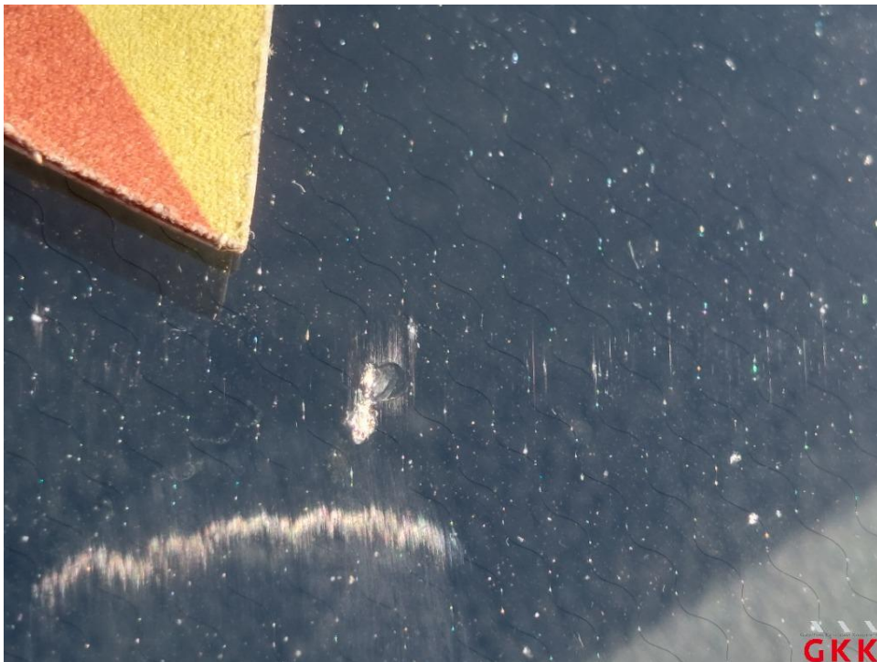
Bild 56 Frontscheibe, mit Regensensor, Steinschlag im Sichtfeld, ersetzen
