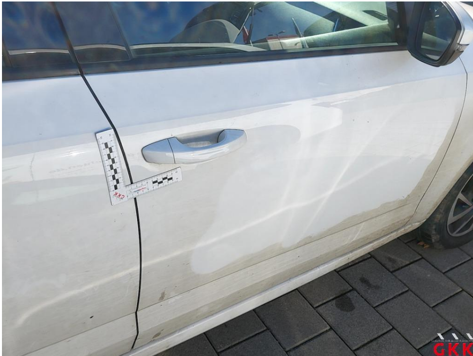
Bild 23 Tür vorne rechts, Kante, beschädigt, auslegen, schleifen, polieren
