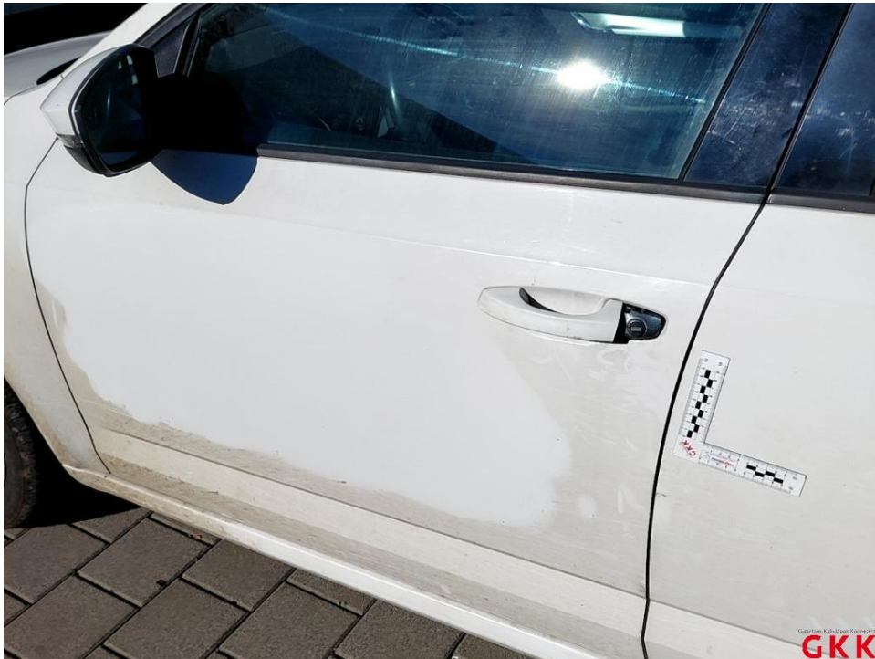
Bild 31 Tür vorne links, Kante, beschädigt, auslegen, schleifen, polieren
