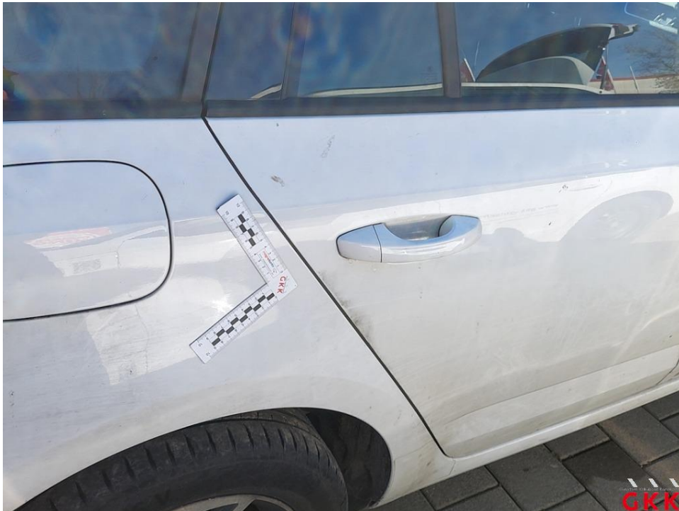
Bild 27 Tür hinten rechts, Kante, beschädigt, auslegen, schleifen, polieren
