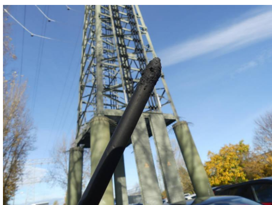
Bild 17: Technik / Antenne Marderbiss
