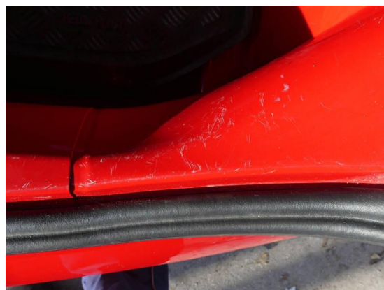
Bild 20: Innenraum / Laderraumkante Kratzer
