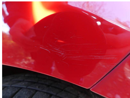
Bild 28: Karosserie / Fondseite links Kratzer+Delle
