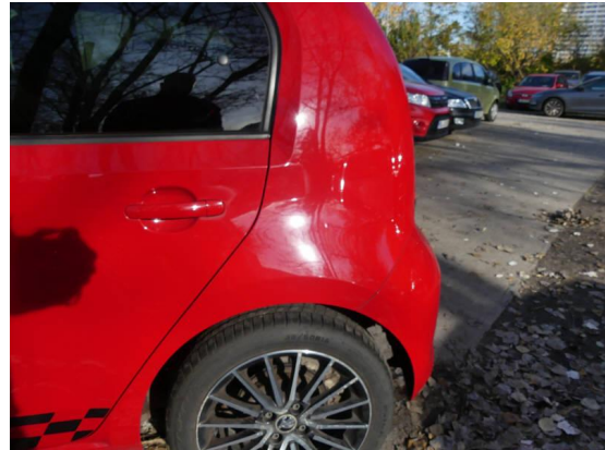
Bild 26: Karosserie / Fondseite links Kratzer+Delle
