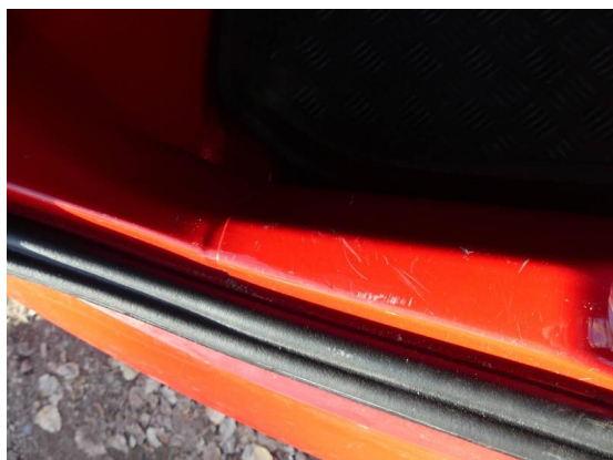
Bild 19: Innenraum / Laderraumkante Kratzer
