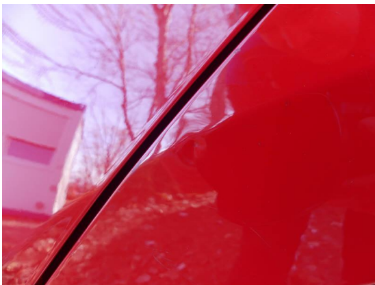
Bild 27: Karosserie / Fondseite links Kratzer+Delle
