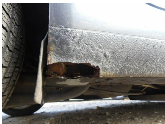
Bild 35: Karosserie / Schweller rechts Korrosion
