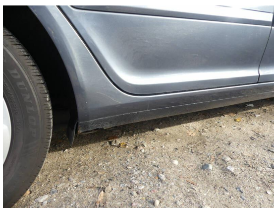
Bild 33: Karosserie / Schweller rechts Korrosion
