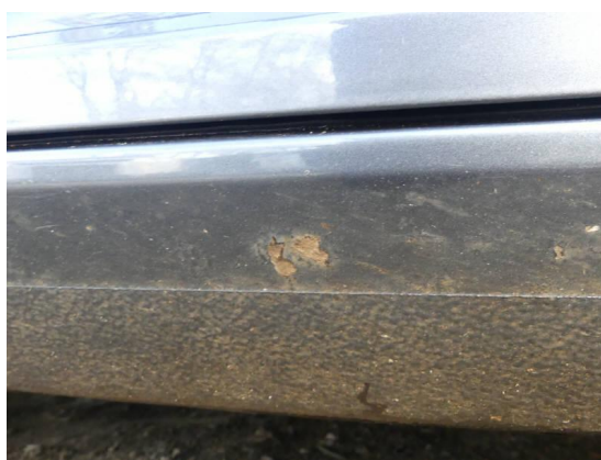
Bild 34: Karosserie / Schweller rechts Korrosion
