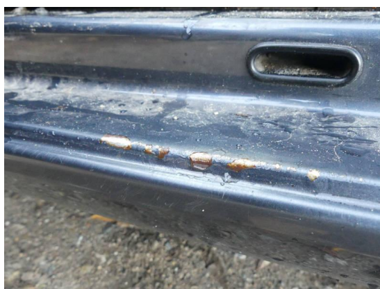
Bild 42: Karosserie / Einstiege vorne links Lackschaden mit Korrosion
