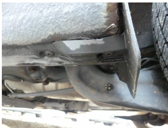
Bild 32: Karosserie / Schweller links Korrosion
