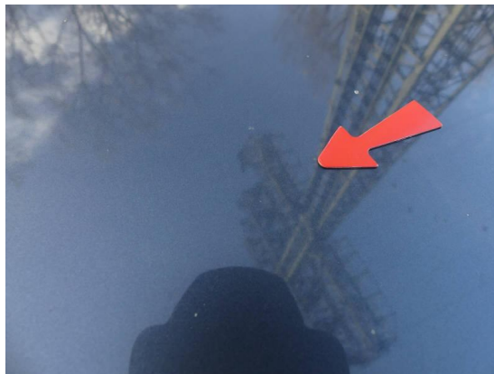
Bild 2: Karosserie / Dach Dellen
