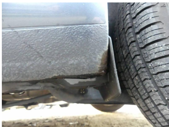
Bild 31: Karosserie / Schweller links Korrosion
