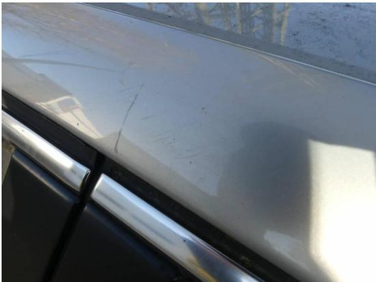
Bild 45: Karosserie / Dachseite links Kratzer
