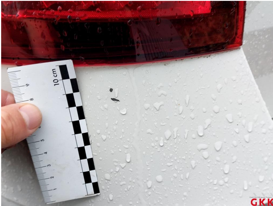
Bild 17 Stoßfänger hinten, Verkleidung -lackiert-, verkratzt, lackieren
