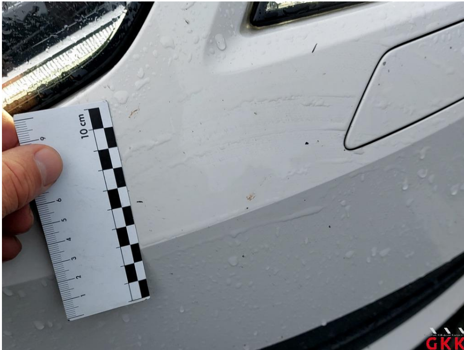
Bild 21 Stoßfänger vorne, Verkleidung -lackiert-, Steinschlag, lackieren
