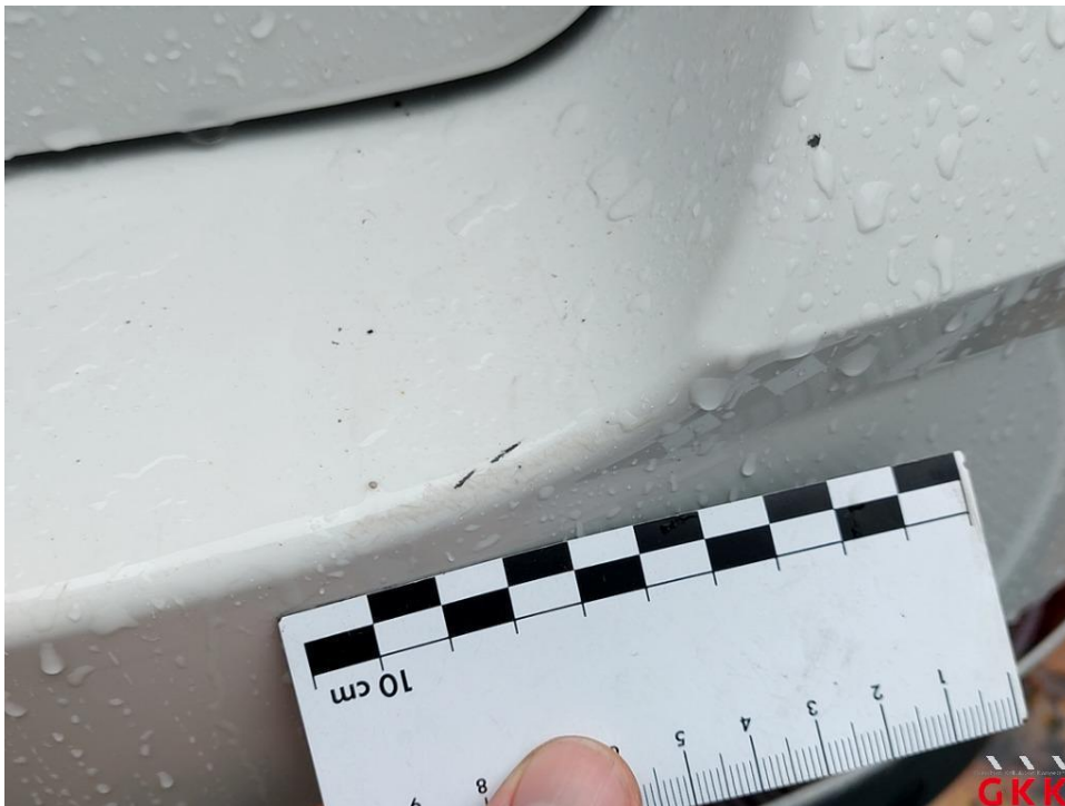
Bild 18 Stoßfänger hinten, Verkleidung -lackiert-, verkratzt, lackieren
