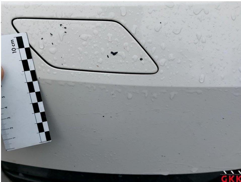
Bild 22 Stoßfänger vorne, Verkleidung -lackiert-, Steinschlag, lackieren
