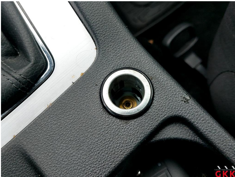
Bild 16 Mittelkonsole, Steckdose -Abdeckung-, fehlt, ersetzen
