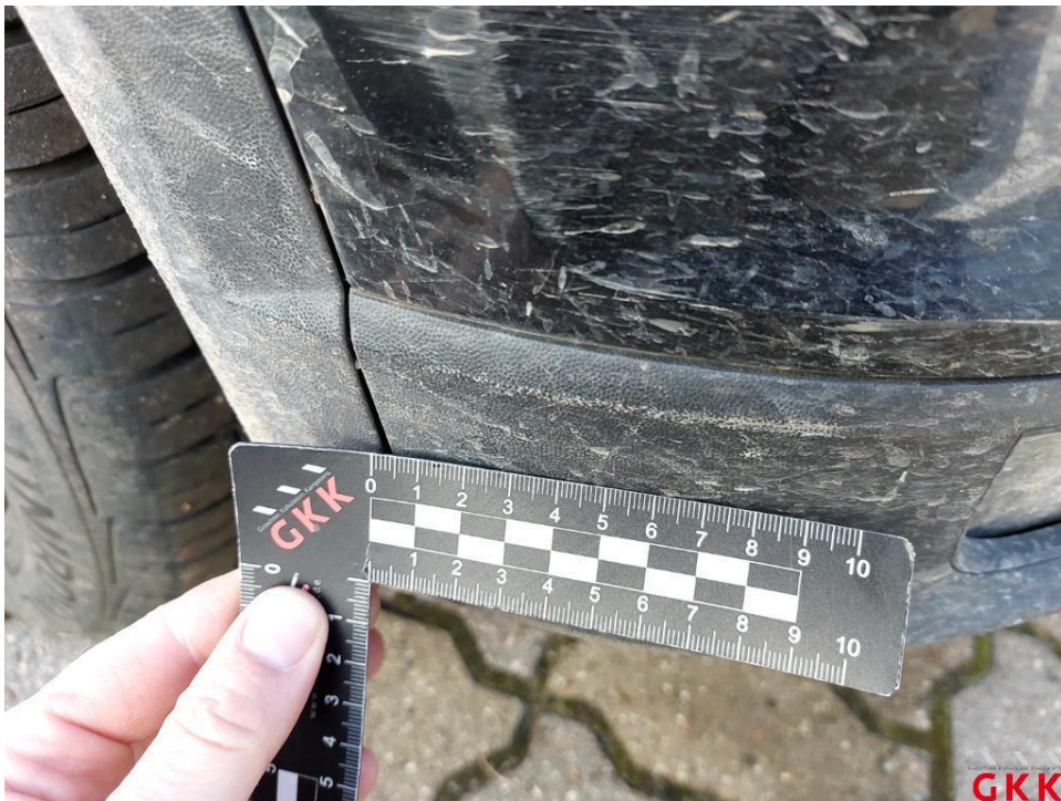
Bild 36 Stoßfänger vorne, Blende -unlackiert-, verkratzt, ersetzen
