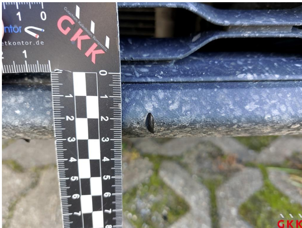
Bild 24 Stoßfänger vorne, Spoiler -unlackiert-, beschädigt, ersetzen
