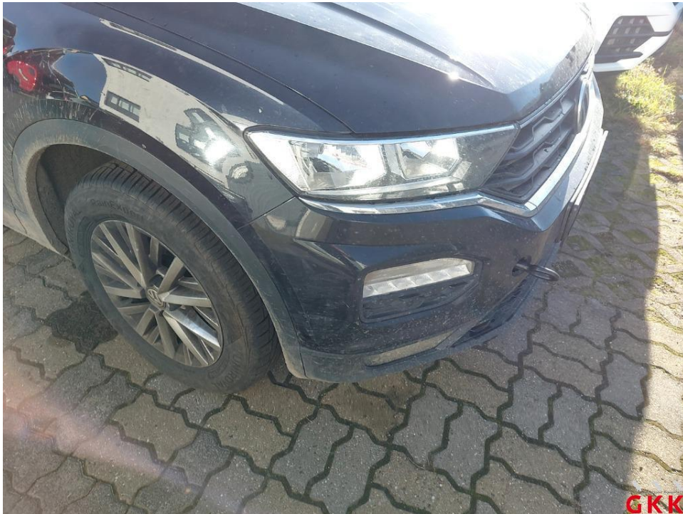
Bild 33 Stoßfänger vorne, Verkleidung -lackiert-, verkratzt, lackieren
