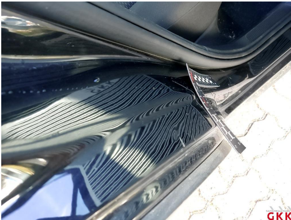
Bild 32 Tür hinten rechts, Einstieg, beschädigt, instand setzen - lackieren
