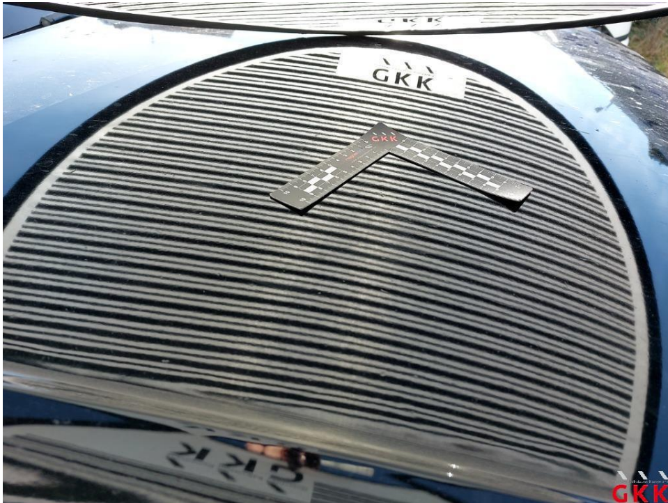
Bild 21 Motorhaube, Reparaturmangel, lackieren
