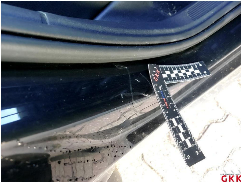
Bild 31 Tür hinten rechts, Einstieg, beschädigt, instand setzen - lackieren
