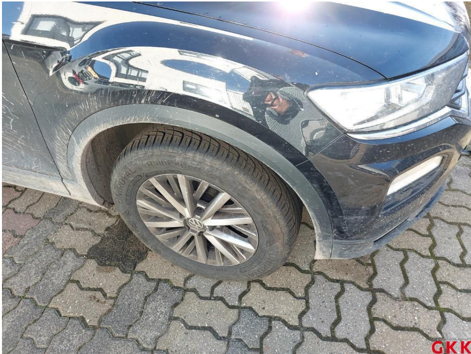
Bild 37 Kotflügel vorne rechts, Leiste, Radlauf, verkratzt, ersetzen
