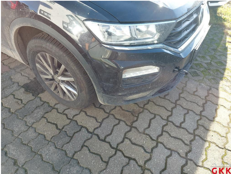
Bild 35 Stoßfänger vorne, Blende -unlackiert-, verkratzt, ersetzen
