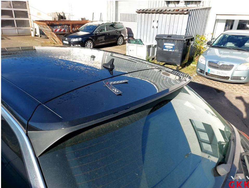
Bild 27 Heckklappe, Spoiler -lackiert-, verkratzt, lackieren
