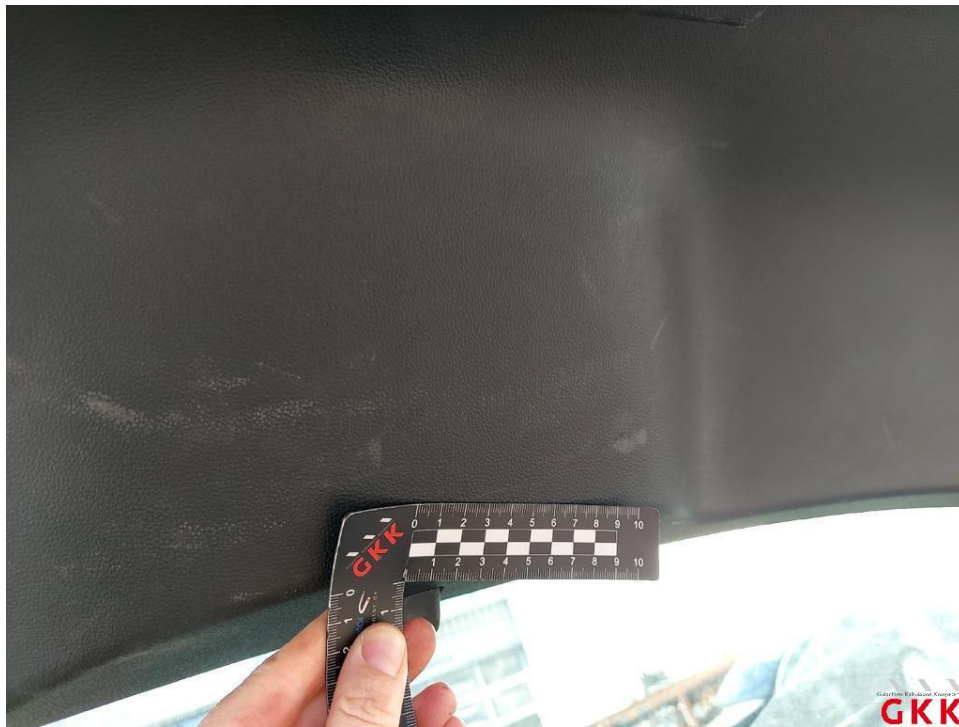
Bild 30 Heckklappe, Innenverkleidung, verkratzt, Smartrepair
