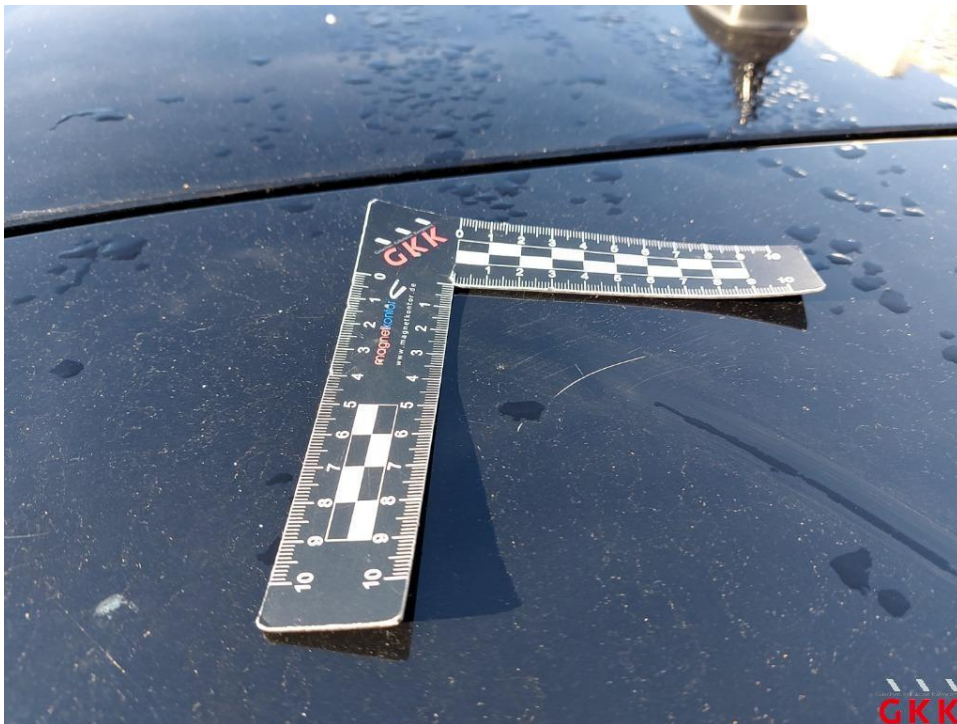
Bild 28 Heckklappe, Spoiler -lackiert-, verkratzt, lackieren
