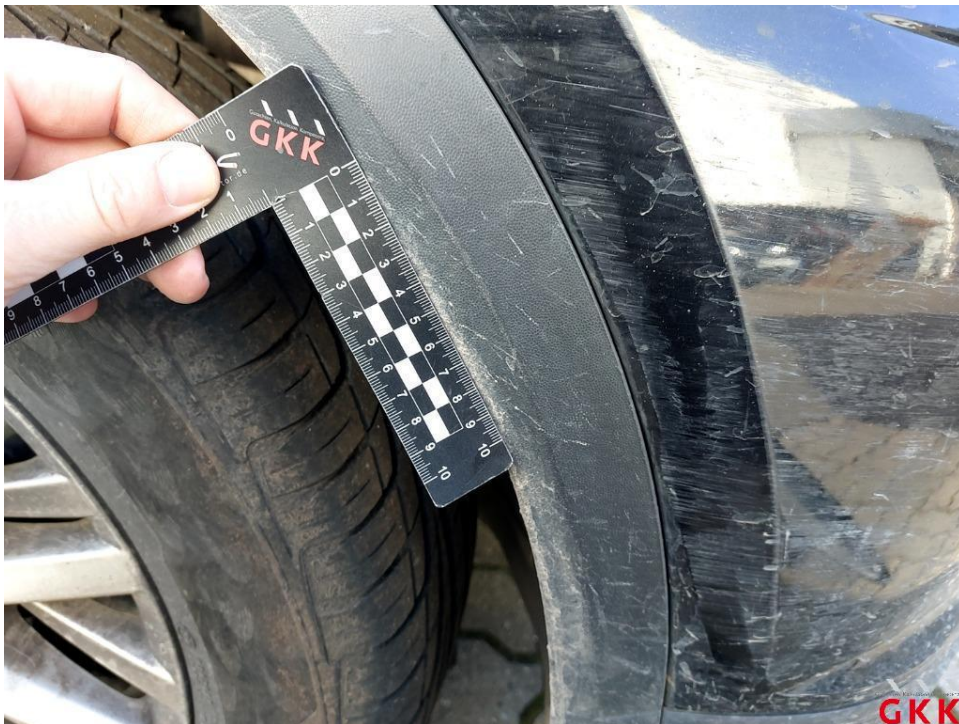
Bild 38 Kotflügel vorne rechts, Leiste, Radlauf, verkratzt, ersetzen
