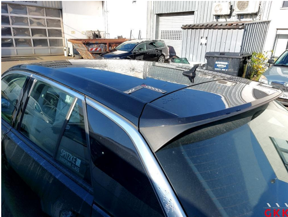
Bild 25 Dach, verkratzt, lackieren
