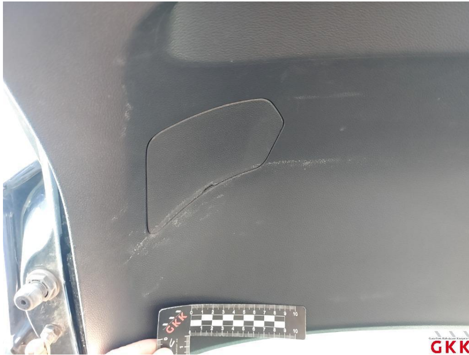
Bild 29 Heckklappe, Innenverkleidung, verkratzt, Smartrepair
