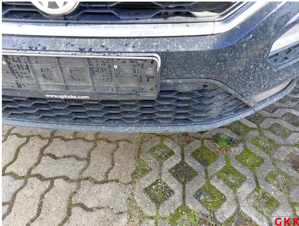
Bild 23 Stoßfänger vorne, Spoiler -unlackiert-, beschädigt, ersetzen
