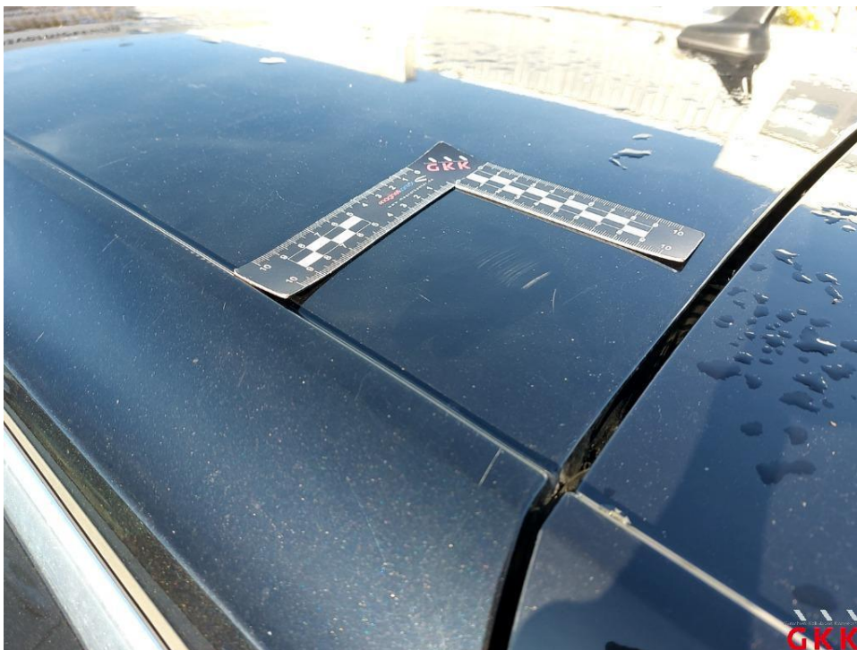
Bild 26 Dach, verkratzt, lackieren
