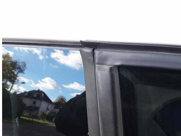
Beschädigung #10: Tür vorn rechts: Türdichtung (Außen) - gebrochen / gerissen - erneuern
