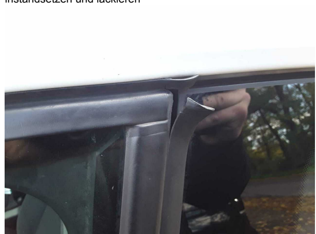
Beschädigung #9: Tür vorn links: Türdichtung (Außen) - gebrochen / gerissen - erneuern
