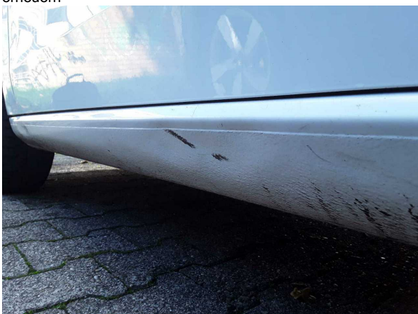
Beschädigung #3: Schweller links: Schweller - Delle / Lackschaden - instandsetzen und lackieren
