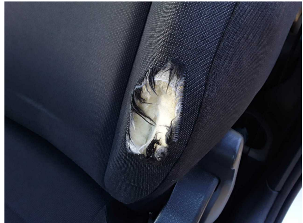
Beschädigung #1: Sitz vorn: Lehnenbezug links - gebrochen / gerissen - erneuern
