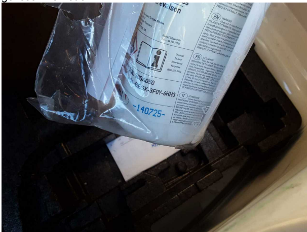
Beschädigung #2: Ausrüstung: Tirefit Füllmittel - abgelaufen - erneuern
