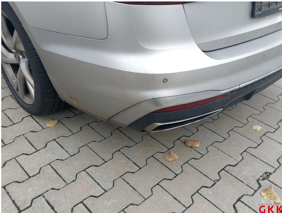
Bild 18 Stoßfänger hinten, PDC-Sensor, beschädigt, ersetzen
