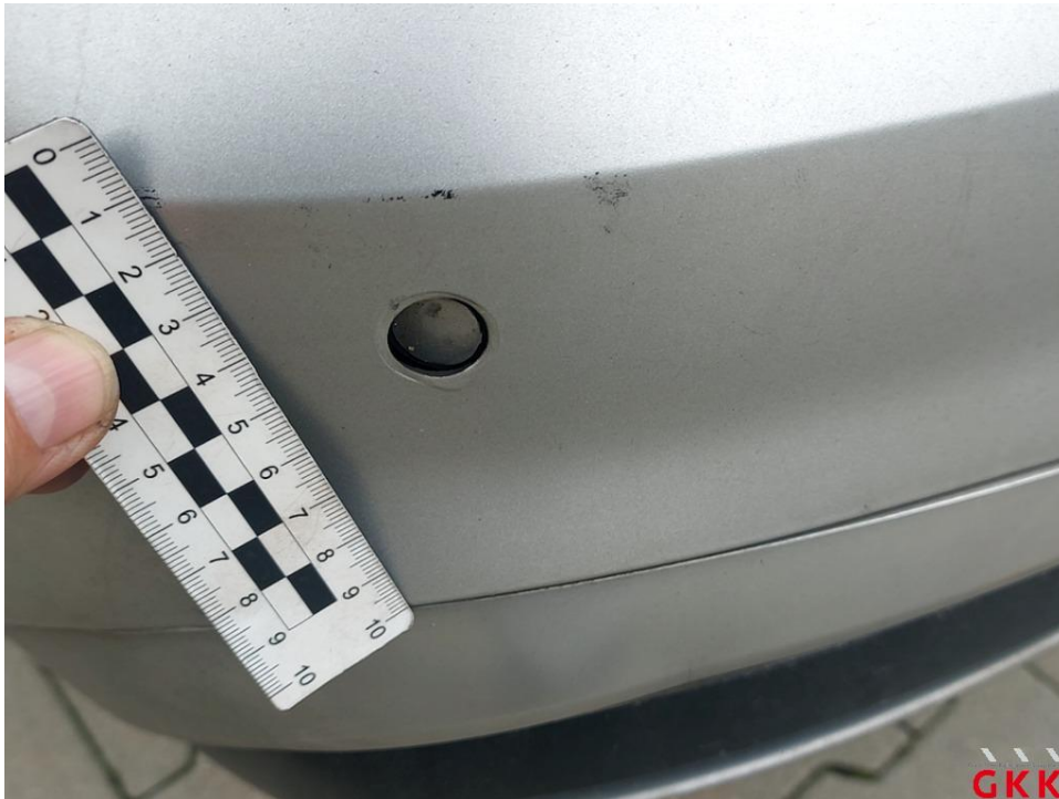
Bild 19 Stoßfänger hinten, PDC-Sensor, beschädigt, ersetzen
