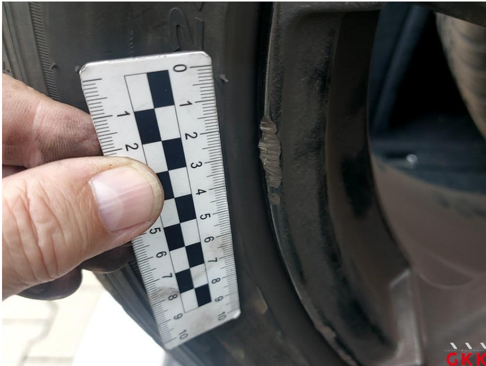
Bild 15 LM-Rad, 1 x beiliegend, beschädigt, ersetzen
