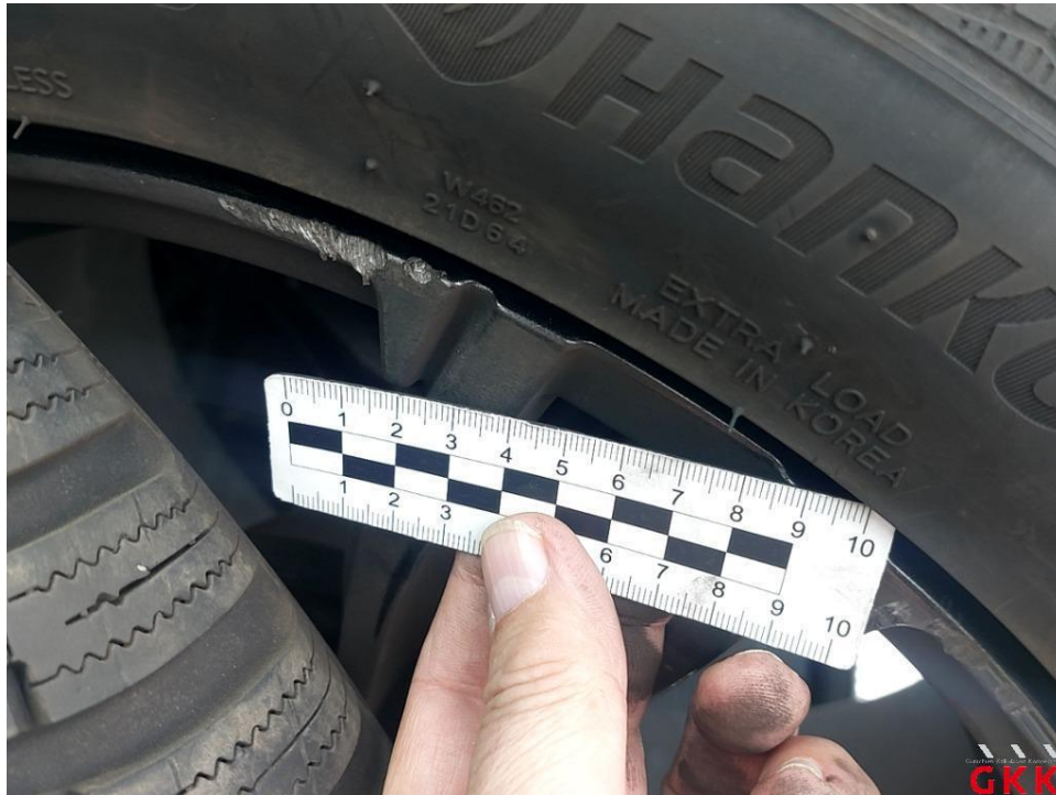
Bild 13 LM-Rad, 1 x beiliegend, beschädigt, ersetzen
