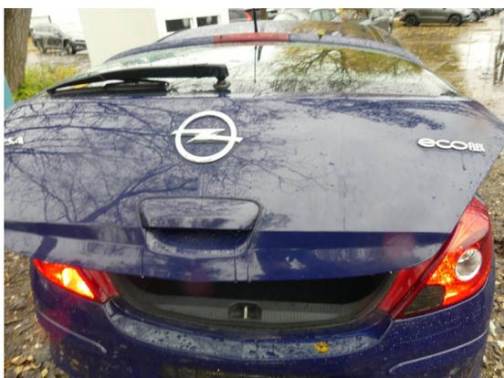
Bild 5: Karosserie / Heckklappe Kratzer
