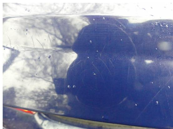
Bild 6: Karosserie / Heckklappe Kratzer
