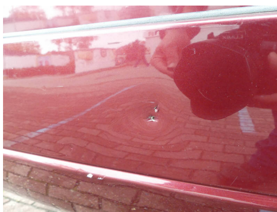
Bild 40: Karosserie / Stoßfänger hinten gebrochen
