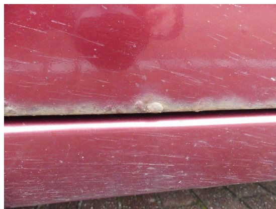
Bild 20: Karosserie / Tür vorne rechts Kratzer+Korrosion
