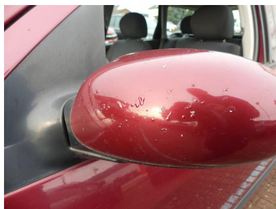
Bild 54: Karosserie / Außenspiegelkappe links und rechts Lackschaden
