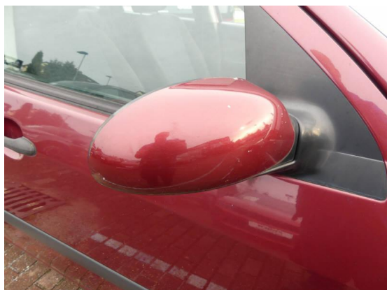
Bild 55: Karosserie / Außenspiegelkappe links und rechts Lackschaden
