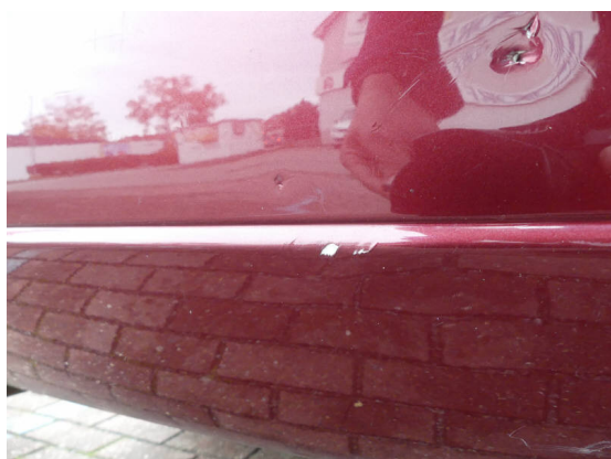
Bild 41: Karosserie / Stoßfänger hinten gebrochen
