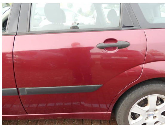
Bild 45: Karosserie / Tür hinten links Kratzer+Delle
