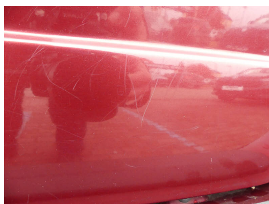
Bild 36: Karosserie / Heckklappe Kratzer+Delle
