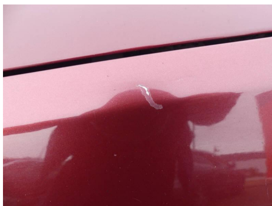
Bild 4: Karosserie / Kotflügel vorne links Kratzer
