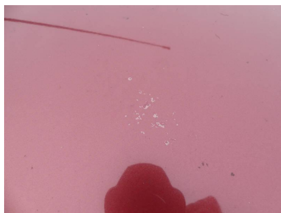
Bild 60: Karosserie / Dach Lackschäden
