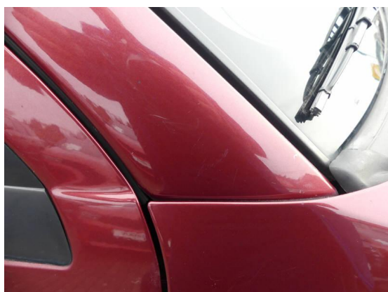
Bild 17: Karosserie / A-Säule rechts außen Kratzer
