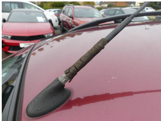
Bild 2: Technik / Antenne verschlissen
