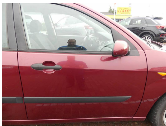
Bild 18: Karosserie / Tür vorne rechts Kratzer+Korrosion
