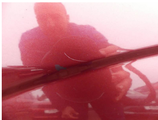
Bild 14: Karosserie / Kotflügel vorne rechts Kratzer
