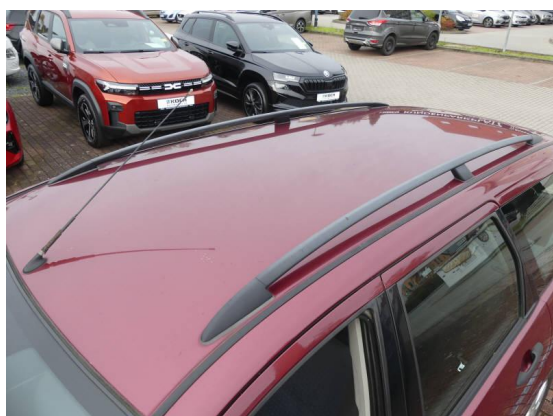
Bild 59: Karosserie / Dach Lackschäden
