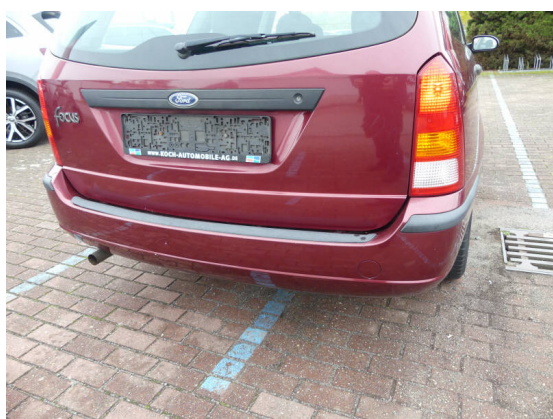
Bild 39: Karosserie / Stoßfänger hinten gebrochen
