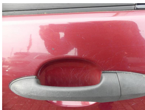
Bild 48: Karosserie / Tür hinten links Kratzer+Delle
