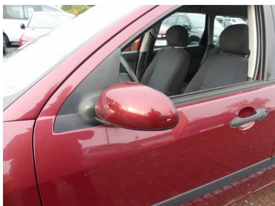
Bild 53: Karosserie / Außenspiegelkappe links und rechts Lackschaden
