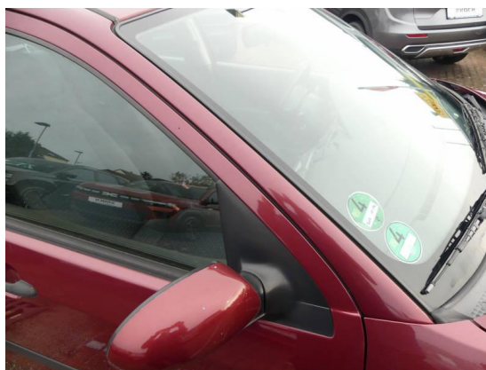
Bild 16: Karosserie / A-Säule rechts außen Kratzer
