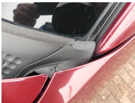
Bild 6: Karosserie / Abdichtung Wasserkasten gerissen
