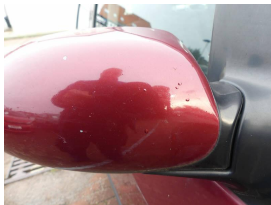
Bild 56: Karosserie / Außenspiegelkappe links und rechts Lackschaden
