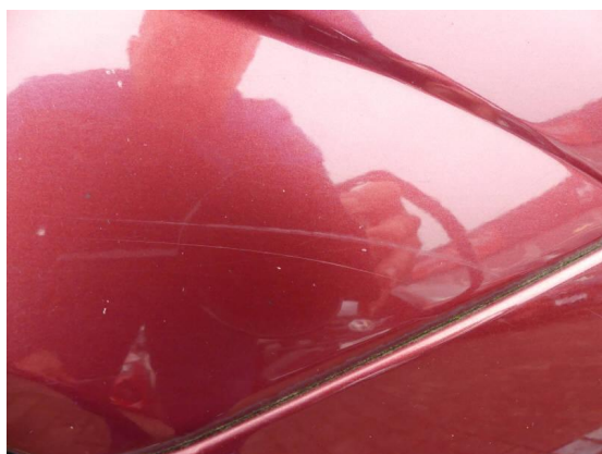
Bild 15: Karosserie / Kotflügel vorne rechts Kratzer
