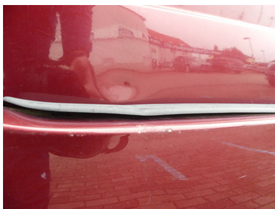
Bild 42: Karosserie / Stoßfänger hinten gebrochen
