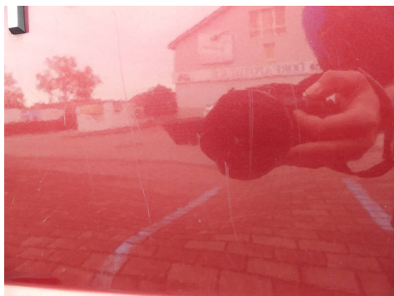
Bild 37: Karosserie / Heckklappe Kratzer+Delle
