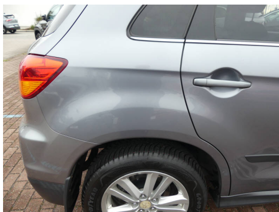
Bild 4: Karosserie / Fondseite rechts Kratzer
