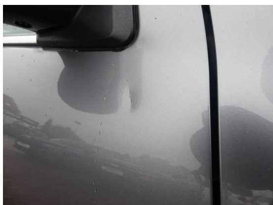
Bild 35: Karosserie / Tür vorne rechts Kratzer
