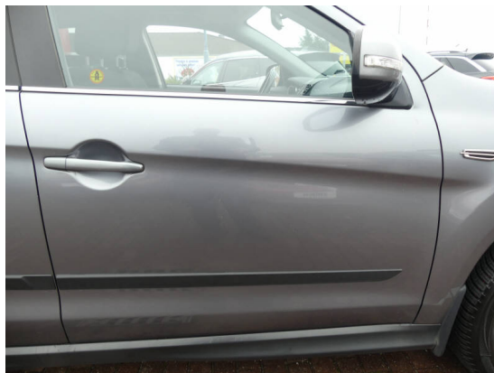
Bild 32: Karosserie / Tür vorne rechts Kratzer
