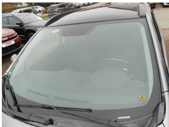
Bild 19: Karosserie / Frontscheibe Steinschlag
