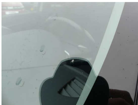
Bild 20: Karosserie / Frontscheibe Steinschlag
