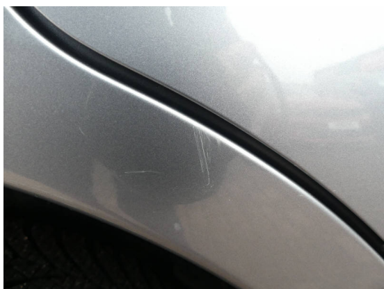
Bild 5: Karosserie / Fondseite rechts Kratzer
