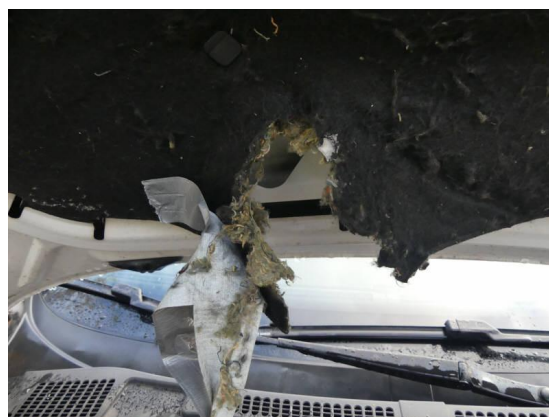
Bild 16: Karosserie / Motordämmmatte gerissen
