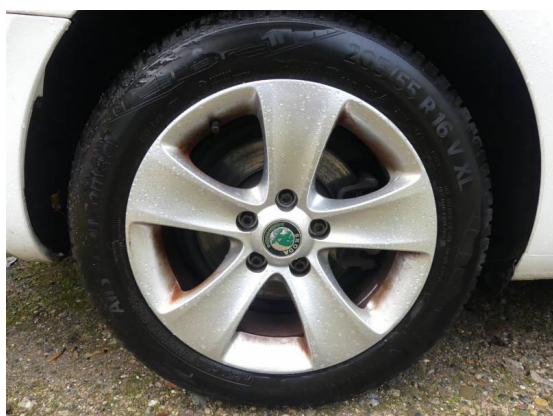
Bild 35: Reifen - Felge / Felge vorne und hinten rechts Kratzer
