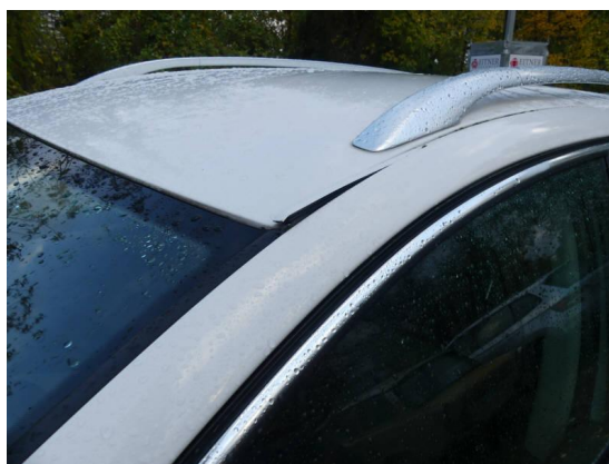
Bild 22: Karosserie / Dach-Leiste/Dichtung Befestigung mangelhaft
