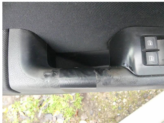
Bild 14: Innenraum / Türverkleidung/Türgriff vorne links verschlissen/abgenutzt
