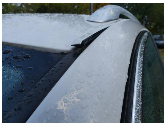
Bild 23: Karosserie / Dach-Leiste/Dichtung Befestigung mangelhaft
