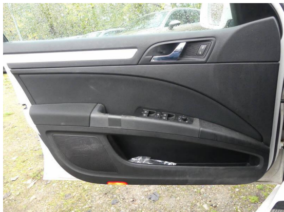
Bild 13: Innenraum / Türverkleidung/Türgriff vorne links verschlissen/abgenutzt
