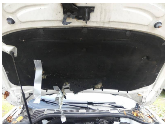
Bild 15: Karosserie / Motordämmmatte gerissen
