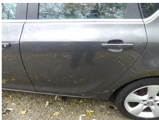
Bild 35: Karosserie / Tür hinten links Kratzer+Delle
