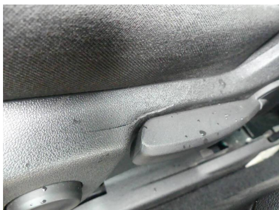
Bild 45: Innenraum / Verkleidung Fahrersitz gebrochen
