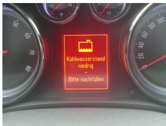
Bild 30: Wartung-Pflege / Kühlwasserstand zu gering
