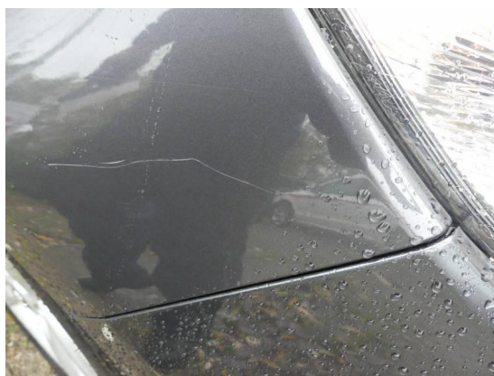
Bild 6: Karosserie / Kotflügel vorne rechts Kratzer+Delle
