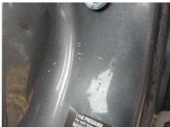
Bild 43: Karosserie / Einstieg vorne links Kratzer+Delle
