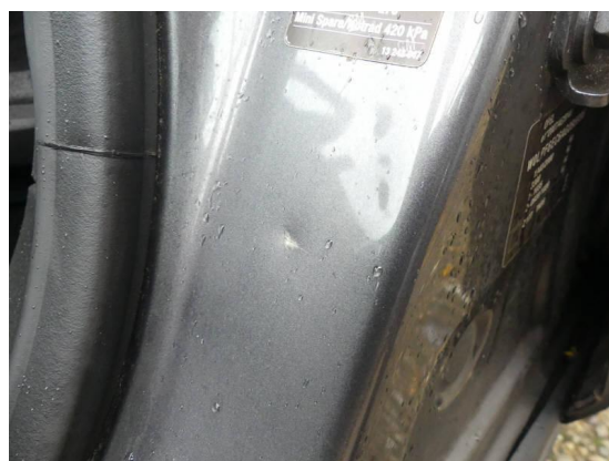
Bild 42: Karosserie / Einstieg vorne links Kratzer+Delle
