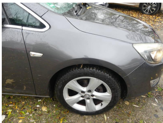
Bild 5: Karosserie / Kotflügel vorne rechts Kratzer+Delle
