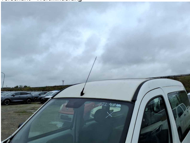
Beschädigung #15: Fahrzeugdach: Antennenstab - beschädigt - erneuern
