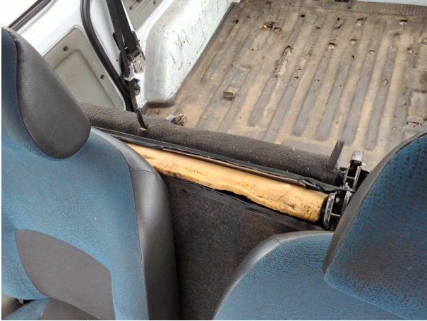
Beschädigung #17: Sitz hinten: Lehnensbezug - beschädigt - erneuern
