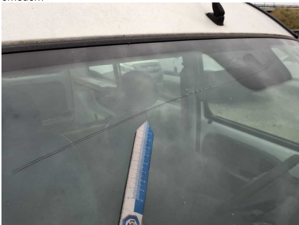
Beschädigung #4: Verglasung: Frontscheibe (Mit Rißbildung) - Steinschlag - erneuern
