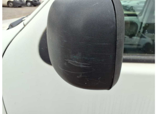
Beschädigung #14: Außenspiegel links: Abdeckkappe - verkratzt / verschürft - Wertminderung
