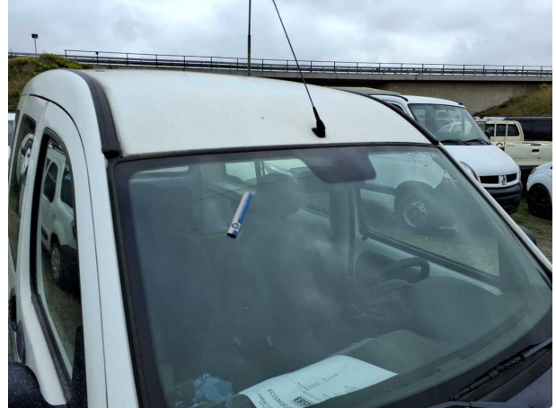
Beschädigung #4: Verglasung: Frontscheibe (Mit Rißbildung... Steinschlag - erneuern
