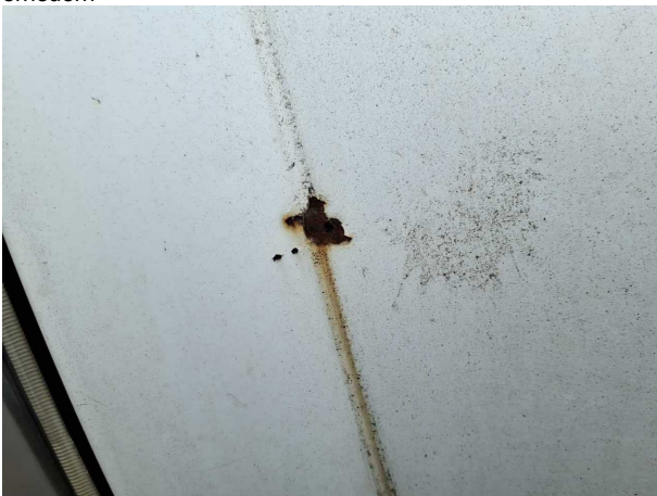
Beschädigung #18: Motorhaube: Motorhaube (Rostbildung) - Lackmangel - instandsetzen und lackieren
