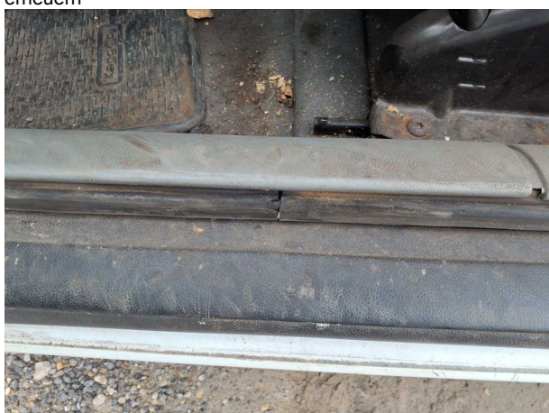
Beschädigung #2: Tür vorn links: Türdichtung - beschädigt - erneuern
