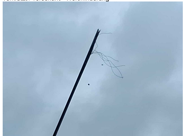
Beschädigung #15: Fahrzeugdach: Antennenstab - beschädigt - erneuern
