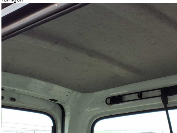
Beschädigung #8: Verkleidungen/Abdeckungen: Dachhimmel - verschmutzt - reinigen
