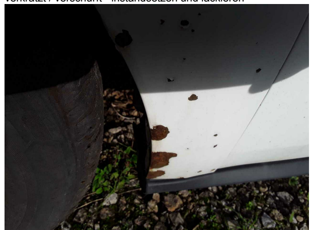
Beschädigung #16: Kotflügel links: Kotflügel links - Korrosio... erneuern
