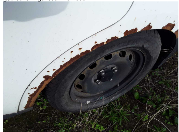
Beschädigung #23: Seitenwand links: Seitenwand - Korrosion - instandsetzen und lackieren
