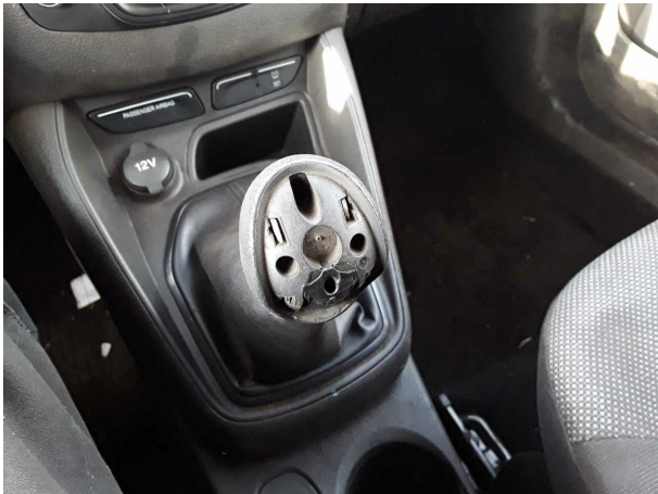
Beschädigung #1: Getriebe: Schaltknauf - beschädigt - erneuern
