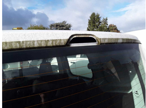
Beschädigung #25: Heckleuchte: Zusatzbremsleuchte - fehlt - erneuern
