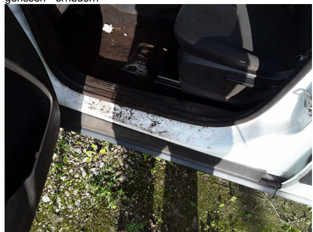
Beschädigung #11: Schweller links: Einstieg - verkratzt / verschürft - lackieren
