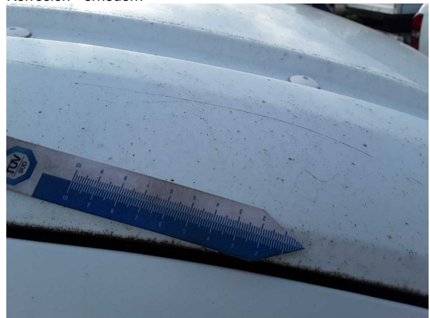
Beschädigung #18: Fahrzeugdach: Dachholm rechts - Kratzer - lackieren
