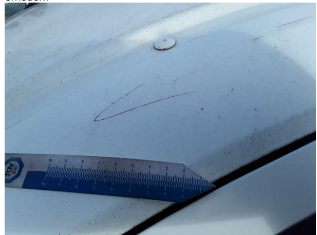
Beschädigung #29: Fahrzeugdach: Dachholm links - Kratzer - lackieren
