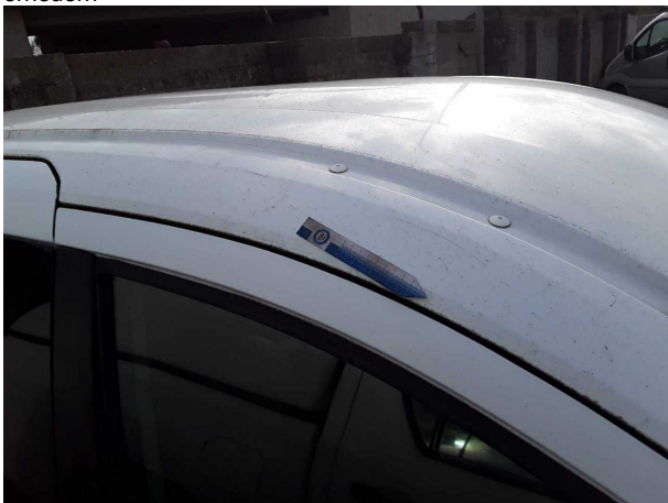
Beschädigung #18: Fahrzeugdach: Dachholm rechts - Kratzer - lackieren
