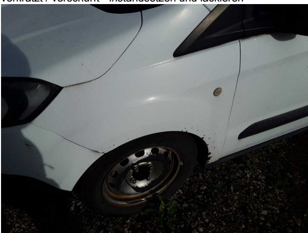
Beschädigung #16: Kotflügel links: Kotflügel links - Korrosion - erneuern
