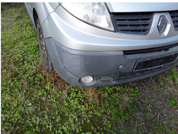
Beschädigung #14: Stossfänger vorn: Stossfänger vorn - beschädigt - erneuern
