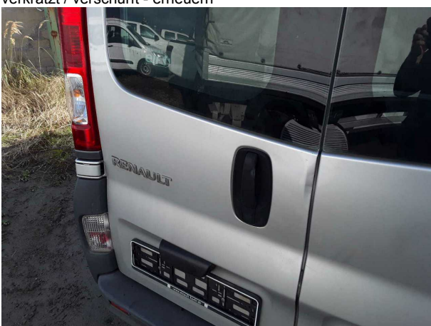
Beschädigung #8: Heckklappe/-tür: Hecktür links - verformt - erneuern
