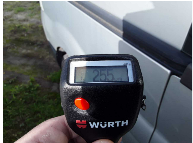
Nachlackierung 1: Seitenwand rechts, Tür hinten rechts
