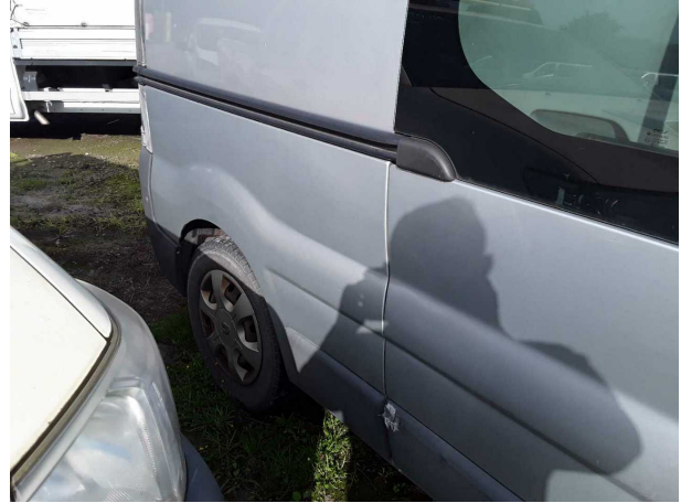
Beschädigung #9: Seitenwand rechts: Seitenwand - Kratzer - lackieren
