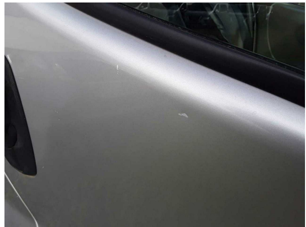
Beschädigung #13: Tür vorn rechts: Tür - Kratzer - lackieren
