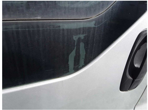
Beschädigung #11: Verglasung: Seitenscheibe hinten rechts - Lackmangel - erneuern
