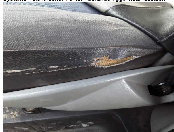
Beschädigung #2: Sitz vorn: Sitzbezug links - gebrochen / gerissen - erneuern
