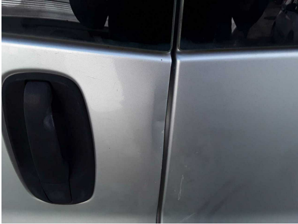
Beschädigung #8: Heckklappe/-tür: Hecktür links - verformt - erneuern
