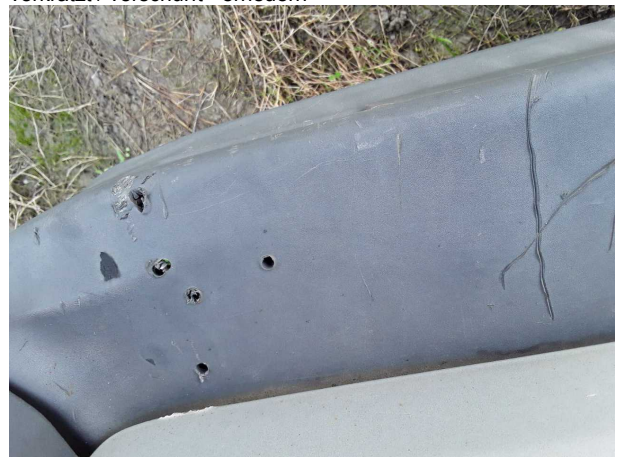
Beschädigung #6: Stossfänger hinten: Stossfänger hinten - verkratzt / verschürft - erneuern
