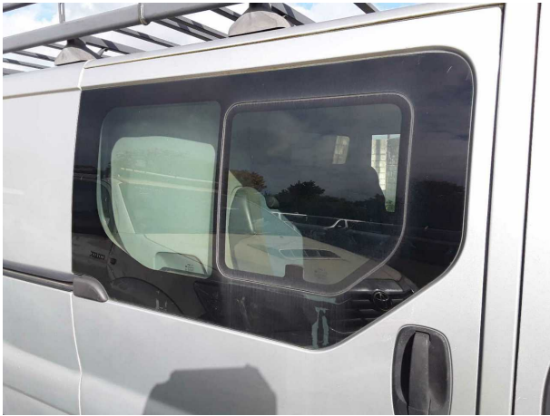
Beschädigung #11: Verglasung: Seitenscheibe hinten rechts - Lackmangel - erneuern
