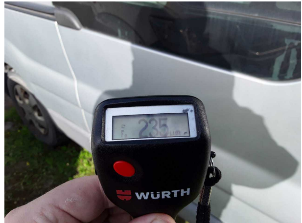
Nachlackierung 1: Seitenwand rechts, Tür hinten rechts
