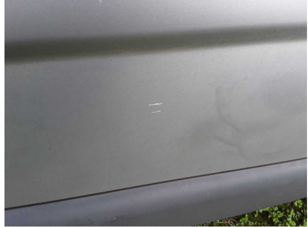
Beschädigung #13: Tür vorn rechts: Tür - Kratzer - lackieren
