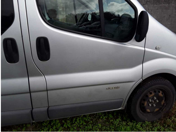
Beschädigung #13: Tür vorn rechts: Tür - Kratzer - lackieren
