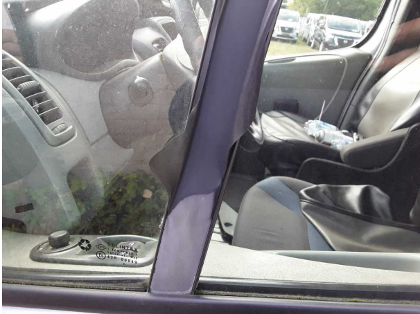
Beschädigung #18: Tür vorn links: Zierleiste oben - Lackmangel - erneuern
