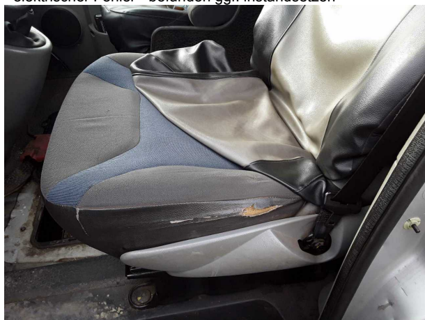
Beschädigung #2: Sitz vorn: Sitzbezug links - gebrochen / gerissen - erneuern
