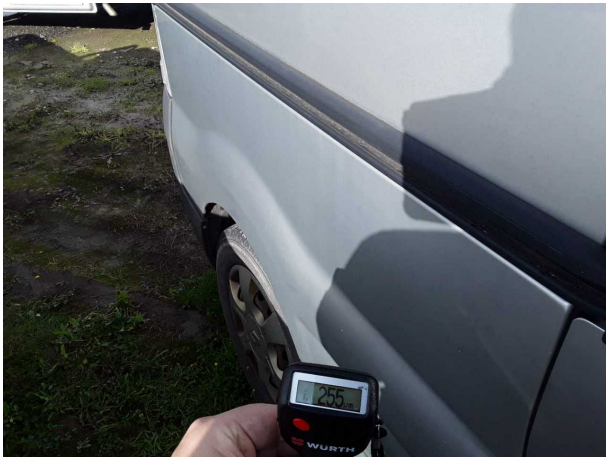
Nachlackierung 1: Seitenwand rechts, Tür hinten rechts
