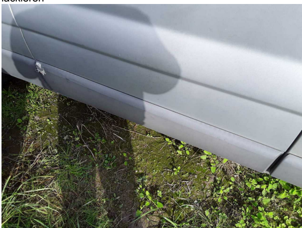
Beschädigung #10: Tür hinten rechts: Zierleiste unten - gebrochen / gerissen - erneuern
