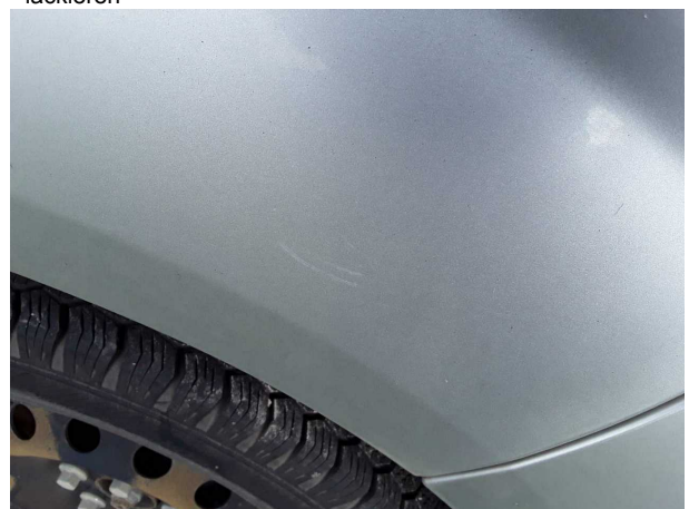
Beschädigung #12: Kotflügel rechts: Kotflügel rechts - Kratzer - lackieren
