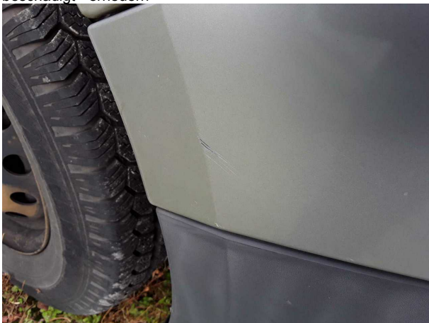
Beschädigung #15: Stossfänger vorn: Stossfänger vorn - Kratzer - lackieren
