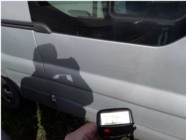
Nachlackierung 1: Seitenwand rechts, Tür hinten rechts
