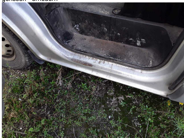
Beschädigung #3: Schweller links: Einstieg - Korrosion - instandsetzen und lackieren
