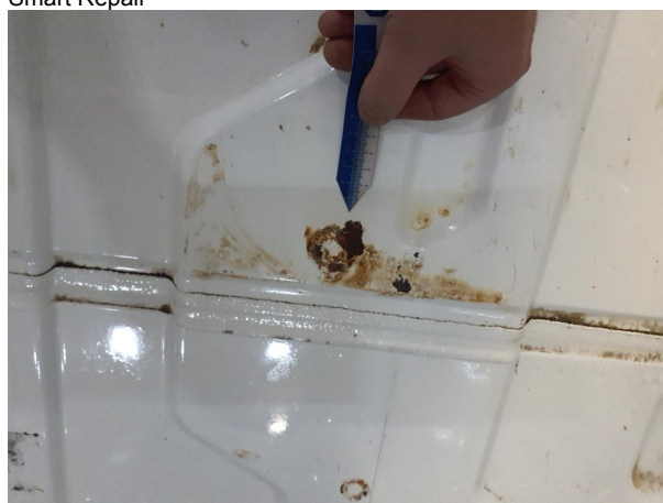
Beschädigung 13: Interieur: Laderaumboden - Korrosion - Smart Repair
