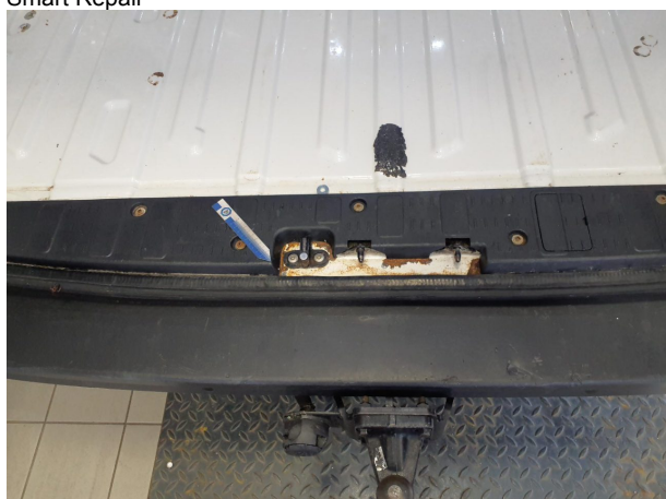
Beschädigung 13: Interieur: Laderaumboden - Korrosion - Smart Repair
