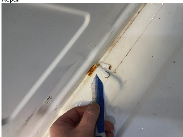
Beschädigung 13: Interieur: Laderaumboden - Korrosion - Smart Repair
