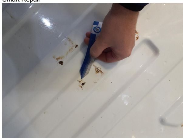
Beschädigung 13: Interieur: Laderaumboden - Korrosion - Smart Repair
