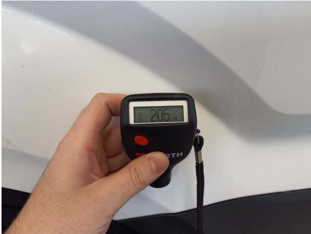
Nachlackierung 1: Seitenwand rechts
