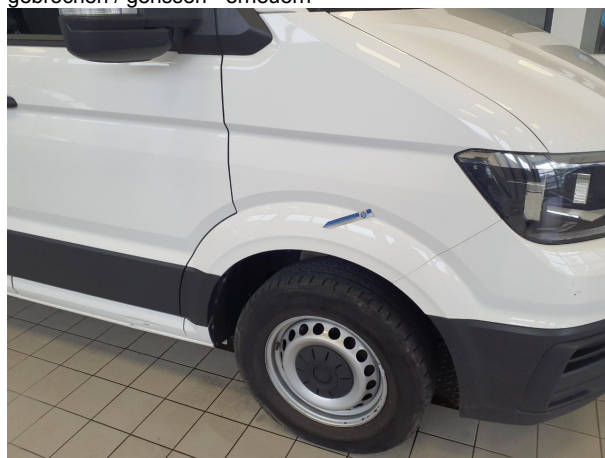
Beschädigung 3: Kotflügel rechts: Kotflügel rechts - Delle(n) - Smart Repair
