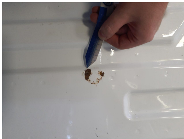
Beschädigung 13: Interieur: Laderaumboden - Korrosion - Smart Repair
