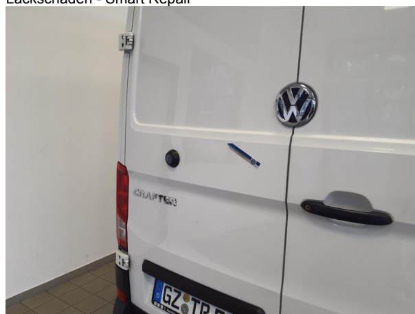
Beschädigung 12: Heckklappe/-tür: Hecktür links - Delle(n) - Smart Repair
