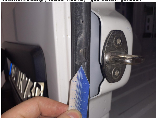
Beschädigung 2: Tür hinten links: Türdichtung (Hecktür) - gebrochen / gerissen - erneuern
