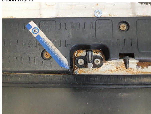
Beschädigung 13: Interieur: Laderaumboden - Korrosion - Smart Repair
