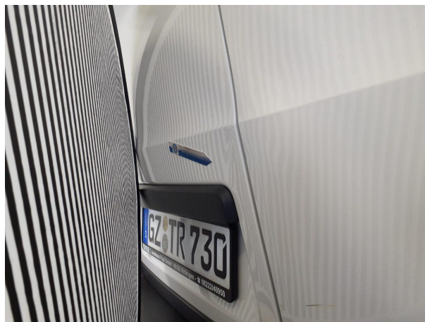
Beschädigung 12: Heckklappe/-tür: Hecktür links - Delle(n) - Smart Repair
