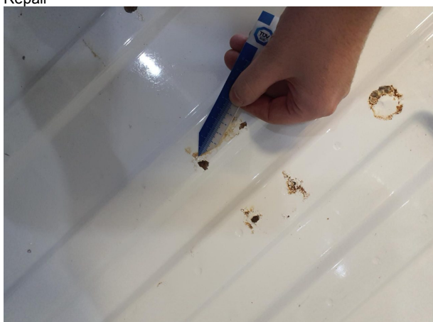
Beschädigung 13: Interieur: Laderaumboden - Korrosion - Smart Repair
