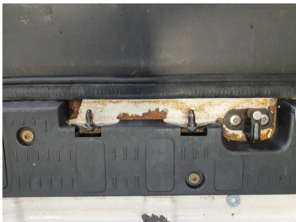
Beschädigung 13: Interieur: Laderaumboden - Korrosion - Smart Repair
