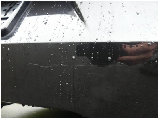
Bild 27: Karosserie / Stoßfänger hinten Kratzer
