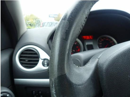
Bild 37: Innenraum / Lenkrad abgenutzt
