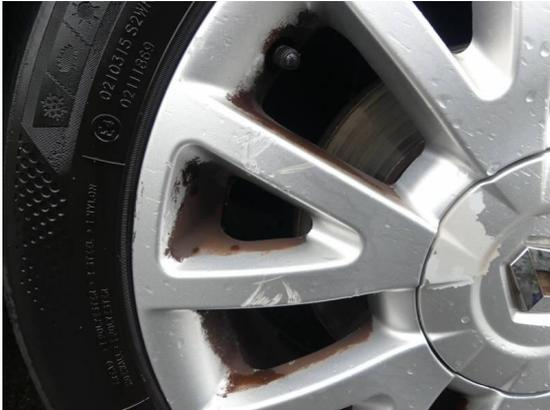
Bild 55: Reifen - Felge / Felgen Kratzer
