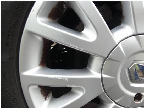
Bild 57: Reifen - Felge / Felgen Kratzer
