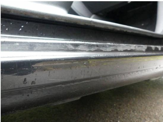
Bild 17: Karosserie / Schweller vorne rechts Kratzer
