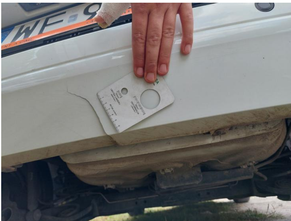
Fot. 41. Spojler zderzaka tylnego - Pęknięcie/rozerwanie 1
