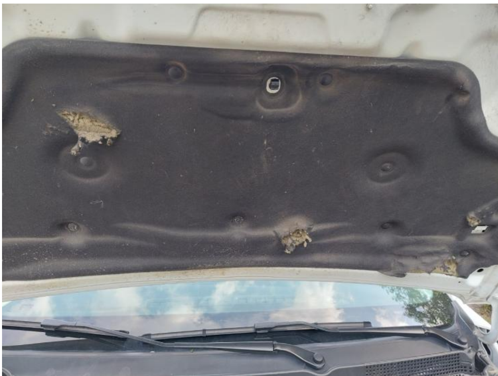
Fot. 36. Wykładzina pokrywy komory silnika - Pęknięcie/rozerwanie 1
