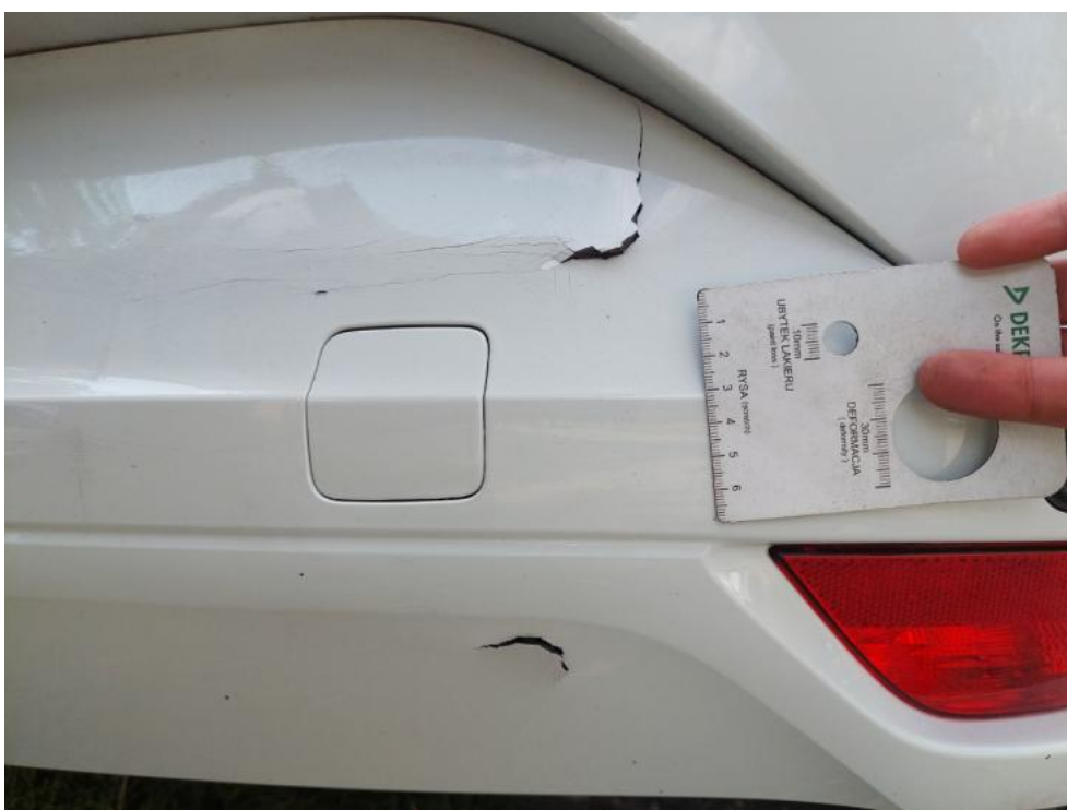
Fot. 42. Spojler zderzaka tylnego - Pęknięcie/rozerwanie 2
