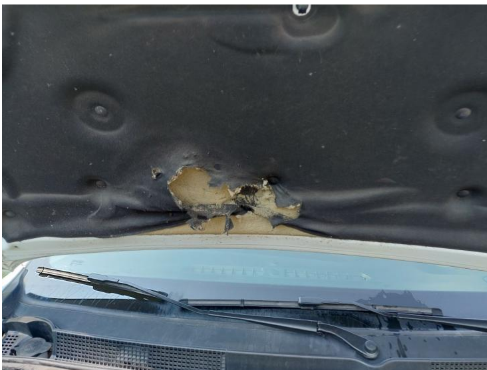
Fot. 36. Wykładzina pokrywy komory silnika - Inne 1
