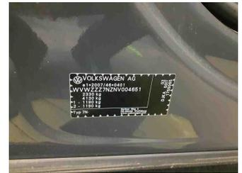
Fahrzeug - Typenschild/Fahrgestellnummer
