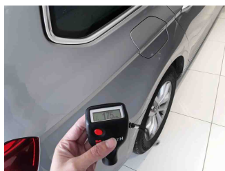
Lackstärke Seitenwand hinten rechts
