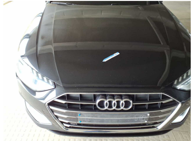
Beschädigung #4: Motorhaube: Motorhaube - Steinschlag - instandsetzen und lackieren
