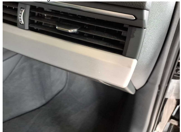
Beschädigung #3: Instrumententafel: Instrumententafel - Kratzer
