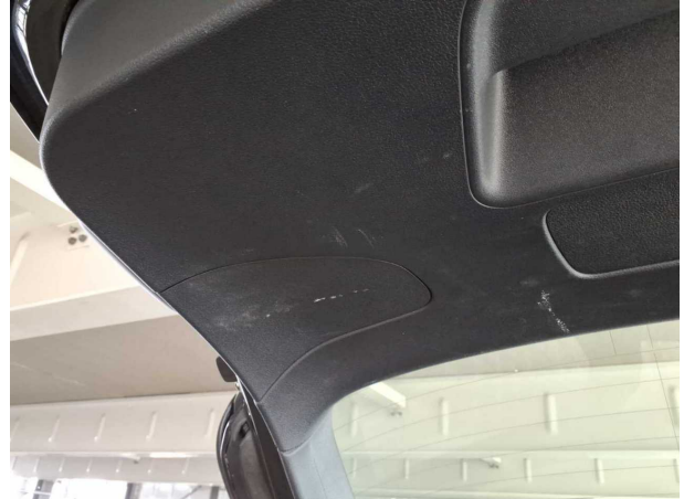
Beschädigung #1: Verkleidungen/Abdeckungen: Heckdeckel, Innenverkleidung - Kratzer
