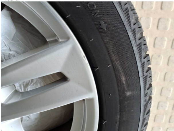
Beschädigung #13: 2.Radsatz: 2 Leichtmetallfelgen - verkratzt / verschürft - Smart Repair
