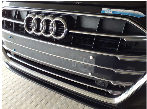
Beschädigung #7: Stossfänger vorn: Grill - Steinschlag
