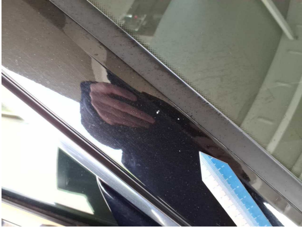
Beschädigung #23: Karosserie: A-Säule rechts - Steinschlag
