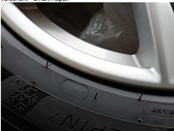
Beschädigung #14: 2.Radsatz: 1 Leichtmetallfelge - Kratzer
