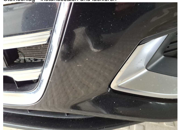
Beschädigung #5: Stossfänger vorn: Stossfänger vorn - Steinschlag - instandsetzen und lackieren
