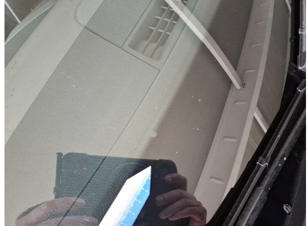
Beschädigung #10: Verglasung: Frontscheibe - Steinschlag
