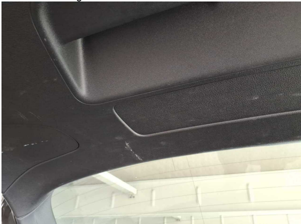
Beschädigung #1: Verkleidungen/Abdeckungen: Heckdeckel, Innenverkleidung - Kratzer
