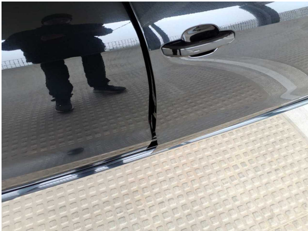
Beschädigung #22: Tür vorn rechts: Türkante - Kratzer
