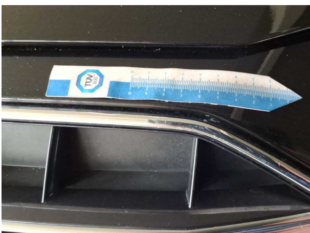
Beschädigung #7: Stossfänger vorn: Grill - Steinschlag
