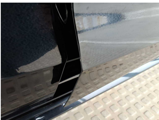
Beschädigung #22: Tür vorn rechts: Türkante - Kratzer
