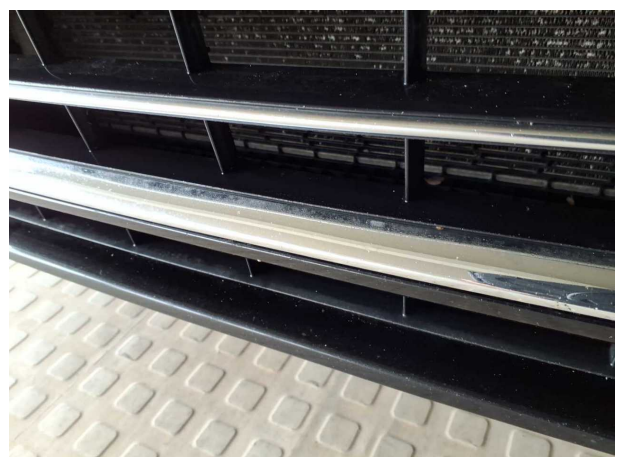
Beschädigung #7: Stossfänger vorn: Grill - Steinschlag
