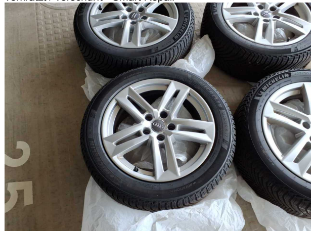
Beschädigung #14: 2.Radsatz: 1 Leichtmetallfelge - Kratzer
