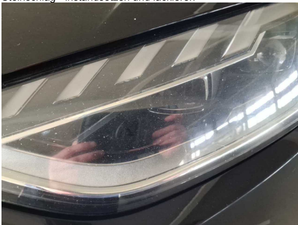
Beschädigung #6: Scheinwerfer: Scheinwerfer links - Steinschlag
