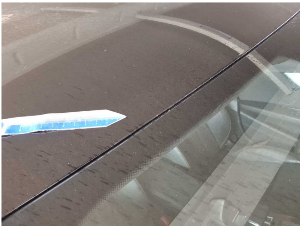
Beschädigung #24: Fahrzeugdach: Dach - Steinschlag
