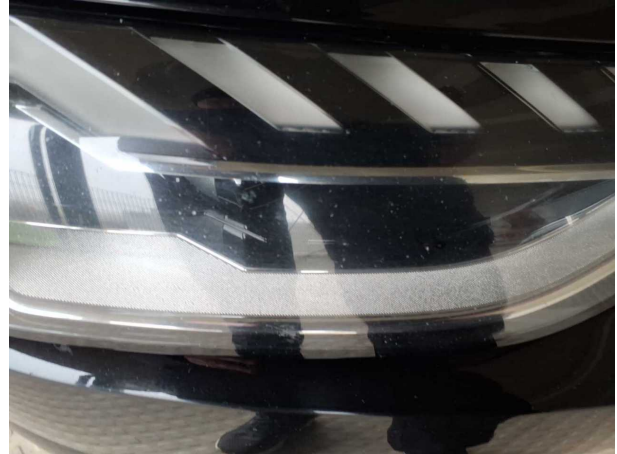
Beschädigung #8: Scheinwerfer: Scheinwerfer rechts - Steinschlag
