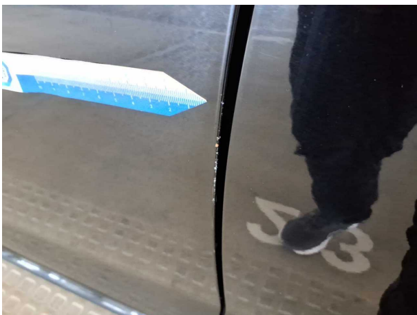
Beschädigung #16: Tür vorn links: Türkante - Kratzer
