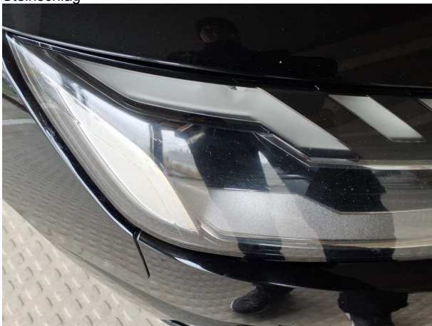
Beschädigung #8: Scheinwerfer: Scheinwerfer rechts - Steinschlag
