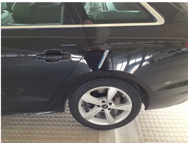
Beschädigung #19: Seitenwand links: Seitenwand - Kratzer
