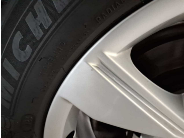
Beschädigung #12: Rad/Reifen: Leichtmetallfelge hinten links - Kratzer
