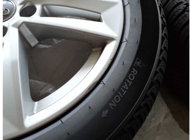
Beschädigung #13: 2.Radsatz: 2 Leichtmetallfelgen - verkratzt / verschürft - Smart Repair
