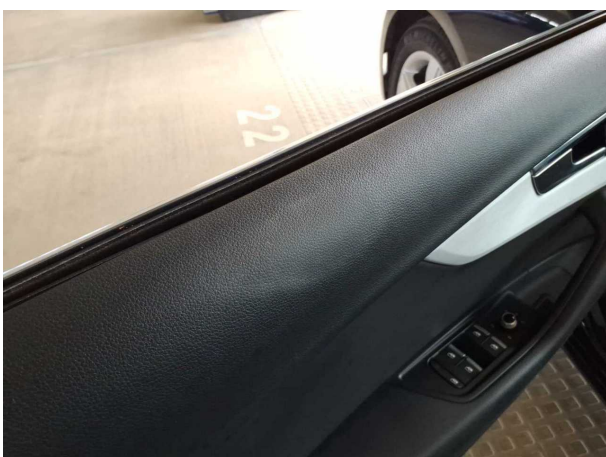
Beschädigung #17: Verkleidungen/Abdeckungen: Türverkleidung vorn links - Abrieb - Smart Repair
