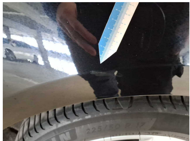
Beschädigung #19: Seitenwand links: Seitenwand - Kratzer
