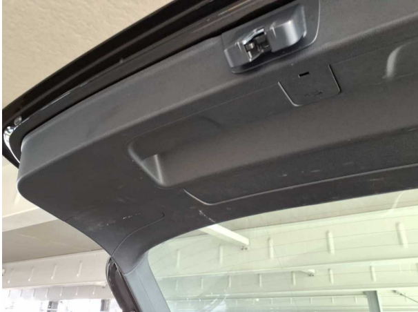
Beschädigung #1: Verkleidungen/Abdeckungen: Heckdeckel, Innenverkleidung - Kratzer
