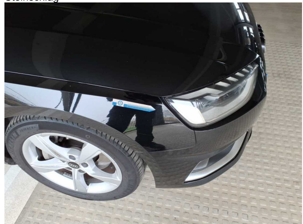
Beschädigung #9: Kotflügel rechts: Kotflügel rechts - Steinschlag - instandsetzen und lackieren
