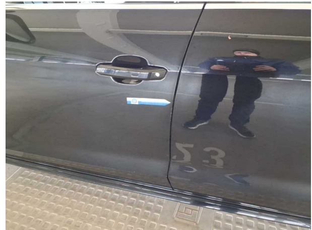
Beschädigung #16: Tür vorn links: Türkante - Kratzer
