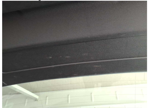
Beschädigung #1: Verkleidungen/Abdeckungen: Heckdeckel, Innenverkleidung - Kratzer
