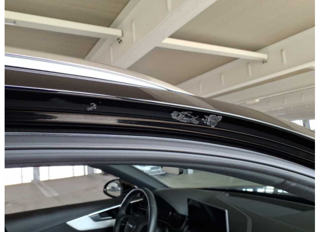
Beschädigung #21: Fahrzeugdach: Dachholm rechts - bekle... beschriftet - entkleben/neutralisieren
