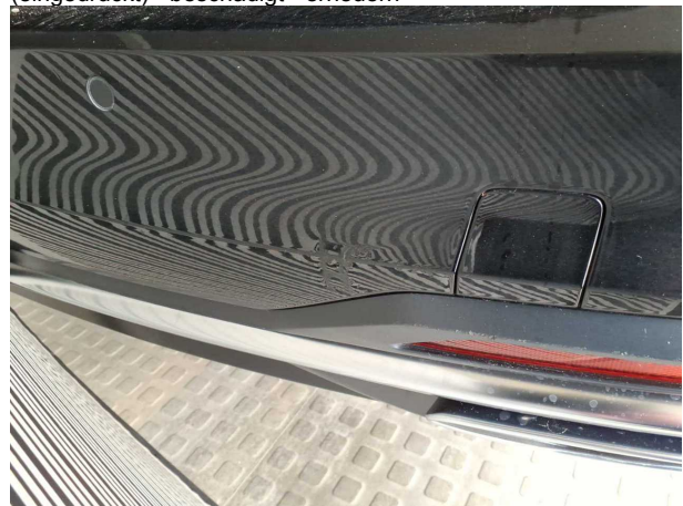
Beschädigung #20: Stossfänger hinten: Stossfänger hinten (eingedrückt) - beschädigt - erneuern
