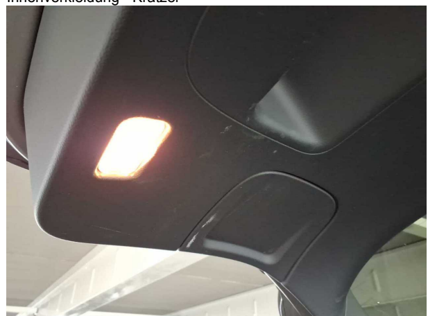
Beschädigung #3: Verkleidungen/Abdeckungen: Heckdeckel, Innenverkleidung - Kratzer
