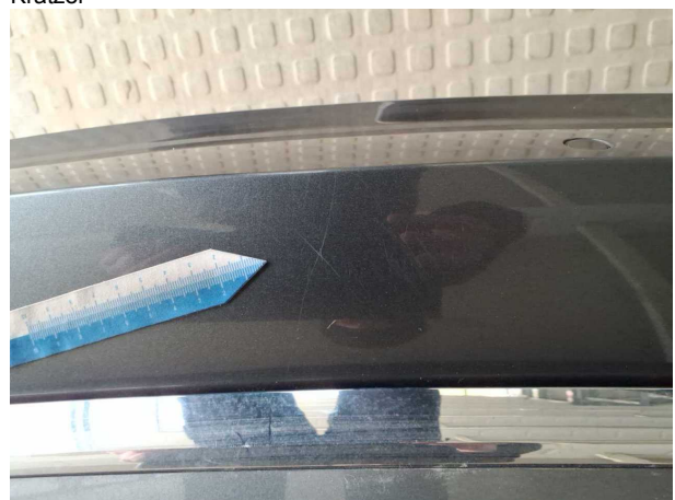
Beschädigung #16: Stossfänger hinten: Stossfänger hinten - Kratzer
