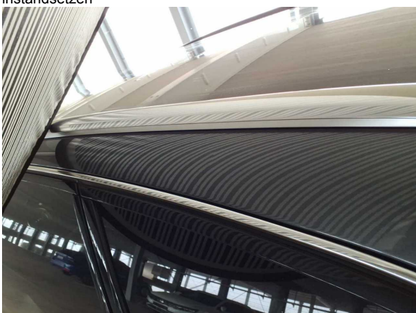
Beschädigung #17: Karosserie: Karosserie - Hagelschaden - sa... instandsetzen
