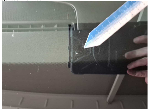
Beschädigung #9: Verglasung: Frontscheibe - gebrochen / gerissen - erneuern
