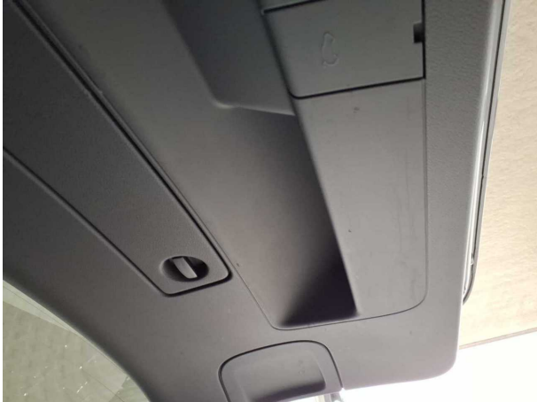
Beschädigung #3: Verkleidungen/Abdeckungen: Heckdeckel, Innenverkleidung - Kratzer
