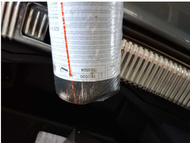
Beschädigung #2: Ausrüstung: Tirefit Füllmittel - abgelaufen - erneuern
