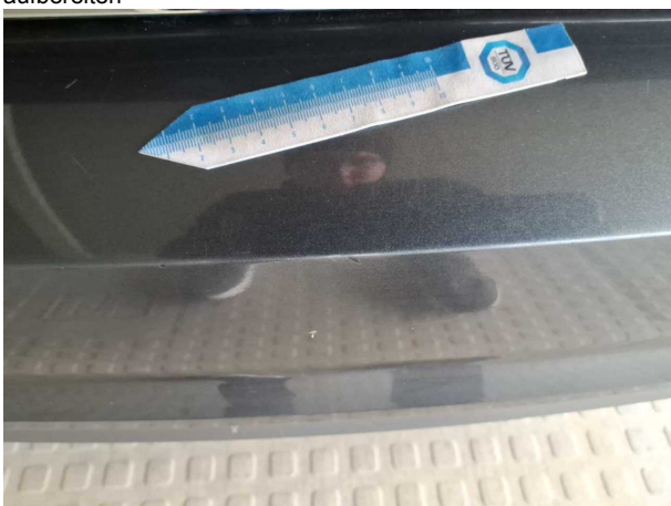
Beschädigung #16: Stossfänger hinten: Stossfänger hinten - Kratzer
