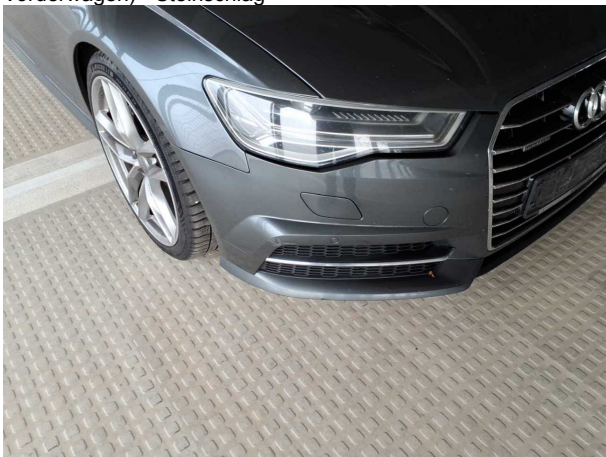
Beschädigung #11: Stossfänger vorn: Stossfänger vorn (eingedrückt) - beschädigt - erneuern
