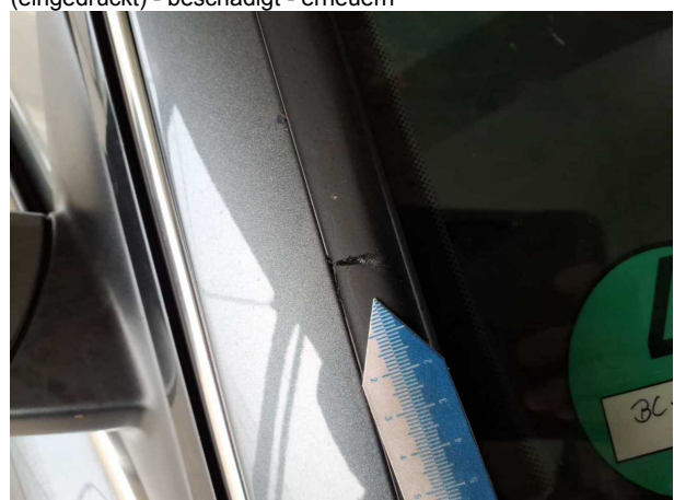
Beschädigung #12: Verglasung: Frontscheibe (Windabweiser rechts) - Kratzer - erneuern
