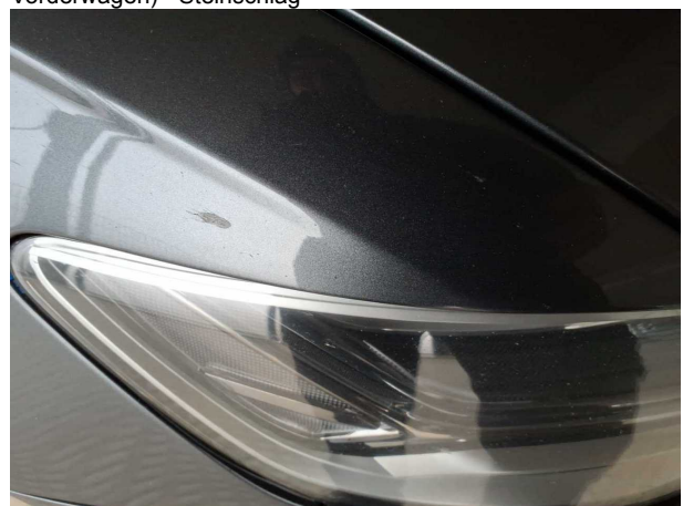
Beschädigung #10: Motorhaube: Motorhaube (Kompletter Vorderwagen) - Steinschlag
