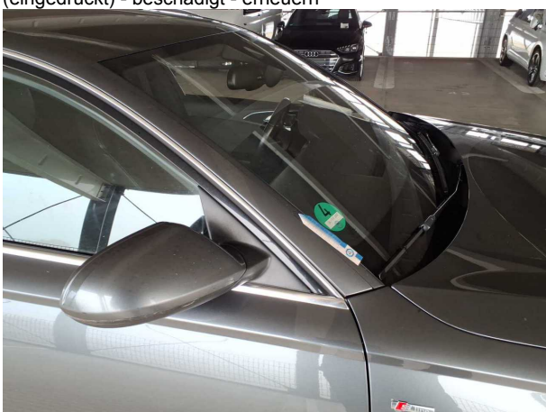
Beschädigung #12: Verglasung: Frontscheibe (Windabweiser rechts) - Kratzer - erneuern
