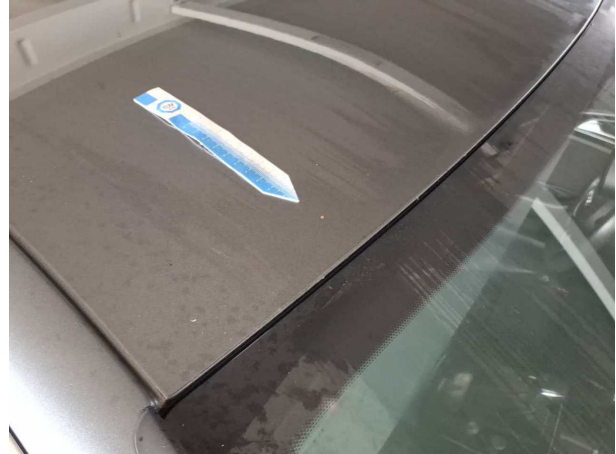
Beschädigung #13: Fahrzeugdach: Dach (Dachkante vorne) - Steinschlag - Smart Repair
