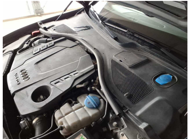
Beschädigung #1: Karosserie: Stirnwandverkleidung (Dichtung) - lose - erneuern
