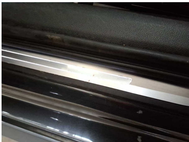
Beschädigung #18: Verkleidungen/Abdeckungen: Einstieg vorn links - Kratzer
