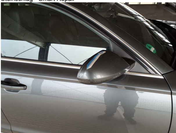
Beschädigung #14: Außenspiegel rechts: Abdeckkappe - Kratzer - instandsetzen und lackieren
