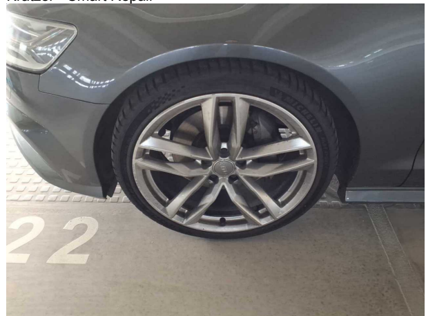
Beschädigung #8: Rad/Reifen: Leichtmetallfelge vorn links - verkratzt / verschürft - Smart Repair
