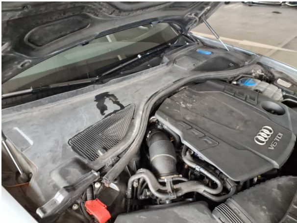
Beschädigung #1: Karosserie: Stirnwandverkleidung (Dichtung) - lose - erneuern
