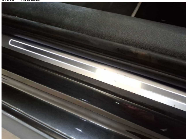
Beschädigung #18: Verkleidungen/Abdeckungen: Einstieg vorn links - Kratzer
