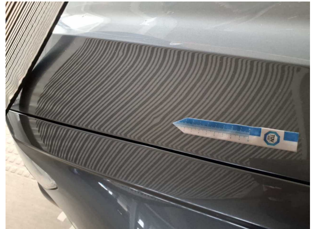
Beschädigung #17: Karosserie: Karosserie - Hagelschaden - sanft instandsetzen
