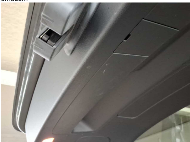
Beschädigung #3: Verkleidungen/Abdeckungen: Heckdeckel, Innenverkleidung - Kratzer
