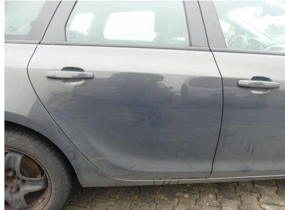
Bild 14: Karosserie / Tür hinten rechts Kratzer
