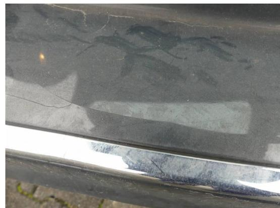
Bild 24: Karosserie / Stoßfänger hinten Kratzer+gerissen
