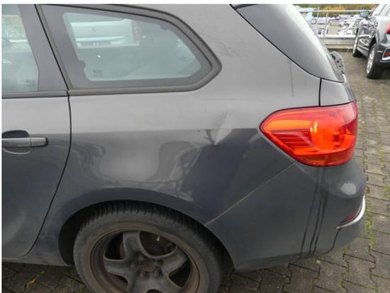
Bild 27: Karosserie / Fondseite links leicht deformiert
