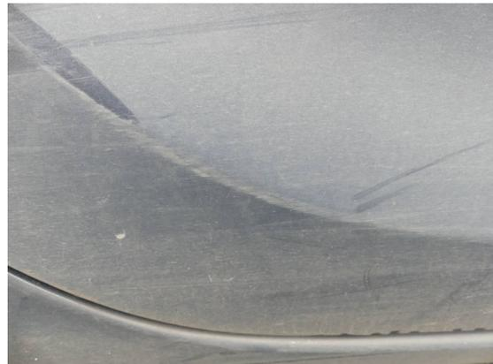
Bild 16: Karosserie / Tür hinten rechts Kratzer
