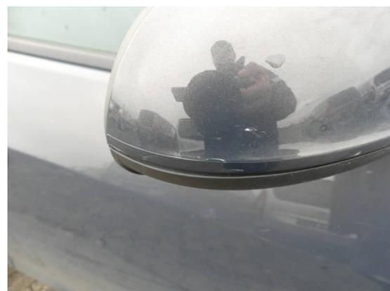
Bild 42: Karosserie / Außenspiegelkappe rechts Kratzer
