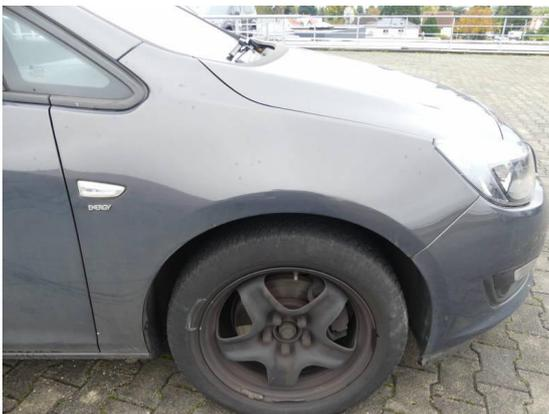
Bild 39: Karosserie / Kotflügel vorne rechts leicht deformiert
