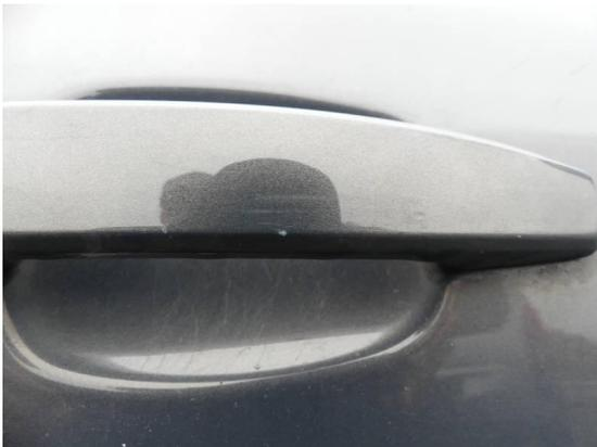
Bild 9: Karosserie / Tür Kratzer+leicht deformiert
