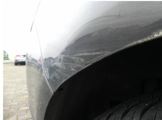
Bild 22: Karosserie / Fondseite rechts Kratzer+Deformiert
