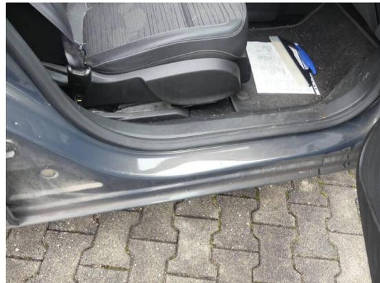
Bild 10: Karosserie / Einstieg vorne rechts Kratzer+Delle
