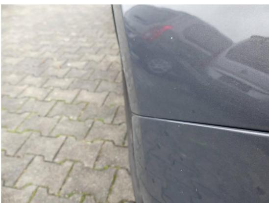
Bild 41: Karosserie / Kotflügel vorne rechts leicht deformiert
