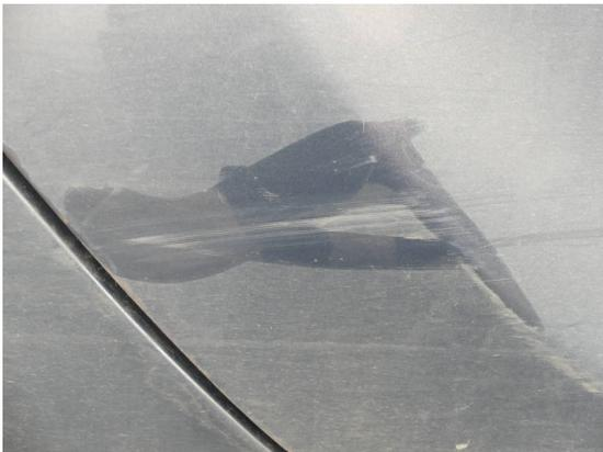
Bild 15: Karosserie / Tür hinten rechts Kratzer
