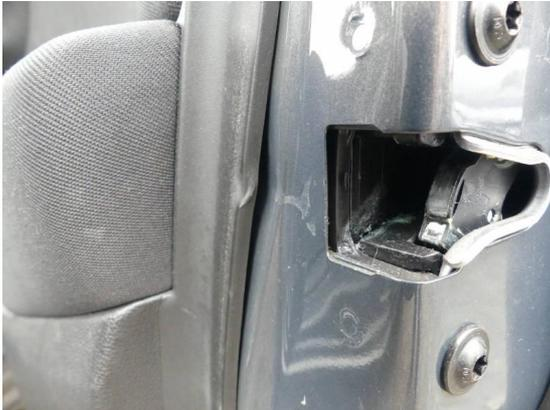
Bild 13: Karosserie / Tür Kratzer+leicht deformiert
