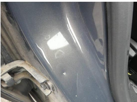
Bild 11: Karosserie / Einstieg vorne rechts Kratzer+Delle
