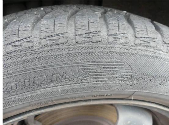
Bild 44: Reifen - Felge / Reifen vorne und hinten rechts beschädigt/verschlissen
