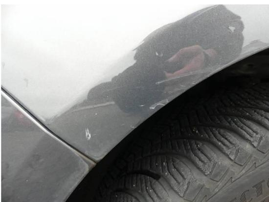
Bild 35: Karosserie / Kotflügel Kratzer
