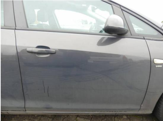
Bild 7: Karosserie / Tür Kratzer+leicht deformiert
