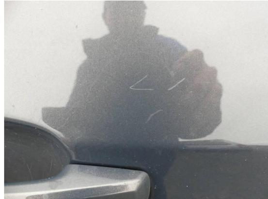
Bild 8: Karosserie / Tür Kratzer+leicht deformiert
