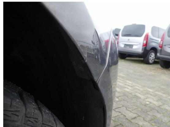
Bild 40: Karosserie / Kotflügel vorne rechts leicht deformiert
