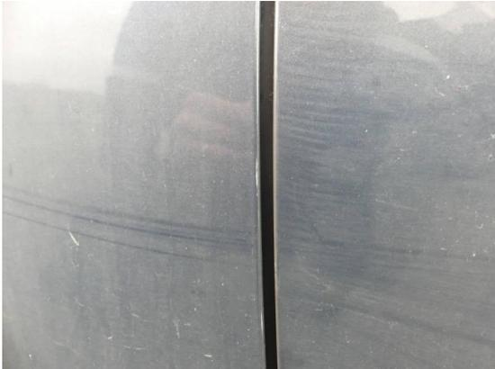
Bild 31: Karosserie / Tür vorne links Kratzer+leicht deformiert
