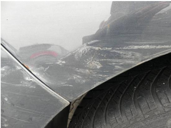
Bild 21: Karosserie / Fondseite rechts Kratzer+Deformiert
