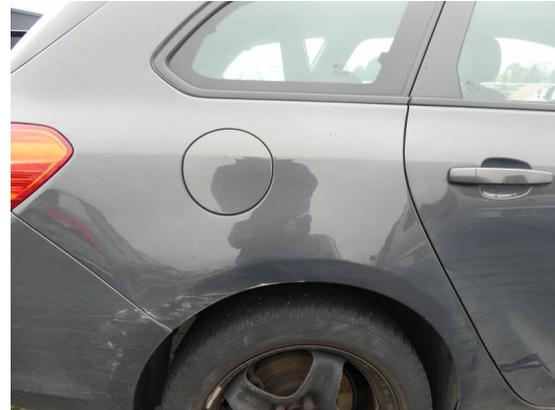
Bild 20: Karosserie / Fondseite rechts Kratzer+Deformiert
