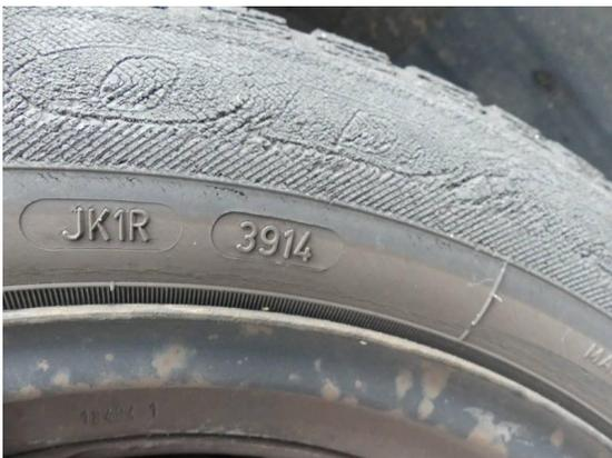
Bild 45: Reifen - Felge / Reifen vorne und hinten rechts beschädigt/verschlissen
