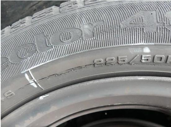
Bild 43: Reifen - Felge / Reifen vorne und hinten rechts beschädigt/verschlissen
