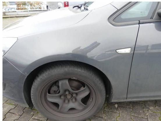
Bild 34: Karosserie / Kotflügel Kratzer
