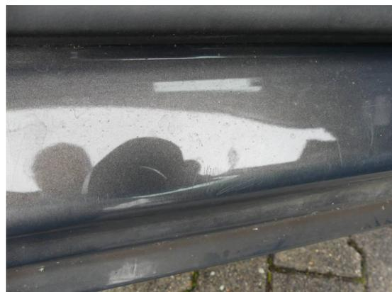
Bild 12: Karosserie / Einstieg vorne rechts Kratzer+Delle
