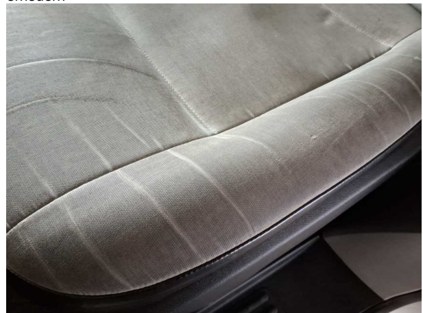
Beschädigung #5: Sitz vorn: Sitzbezug links - beschädigt - erneuern
