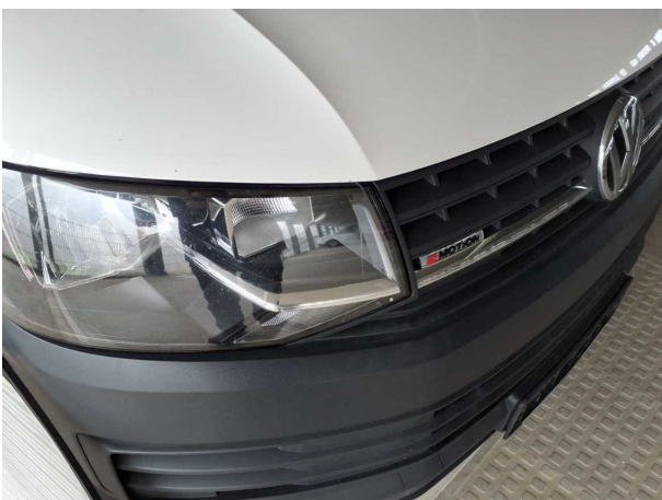
Beschädigung #24: Scheinwerfer: Scheinwerfer rechts - Kratzer - erneuern
