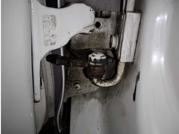
Beschädigung #4: Tür vorn links: Scharnier Satz (Schwergängig) - Funktion / Zulässigkeit - instandsetzen
