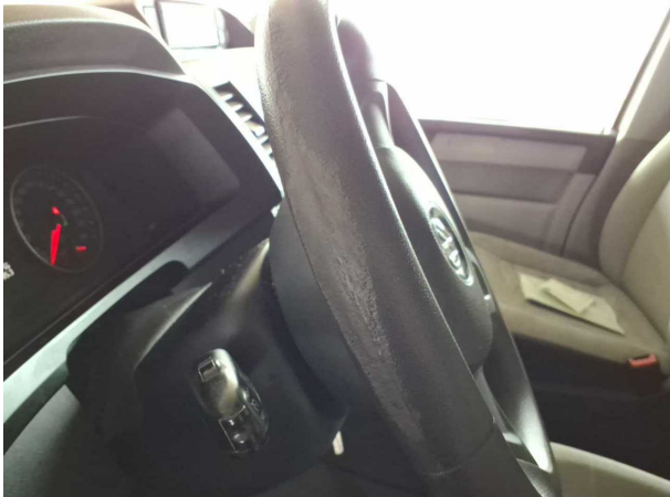
Beschädigung #9: Lenkanlage: Lenkrad - beschädigt - erneuern
