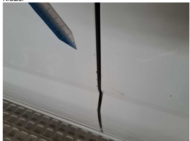
Beschädigung #20: Tür vorn links: Türkante - Kratzer
