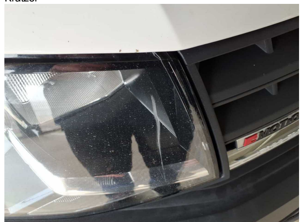
Beschädigung #24: Scheinwerfer: Scheinwerfer rechts - Kratzer - erneuern
