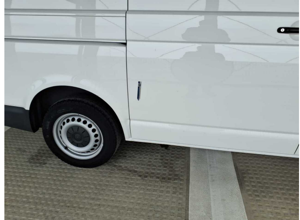
Beschädigung #26: Schiebetür rechts: Schiebetür - Delle / Lackschaden - instandsetzen und lackieren
