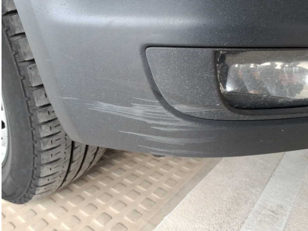
Beschädigung #13: Stossfänger vorn: Stossfänger vorn - verkratzt / verschürft - erneuern
