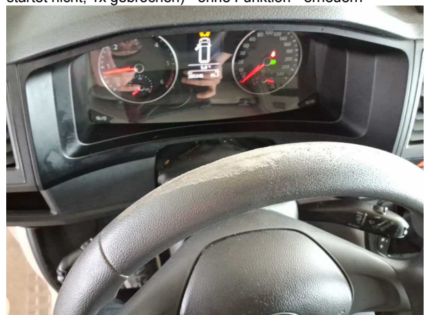
Beschädigung #9: Lenkanlage: Lenkrad - beschädigt - erneuern
