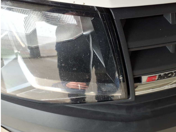
Beschädigung #24: Scheinwerfer: Scheinwerfer rechts - Kratzer - erneuern
