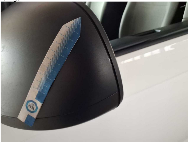
Beschädigung #23: Außenspiegel links: Abdeckkappe - Kratzer
