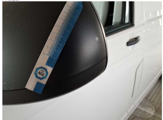
Beschädigung #23: Außenspiegel links: Abdeckkappe - Kratzer
