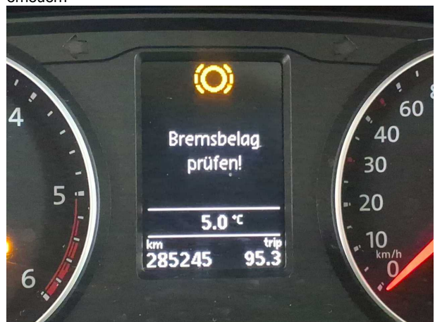
Beschädigung #7: Bremsanlage: Bremsscheiben und Beläge vorn - verschlissen - erneuern
