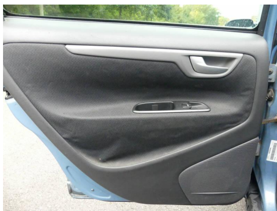
Bild 10: Innenraum / Stoff Türverkleidung löst sich ab
