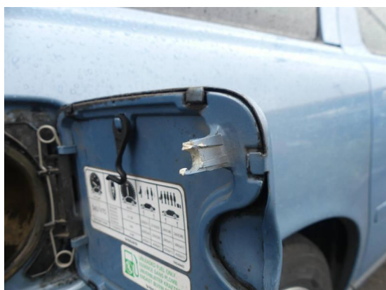
Bild 29: Karosserie / Tankdeckel-Verriegelung + Halteband beschädigt
