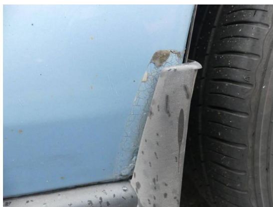
Bild 4: Karosserie / Kotflügel vorne rechts Korrosion
