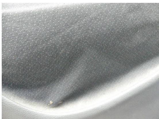
Bild 11: Innenraum / Stoff Türverkleidung löst sich ab
