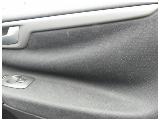
Bild 14: Innenraum / Stoff Türverkleidung löst sich ab
