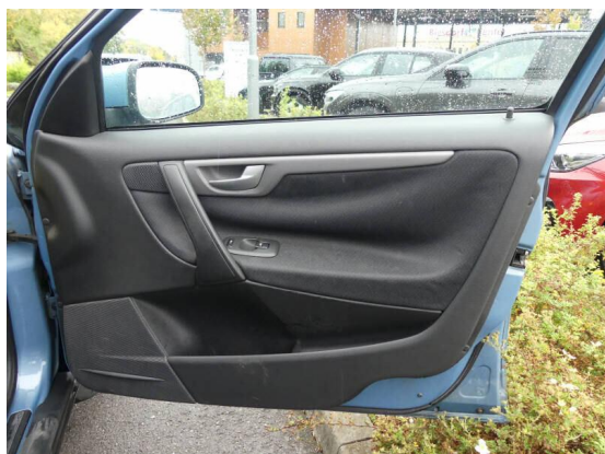
Bild 13: Innenraum / Stoff Türverkleidung löst sich ab
