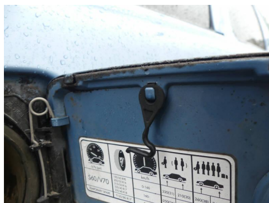
Bild 30: Karosserie / Tankdeckel-Verriegelung + Halteband beschädigt
