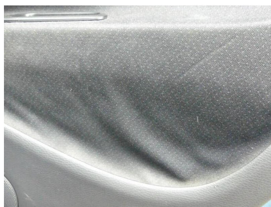
Bild 16: Innenraum / Stoff Türverkleidung löst sich ab
