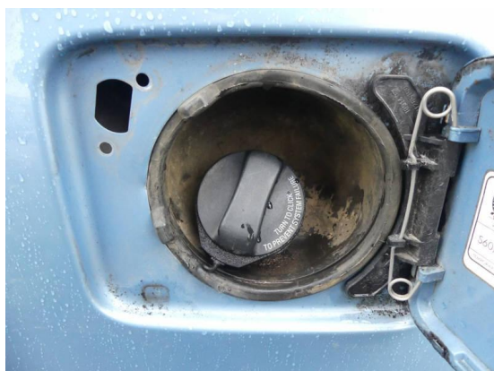
Bild 27: Karosserie / Tankdeckel-Verriegelung + Halteband beschädigt
