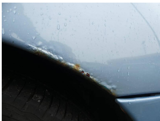
Bild 3: Karosserie / Kotflügel vorne rechts Korrosion
