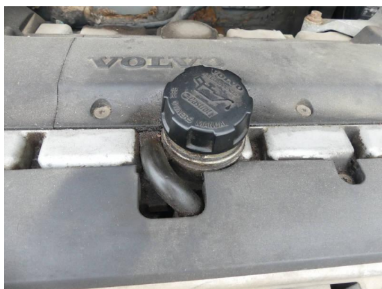
Bild 51: Technik / Motor Ölfeucht
