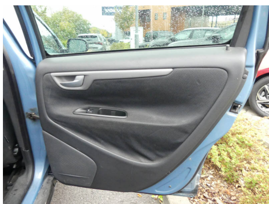
Bild 15: Innenraum / Stoff Türverkleidung löst sich ab
