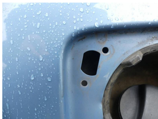
Bild 28: Karosserie / Tankdeckel-Verriegelung + Halteband beschädigt
