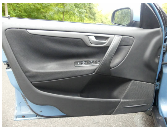
Bild 12: Innenraum / Stoff Türverkleidung löst sich ab
