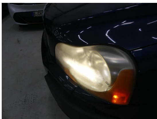
Bild 42: Technik / Scheinwerfer matt/verschlissen
