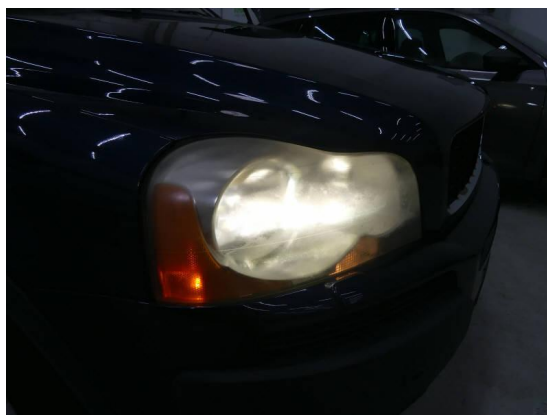
Bild 44: Technik / Scheinwerfer matt/verschlissen
