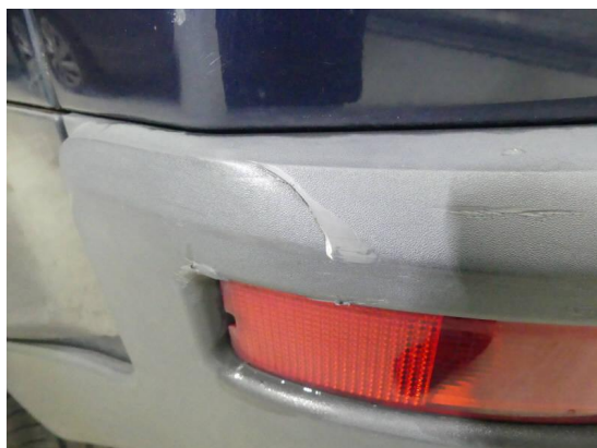
Bild 86: Karosserie / Stoßfänger hinten Kratzer
