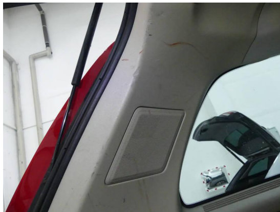
Bild 2: Innenraum / Kofferraumverkleidung gebrochen+kratzer
