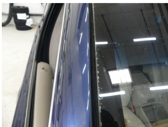
Bild 48: Karosserie / Frontscheibe Schicht-Ablösung
