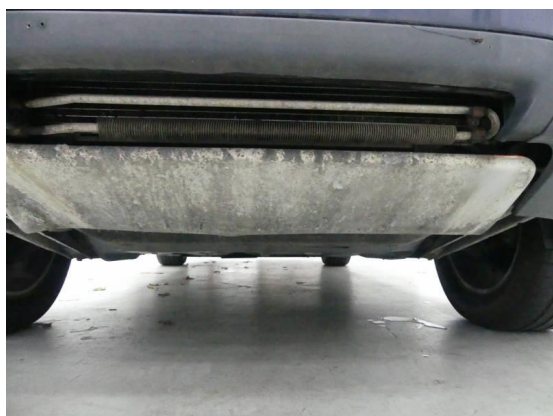
Bild 5: Karosserie / Unterbodenschutz deformiert
