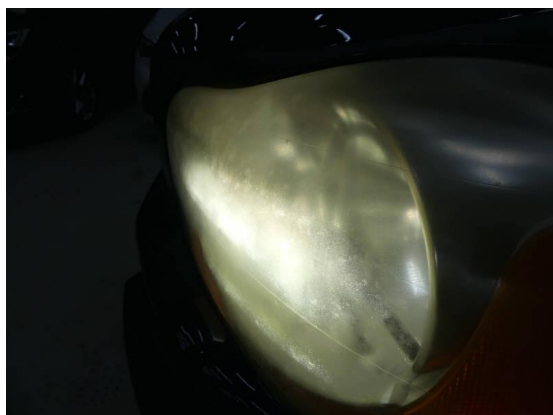
Bild 43: Technik / Scheinwerfer matt/verschlissen
