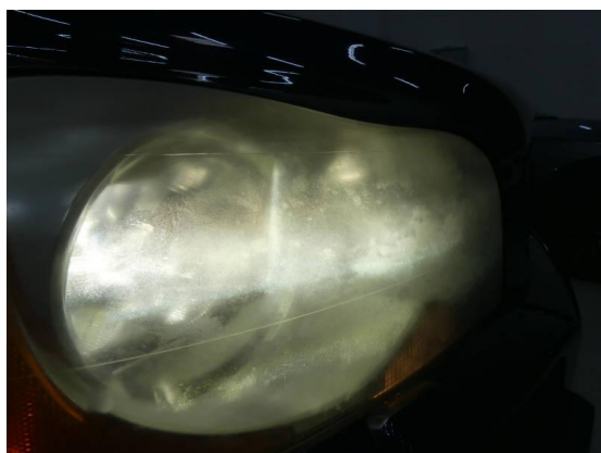
Bild 45: Technik / Scheinwerfer matt/verschlissen
