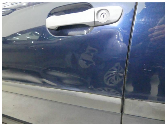
Bild 25: Karosserie / Tür vorne links deformiert
