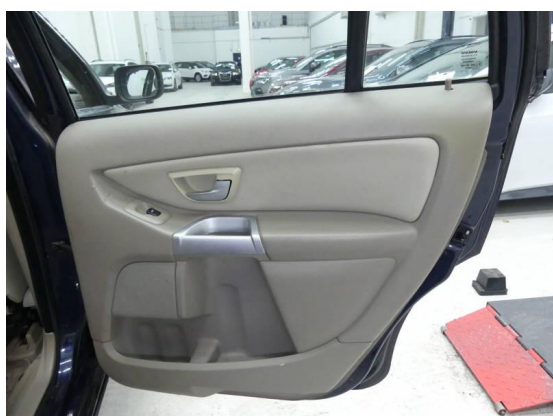
Bild 39: Innenraum / Türverkleidung hinten rechts beschädigt
