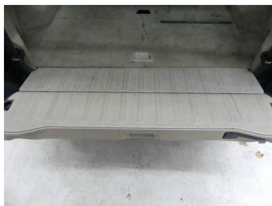
Bild 78: Innenraum / Heckklappenverkleidung gebrochen
