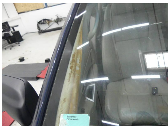
Bild 9: Innenraum / A-Säulenverkleidung eingerissen
