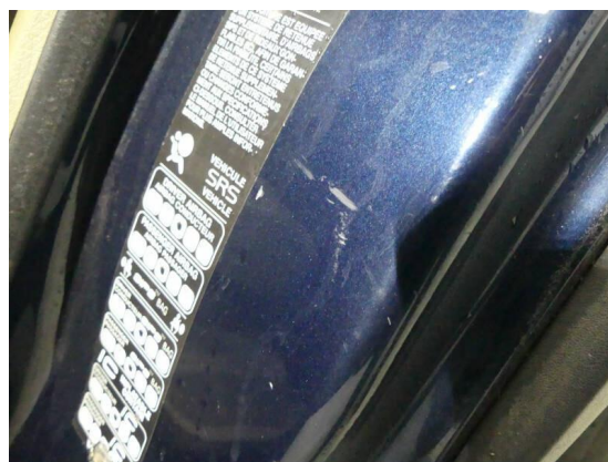
Bild 22: Karosserie / Einstieg hinten links Kratzer
