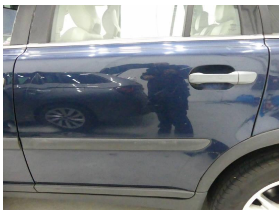
Bild 17: Karosserie / Tür hinten links Kratzer+leicht deformiert
