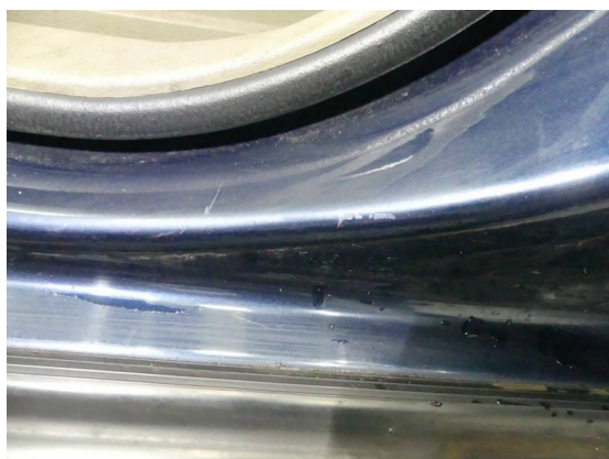
Bild 51: Karosserie / Einstieg vorne links Kratzer+Dellen
