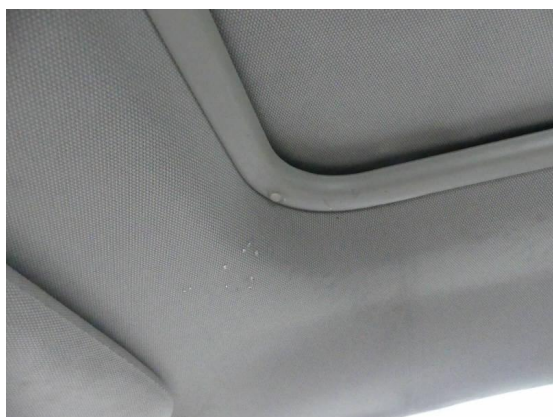
Bild 27: Karosserie / Schiebedach undicht
