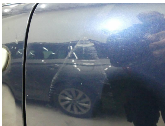
Bild 18: Karosserie / Tür hinten links Kratzer+leicht deformiert
