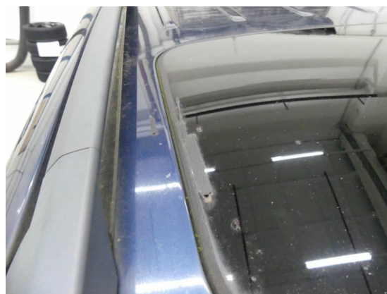
Bild 28: Karosserie / Schiebedach undicht
