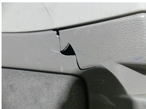
Bild 3: Innenraum / Kofferraumverkleidung gebrochen+kratzer
