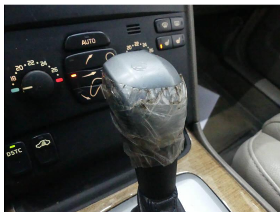
Bild 76: Innenraum / Schaltknauf gebrochen
