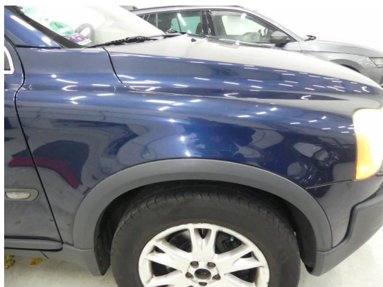
Bild 61: Karosserie / Kotflügel vorne rechts Kratzer+Delle
