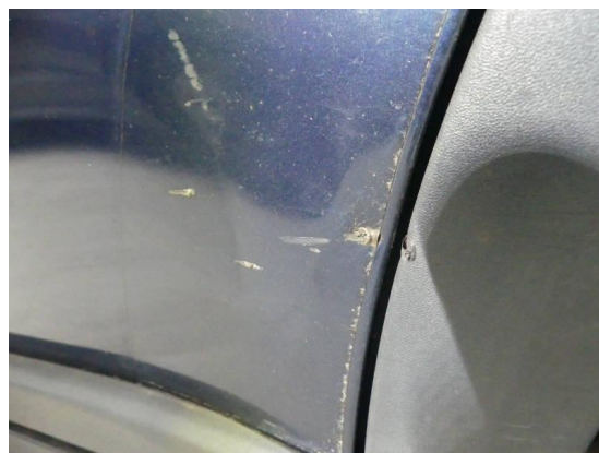
Bild 20: Karosserie / Tür hinten links Kratzer+leicht deformiert
