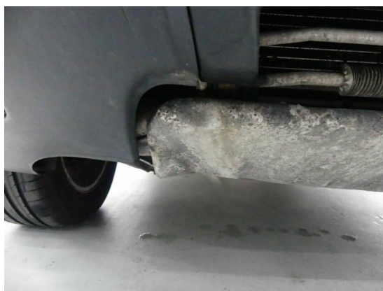
Bild 6: Karosserie / Unterbodenschutz deformiert
