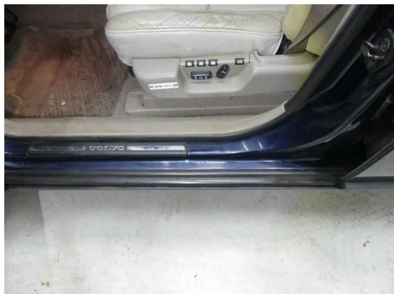
Bild 49: Karosserie / Einstieg vorne links Kratzer+Dellen
