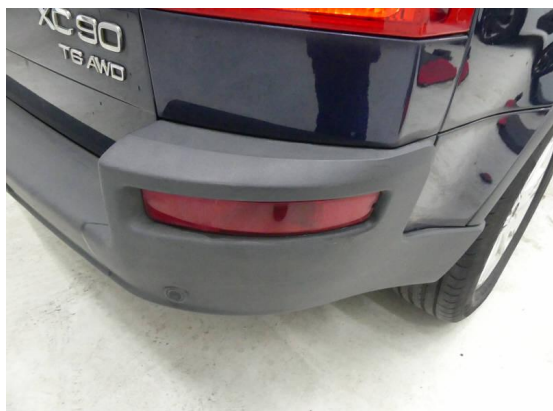
Bild 85: Karosserie / Stoßfänger hinten Kratzer
