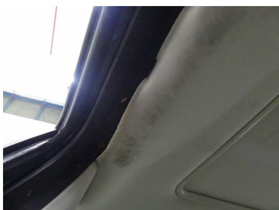
Bild 11: Innenraum / A-Säulenverkleidung eingerissen
