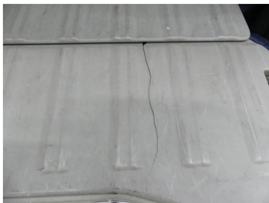
Bild 79: Innenraum / Heckklappenverkleidung gebrochen
