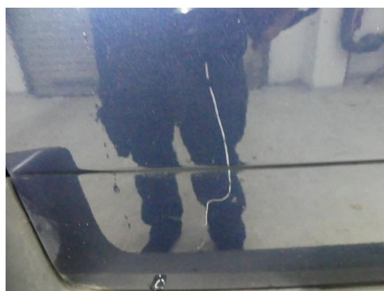
Bild 82: Karosserie / Heckklappe Kratzer
