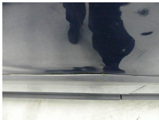
Bild 26: Karosserie / Tür vorne links deformiert
