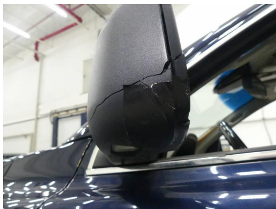
Bild 14: Karosserie / Außenspiegel links gebrochen
