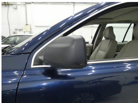
Bild 13: Karosserie / Außenspiegel links gebrochen
