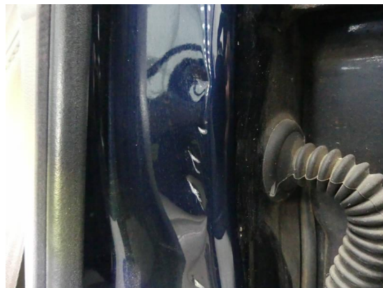
Bild 50: Karosserie / Einstieg vorne links Kratzer+Dellen
