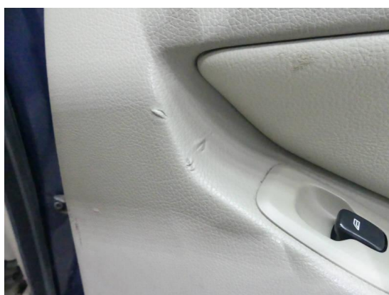
Bild 40: Innenraum / Türverkleidung hinten rechts beschädigt
