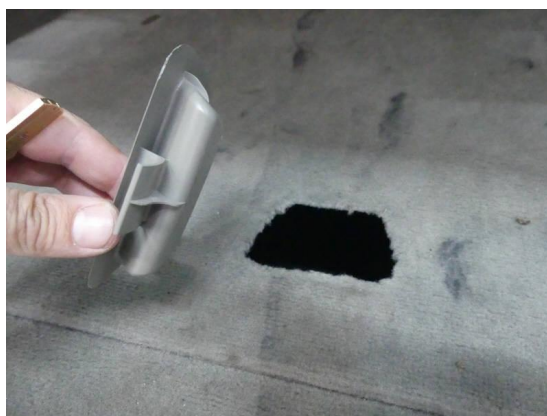
Bild 4: Innenraum / Kofferraumverkleidung gebrochen+kratzer
