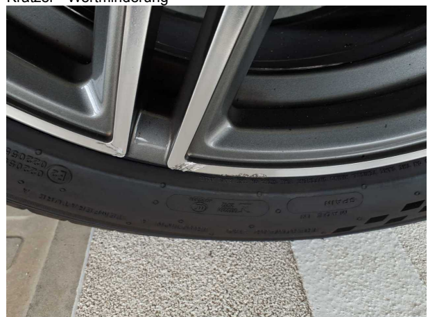
Beschädigung #10: Rad/Reifen: Leichtmetallfelge vorn rechts - Kratzer - Wertminderung
