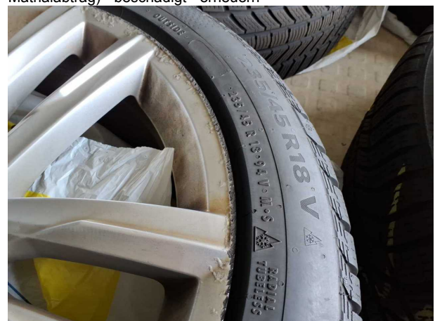
Beschädigung #6: 2.Radsatz: 2 Leichtmetallfelgen (Mit Materialabtrag) - beschädigt - erneuern
