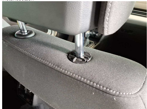
Beschädigung #25: Sitz vorn: Kopfstütze Sitz rechts (Abdeckung) - gebrochen / gerissen - erneuern
