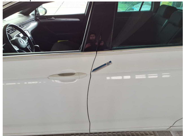
Beschädigung #19: Tür hinten links: Tür - Kratzer - Smart Repair
