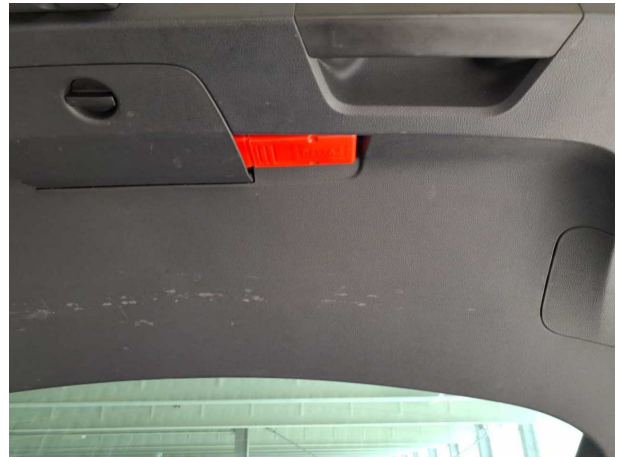
Beschädigung #1: Verkleidungen/Abdeckungen: Heckdeckel, Innenverkleidung - Kratzer
