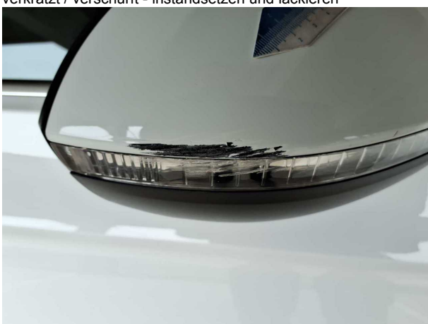
Beschädigung #13: Blinkleuchte: Spiegel rechts - verkratzt / verschürft - erneuern
