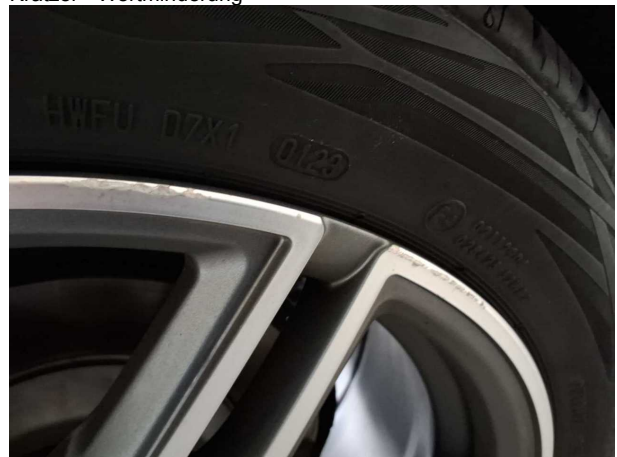
Beschädigung #8: Rad/Reifen: Leichtmetallfelge hinten links - Kratzer - Wertminderung
