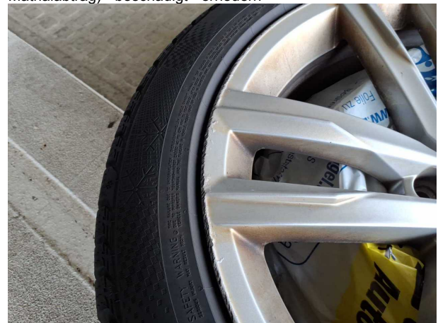
Beschädigung #6: 2.Radsatz: 2 Leichtmetallfelgen (Mit Materialabtrag) - beschädigt - erneuern
