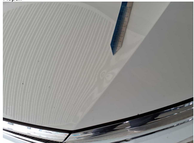
Beschädigung #23: Motorhaube: Motorhaube - Delle(n) - sanft instandsetzen
