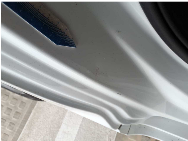
Beschädigung #15: Karosserie: C-Säule rechts - Delle / Lackschaden - Smart Repair
