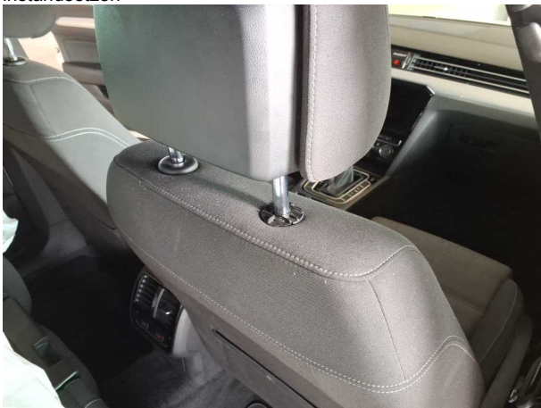
Beschädigung #25: Sitz vorn: Kopfstütze Sitz rechts (Abdeckun... gebrochen / gerissen - erneuern
