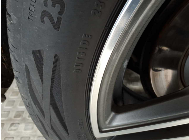
Beschädigung #9: Rad/Reifen: Leichtmetallfelge hinten rechts - Kratzer - Wertminderung
