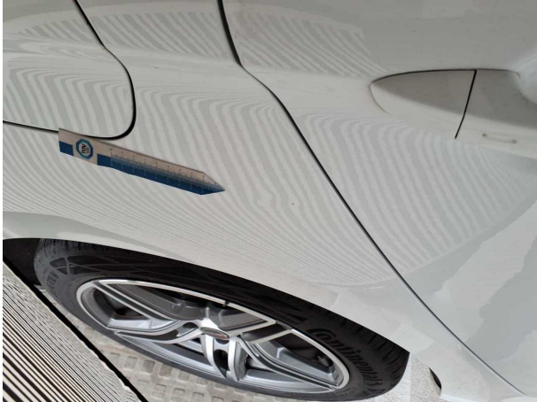
Beschädigung #16: Seitenwand rechts: Seitenwand - Delle / Lackschaden - instandsetzen und lackieren
