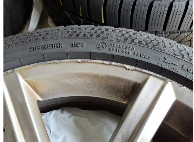
Beschädigung #6: 2.Radsatz: 2 Leichtmetallfelgen (Mit Materialabtrag) - beschädigt - erneuern
