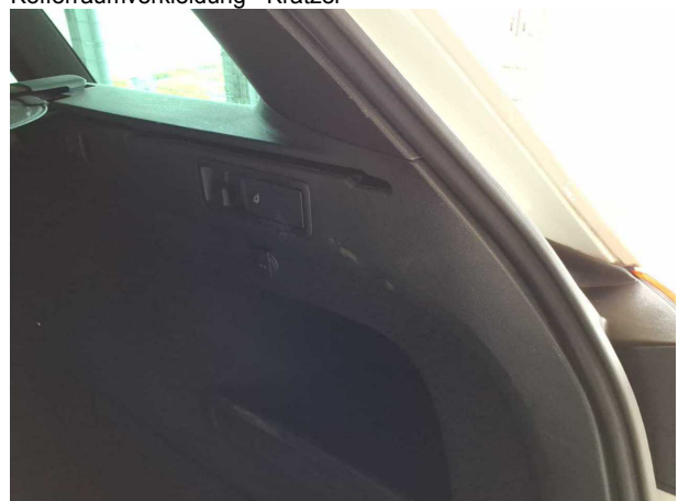
Beschädigung #2: Verkleidungen/Abdeckungen: Kofferraumverkleidung - Kratzer
