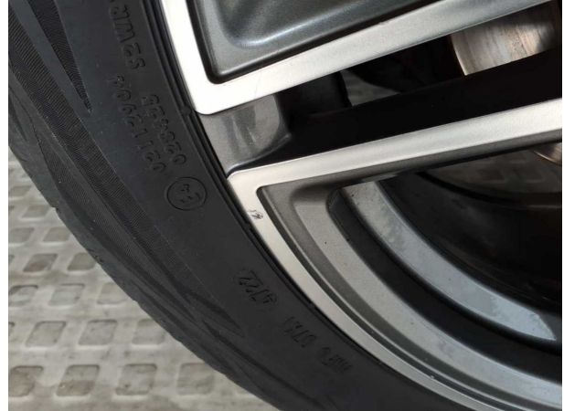
Beschädigung #9: Rad/Reifen: Leichtmetallfelge hinten rechts - Kratzer - Wertminderung
