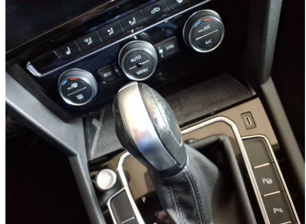
Beschädigung #21: Getriebe: Schaltknauf - verkratzt / verschürft - Smart Repair
