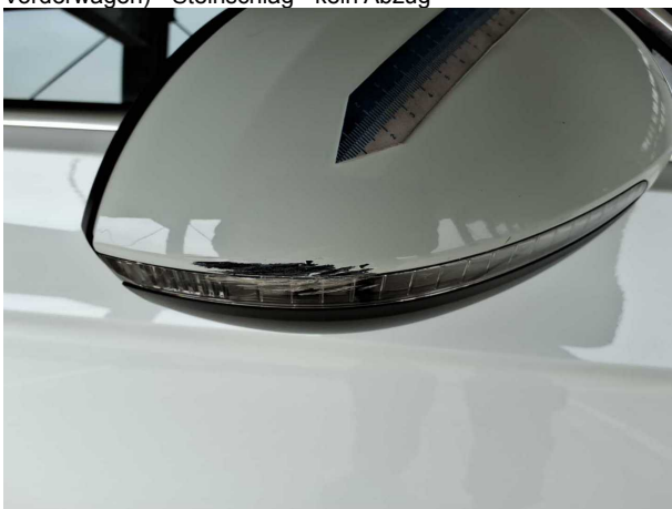
Beschädigung #12: Außenspiegel rechts: Abdeckkappe - verkratzt / verschürft - instandsetzen und lackieren
