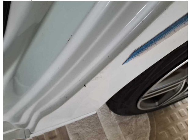
Beschädigung #18: Seitenwand links: Seitenwand - Kratzer - Smart Repair
