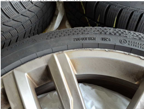
Beschädigung #6: 2.Radsatz: 2 Leichtmetallfelgen (Mit Materialabtrag) - beschädigt - erneuern
