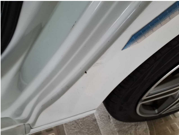
Beschädigung #18: Seitenwand links: Seitenwand - Kratzer - Smart Repair
