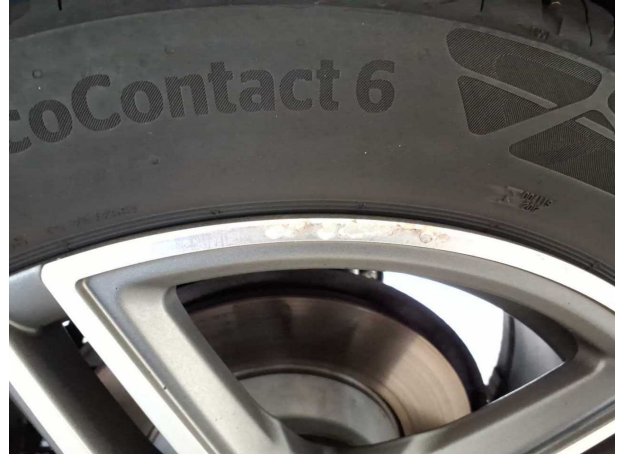
Beschädigung #8: Rad/Reifen: Leichtmetallfelge hinten links - Kratzer - Wertminderung
