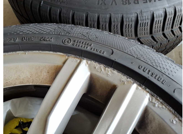
Beschädigung #6: 2.Radsatz: 2 Leichtmetallfelgen (Mit Materialabtrag) - beschädigt - erneuern
