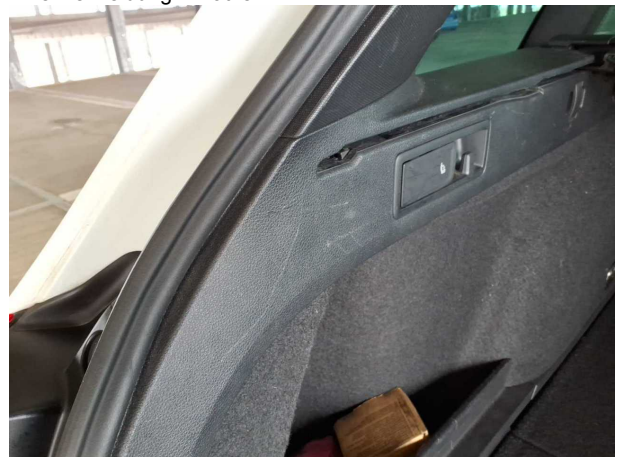
Beschädigung #2: Verkleidungen/Abdeckungen: Kofferraumverkleidung - Kratzer
