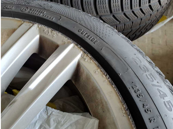
Beschädigung #6: 2.Radsatz: 2 Leichtmetallfelgen (Mit Materialabtrag) - beschädigt - erneuern
