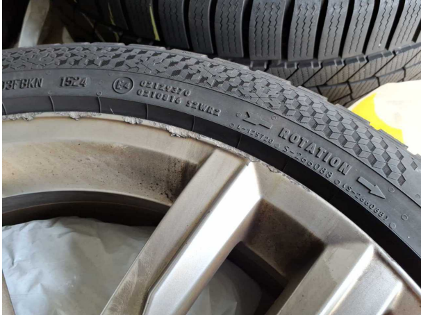
Beschädigung #6: 2.Radsatz: 2 Leichtmetallfelgen (Mit Materialabtrag) - beschädigt - erneuern
