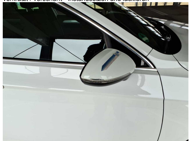
Beschädigung #13: Blinkleuchte: Spiegel rechts - verkratzt / verschürft - erneuern
