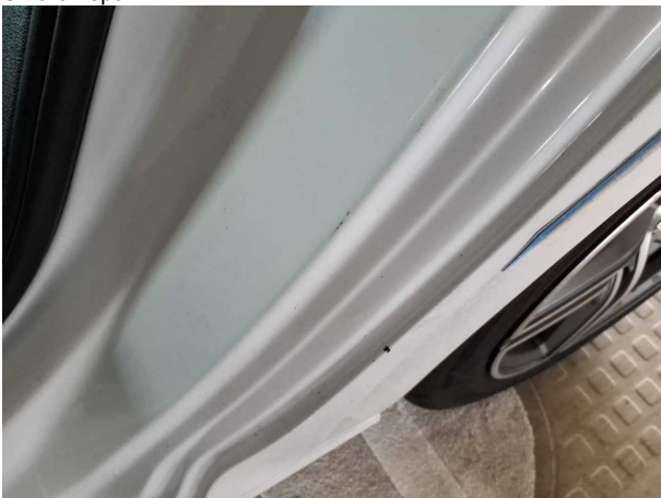
Beschädigung #18: Seitenwand links: Seitenwand - Kratzer - Smart Repair
