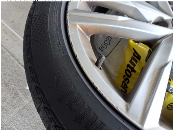
Beschädigung #6: 2.Radsatz: 2 Leichtmetallfelgen (Mit Materialabtrag) - beschädigt - erneuern
