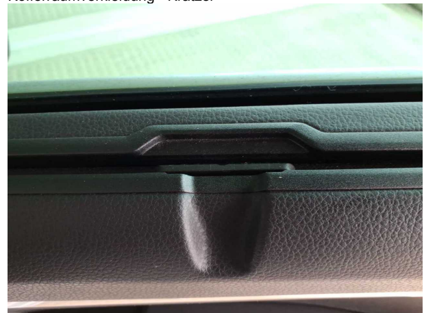
Beschädigung #3: Verkleidungen/Abdeckungen: Türverkleidung hinten rechts - gebrochen / gerissen - erneuern
