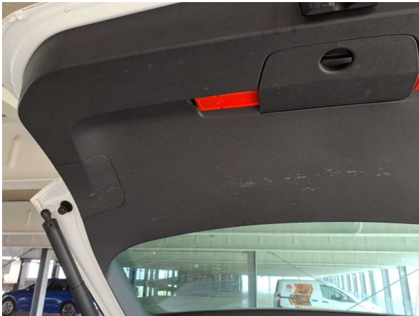
Beschädigung #1: Verkleidungen/Abdeckungen: Heckdeckel, Innenverkleidung - Kratzer
