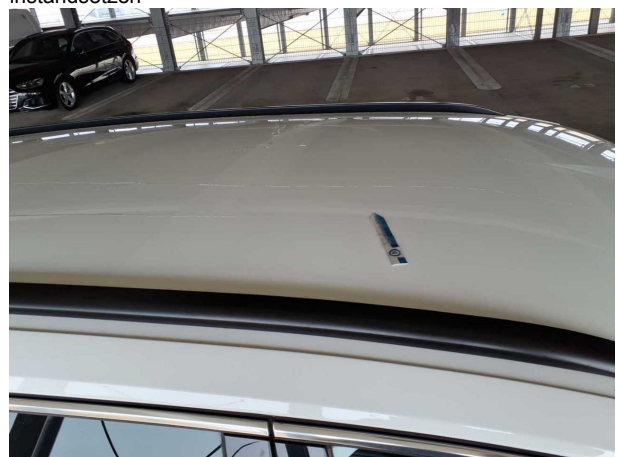
Beschädigung #24: Fahrzeugdach: Dach - Delle(n) - sanft instandsetzen
