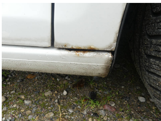
Bild 11: Karosserie / Schweller vorne rechts Korrosion und eingedrückt
