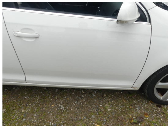
Bild 8: Karosserie / Tür vorne rechts Delle
