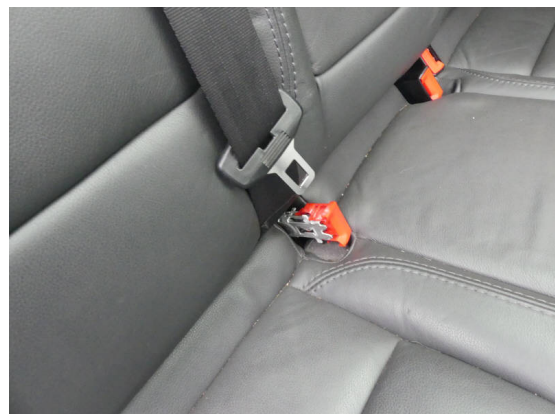
Bild 6: Innenraum / Gurtschloss hinten rechts Gehäuse fehlt
