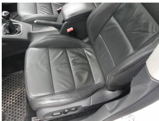
Bild 22: Innenraum / Fahrersitzbezug Leder verschlissen
