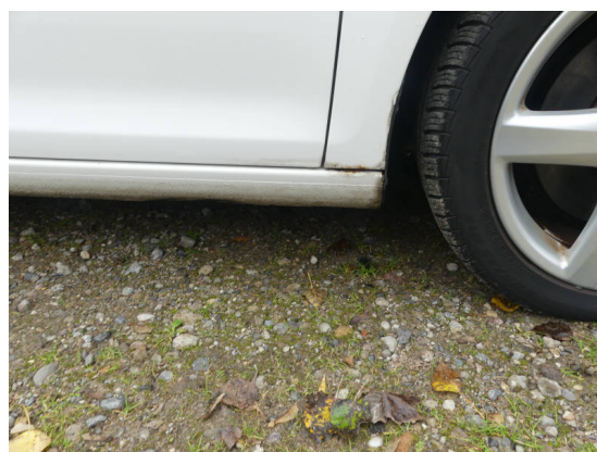
Bild 12: Karosserie / Schweller vorne rechts Korrosion und eingedrückt
