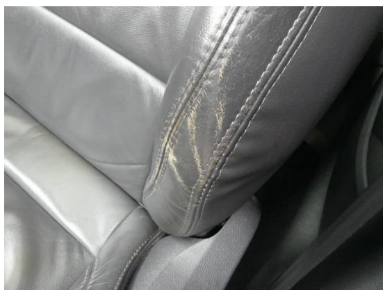
Bild 21: Innenraum / Fahrersitzbezug Leder verschlissen
