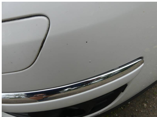
Bild 19: Karosserie / Stoßfänger vorn zerkratzt und Steinschläge
