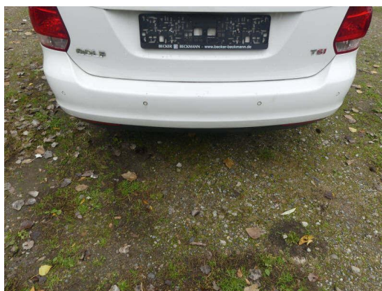
Bild 28: Karosserie / Stoßfänger hinten gestaucht und Lackablösung
