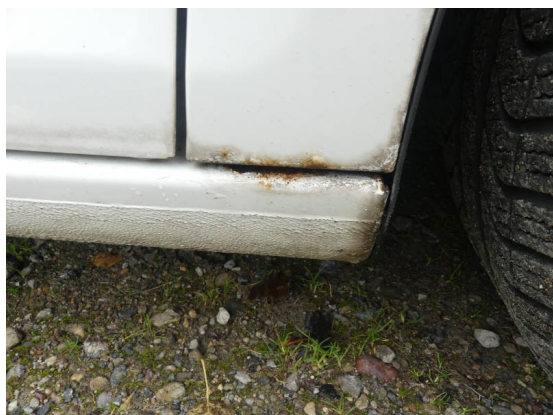
Bild 13: Karosserie / Kotflügel rechts Korrosion
