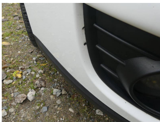
Bild 18: Karosserie / Stoßfänger vorn zerkratzt und Steinschläge
