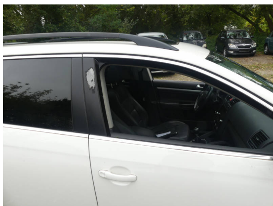
Bild 9: Karosserie / Folie am Fensterrahmen Tür vorne rechts teilweise abgerissen
