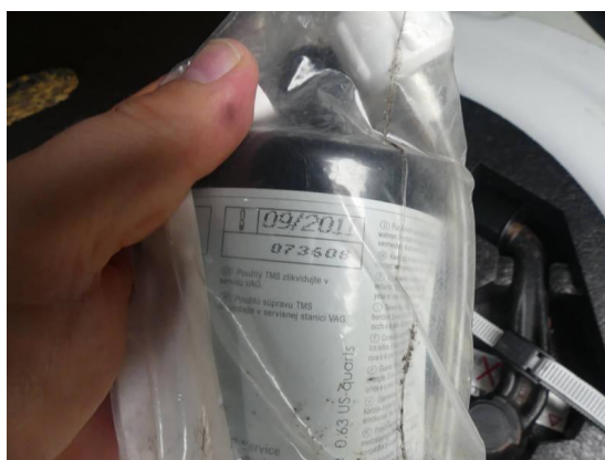
Bild 30: Reifen - Felge / Reifendichtmittel abgelaufen
