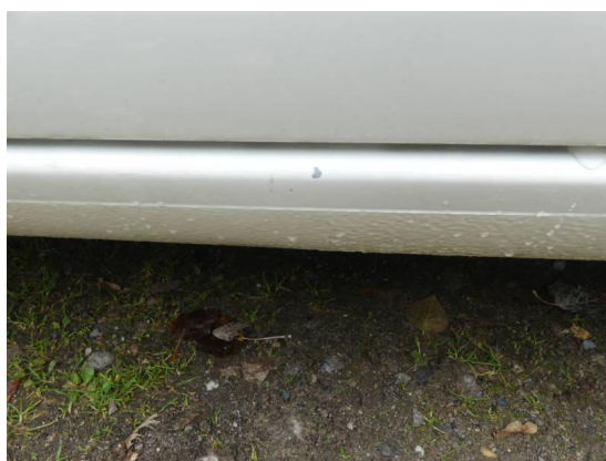
Bild 24: Karosserie / Schweller links Lackabplatzer
