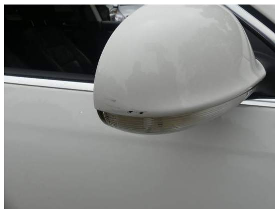
Bild 10: Karosserie / Spiegelkappe rechts Kratzer
