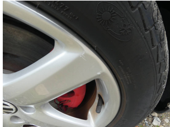
Bild 32: Reifen - Felge / Felge vorne rechts Kratzer
