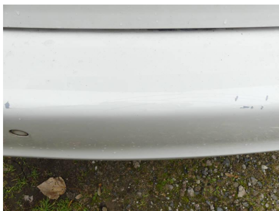
Bild 27: Karosserie / Stoßfänger hinten gestaucht und Lackablösung
