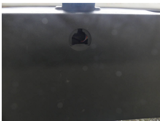
Bild 29: Innenraum / Abdeckung in Heckklappenverkleidung fehlt
