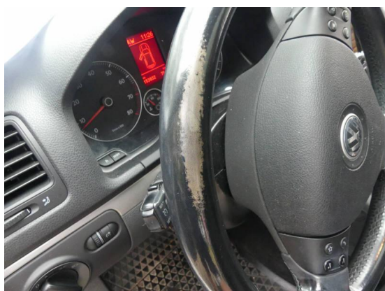
Bild 23: Innenraum / Lenkrad abgegriffen
