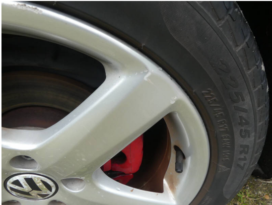
Bild 31: Reifen - Felge / Felge hinten rechts Kratzer
