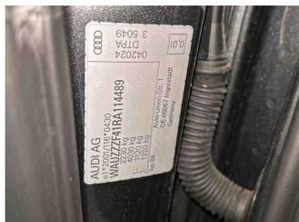
Fahrzeug - Typenschild/Fahrgestellnummer
